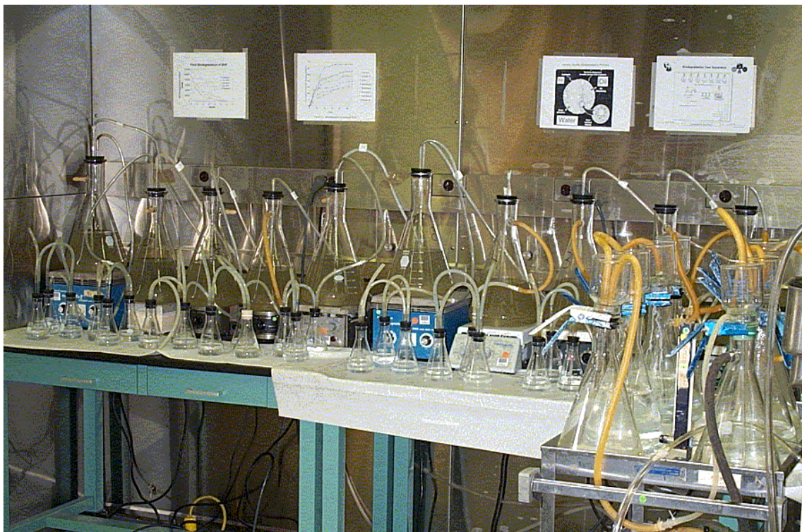
Slika 3. Prikaz uređaja za ASTM D 5864 metodu ispitivanja biorazgradivosti [23]
