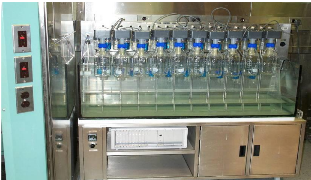
Slika 4. Prikaz uređaja za ASTM D 6731 metodu ispitivanja biorazgradivosti (respirometar) [23]
