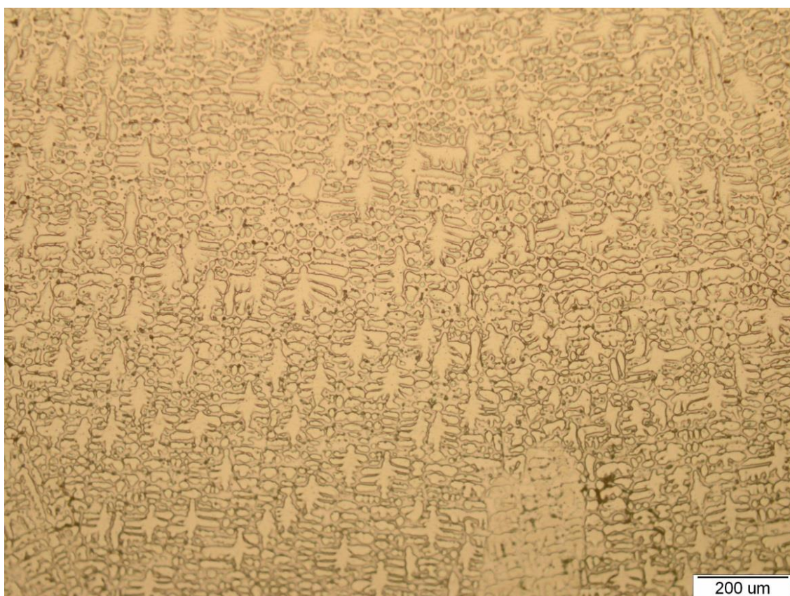
Slika 29. Mikrostruktura korijena zavarenog spoja uzorka H3-3
