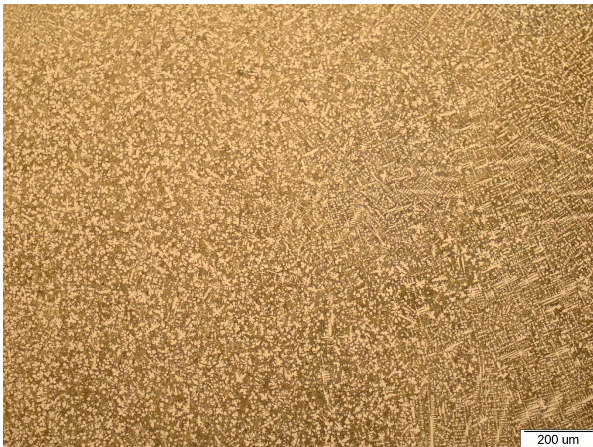
Slika 36. Mikrostruktura vrha zavarenog spoja uzorka T4-2
