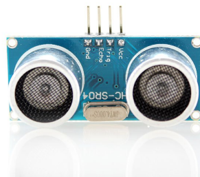
Slika 31: Ultrazvučni senzor udaljenosti
