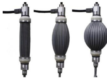
Slika 15: McKibbenov pneumatski mišić [9]
