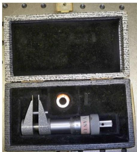
Slika 40. Mikrometar za male prvrte
