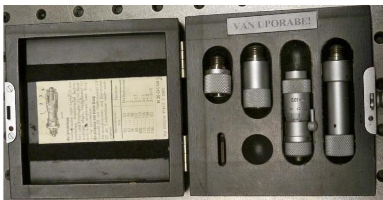
Slika 41. Štapni mikrometar
