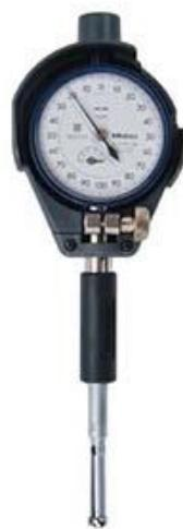
Slika 17. Subito za mjerjenje vrlo malih provrta
