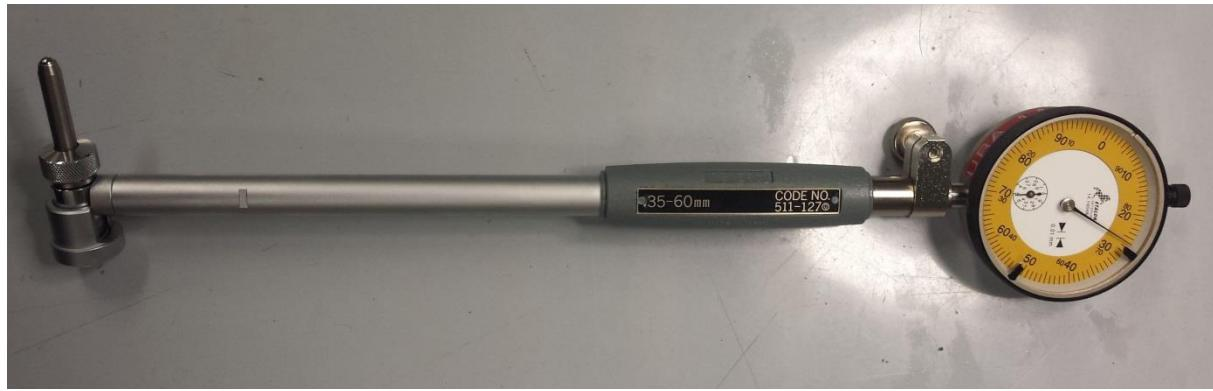
Slika 48. Subito korišten za mjerjenje kontrolnog prstena promjera  $\varnothing 50 \text{ mm}$
