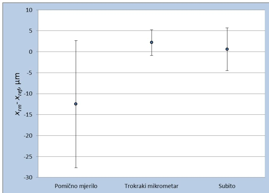
Slika 56. Grafički prikaz rezultata mjerenja kontrolnog prstena promjera  $\varnothing 60 \text{ mm}$
