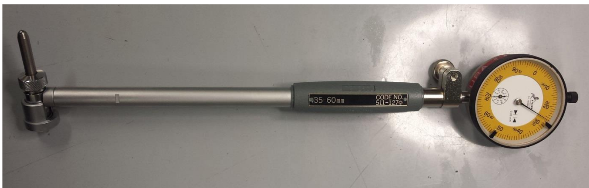
Slika 48. Subito korišten za mjerenje kontrolnog prstena promjera \varnothing 50 mm
