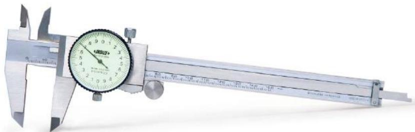
Slika 3. Pomično mjerilo s mjernom urom
