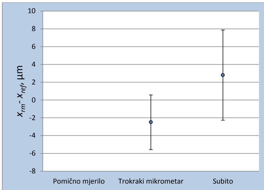
Slika 52. Grafički prikaz rezultata mjerena kontrolnog prstena promjera  $\varnothing 18 \text{ mm}$  bez mjerena pomičnog mjerila
