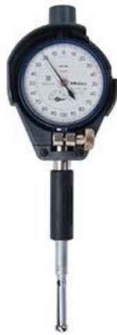
Slika 17. Subito za mjerenje vrlo malih provrta
