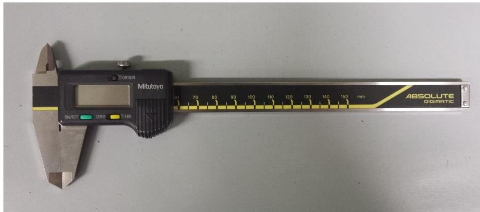
Slika 45. Digitalno pomično mjerilo tvrtke Mitutoyo
