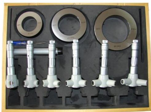
Slika 12. Set trokrakih mikrometara sa pripadajućim komponentama
