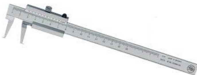
Slika 2. Pomično mjerilo za mjerjenje unutarnjih promjera
