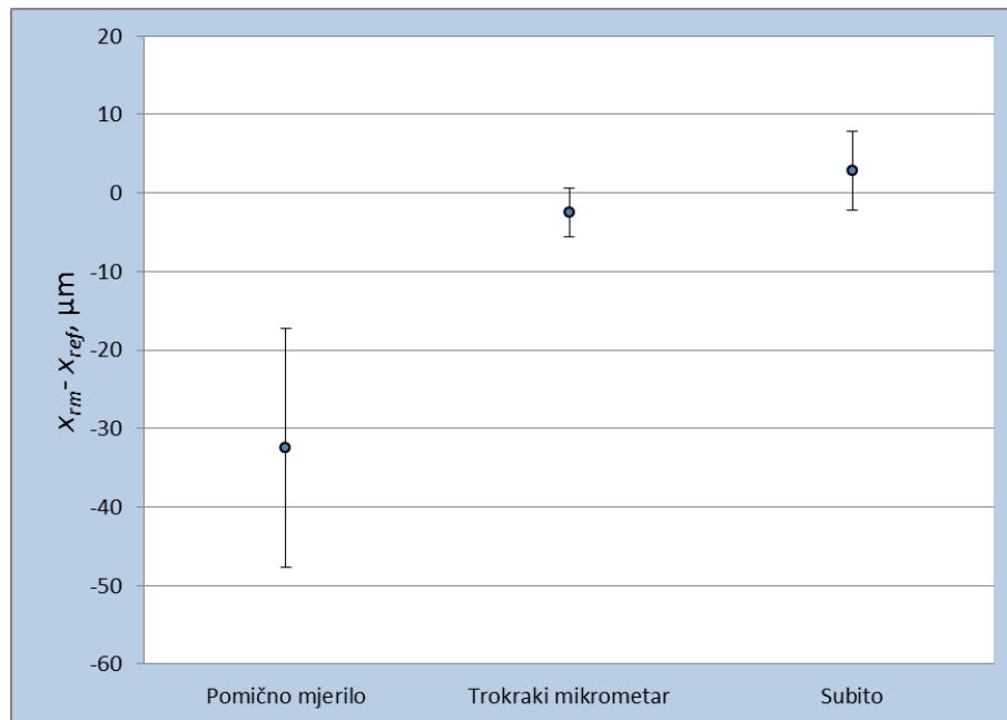
Slika 51. Grafički prikaz rezultata mjerjenja kontrolnog prstena promjera  $\varnothing 18 \text{ mm}$
