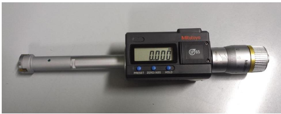
Slika 46. Digitalni trokraki mikrometar tvrtke Mitutoyo
