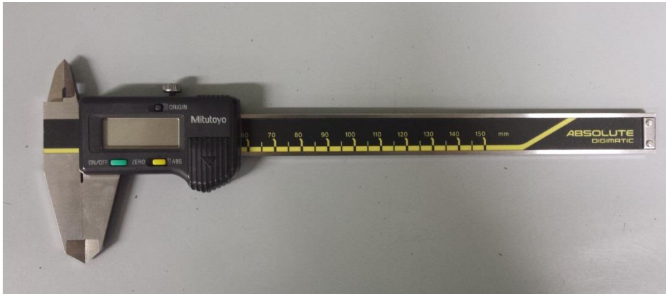
Slika 45. Digitalno pomično mjerilo tvrtke Mitutoyo
