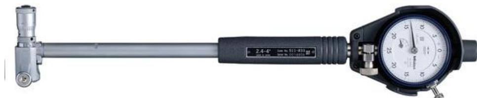
Slika 20. Subito sa mikrometarskom glavom
