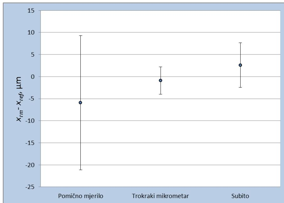
Slika 55. Grafički prikaz rezultata mjerjenja kontrolnog prstena promjera  $\varnothing 50$  mm
