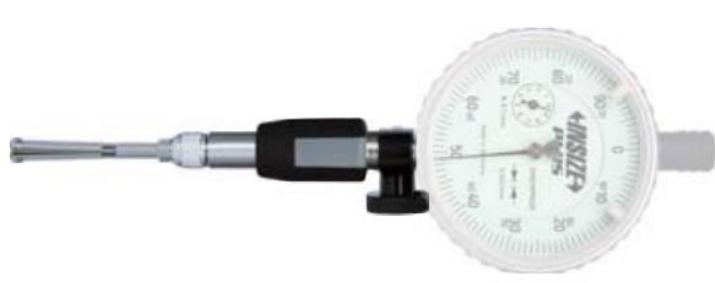
Slika 37. Mjerilo za male promjere s iglom
