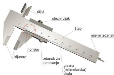
Slika 1. Klasično pomično mjerilo sa sastavnim dijelovima
