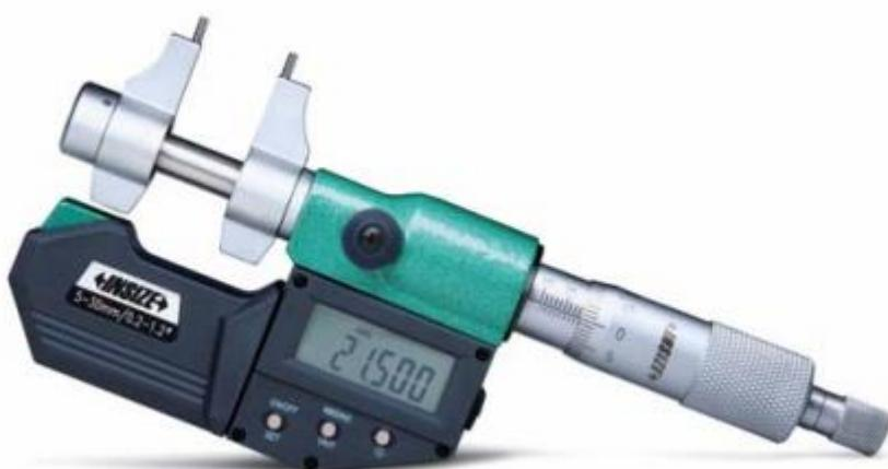
Slika 8. Digitalni mikrometar
