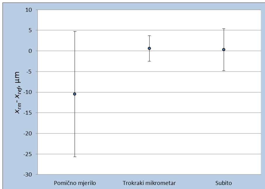
Slika 57. Grafički prikaz rezultata mjerena kontrolnog prstena promjera  $\varnothing 100 \text{ mm}$
