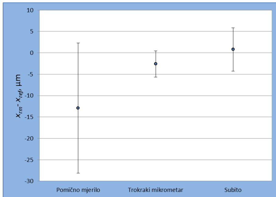
Slika 53. Grafički prikaz rezultata mjerenja kontrolnog prstena promjera ø19 mm
