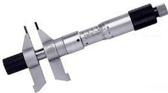
Slika 7. Mikrometar sa dvostranim čeljustima
