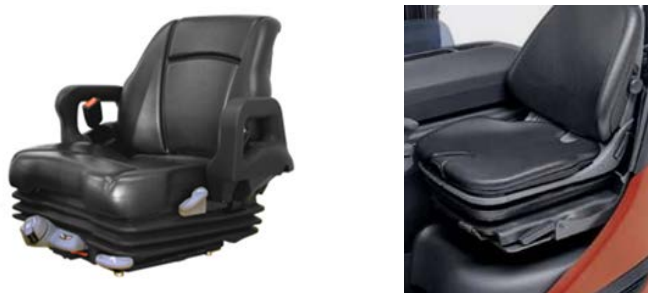
Slika 24. Prikaz automatski podesivog sjedala (lijevo[30]) i sjedala sa zračnim jastucima (desno[31])
