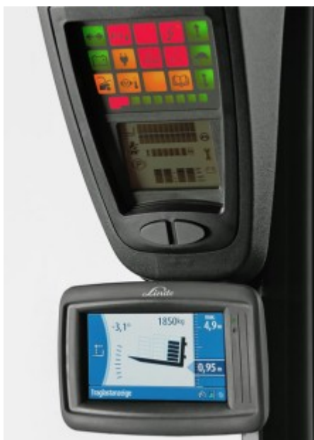
Slika 32. Prikaz Linde Safety Pilot sustava [44]
