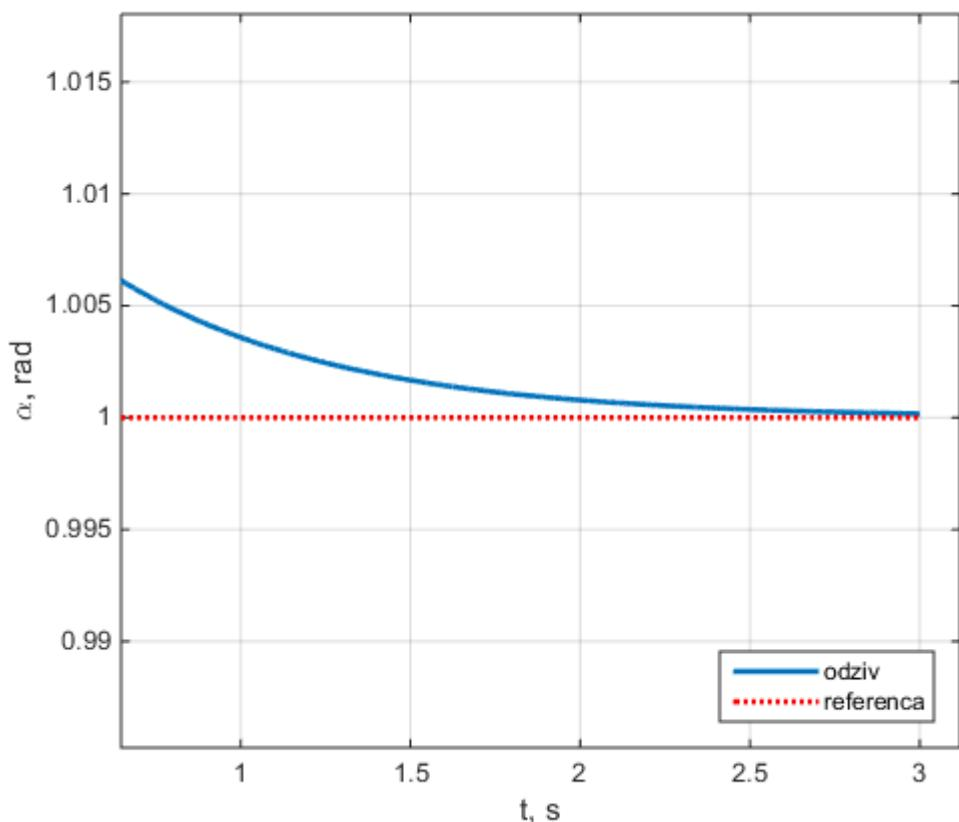
Slika 3.6 Eliminacija trajne regulacijske pogreške PID regulatorom
