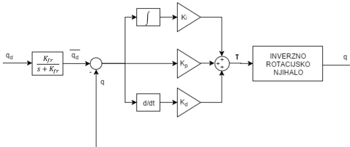
**Slika 3.8 Blok shema sustava s predfiltrom referentne pozicije**
