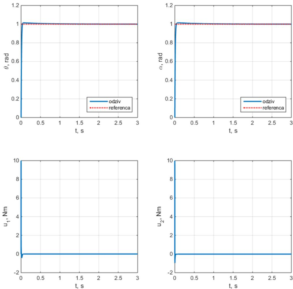
Slika 3.5 Odziv sustava reguliranog PID regulatorom
