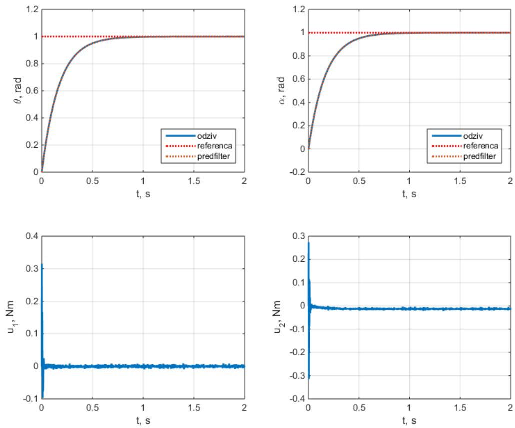
Slika 3.13 Odziv PID regulatora uz šum mjerena, uz filter brzine
