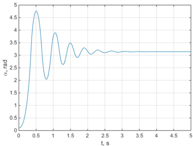
Slika 2.3 Odziv nelinearnog sustava u otvorenoj petlji
