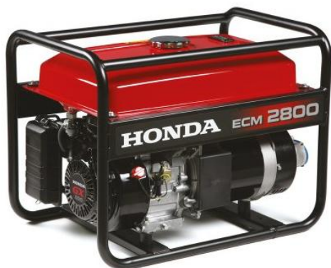
Slika 6.13. Odabrani agregat Honda ECM 2800 i njegove karakteristike
