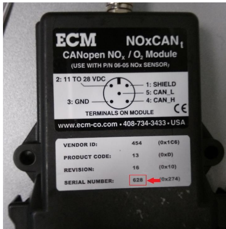
Slika 4.7. Serijski broj upravljačkog modula NOxCAN.
