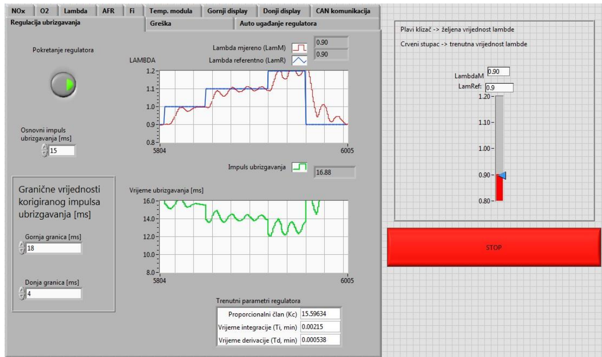
Slika 6.16. Prikaz odziva sustava u front panelu nakon automatskog ugađanja parametara.
