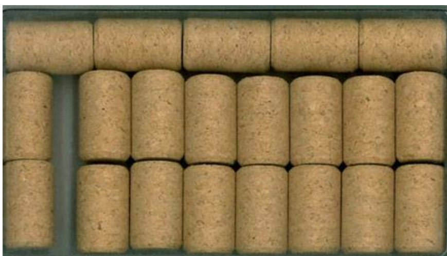
Slika 17. Čepovi od anglomeriranog pluta
