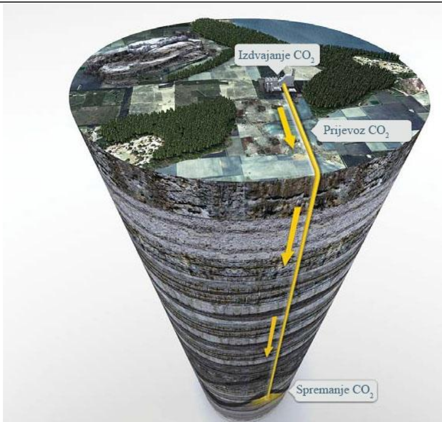
Slika 9. Shematski prikaz CCS tehnologije [4]
