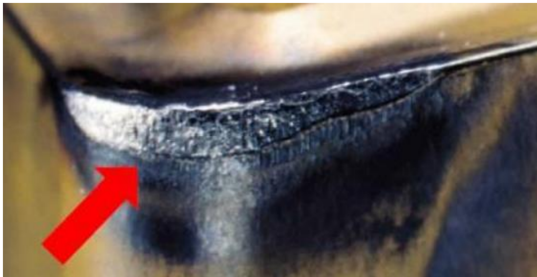
Slika 8. Trošenje stražnje površine alata [2]
