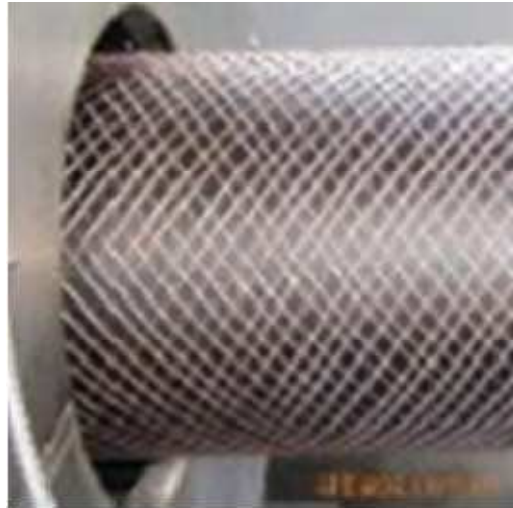
Slika 2.13. Žicom ojačana cijev [4]
