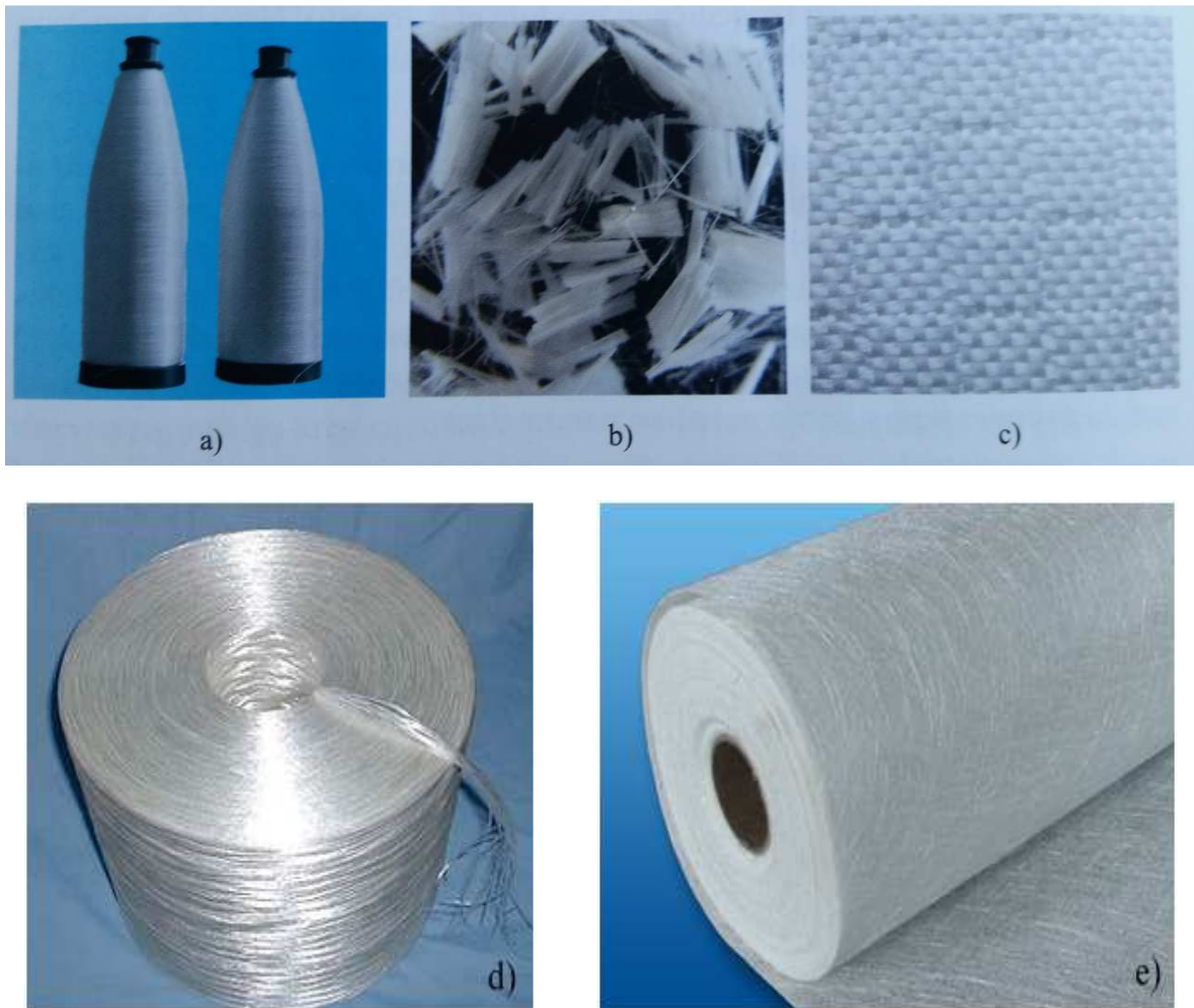
Slika 2.17. Polazni oblici vlakana: a) svitak niti; b) kratka sjeckana vlakna; c) tkanina; d) roving; e) mat [3, 8, 9]
