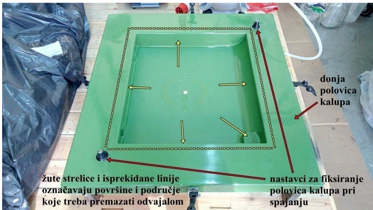
Slika 4.8. Donja polovica kalupa: mjesta i površine premazane odvjalom
