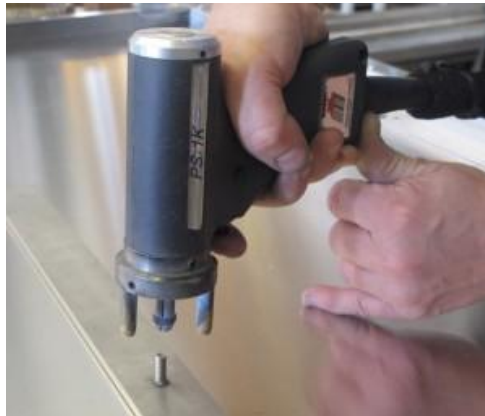
Slika 25. Pištolj za elektrolučno zavarivanje pritiskom
