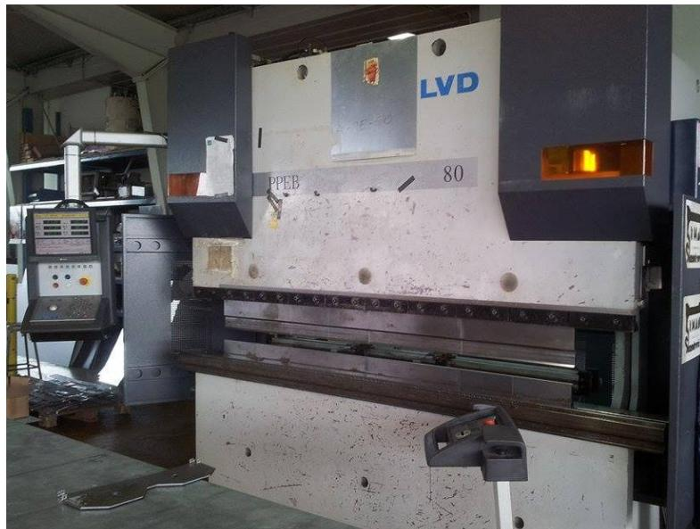
**Slika 21. Stroj za kutno savijanje**
