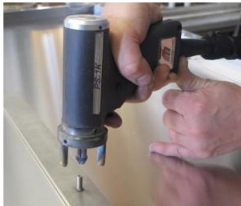
**Slika 25. Pištolj za elektrolučno zavarivanje pritiskom**
