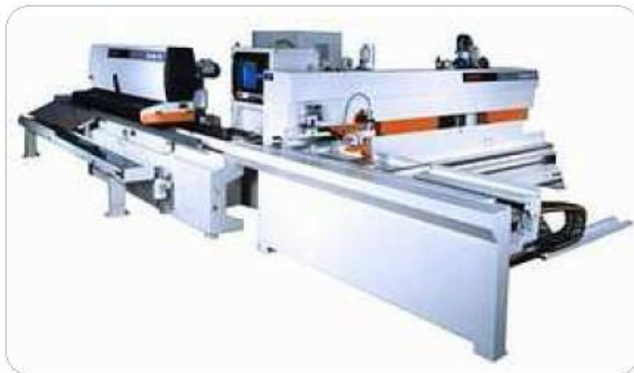
Slika 12. CNC stroj za proizvodnju okvirnica prozora i vrata [8]
