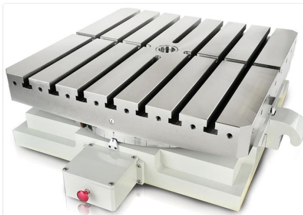
Slika 35. Primjer aluminijske radne ploče [20]
