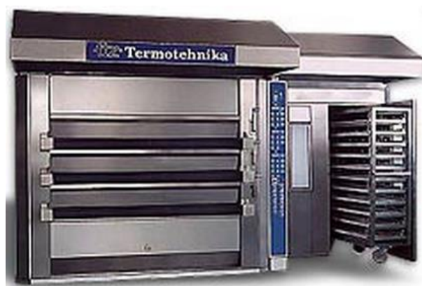
Slika 8 Peć i komora za završnu fermentaciju [5]
