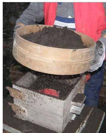
Slika 23. Prosijavanje prvog sloja mješavine iznad donjeg dijela kalupa
