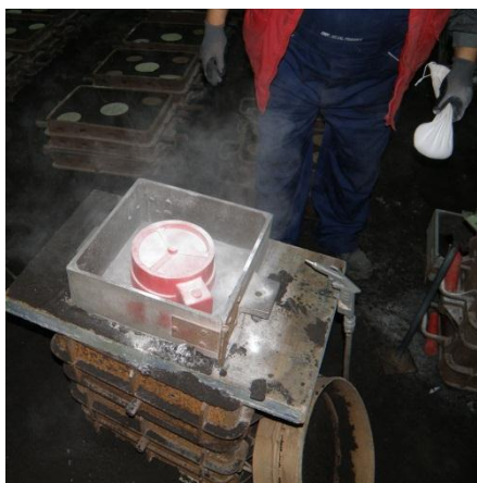
Slika 16. Stavljanje gornjeg dijela modela u gornji dio kalupa
