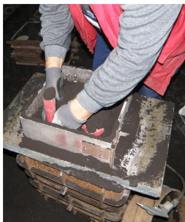
Slika 18. Ručno utiskivanje prvog sloja mješavine
