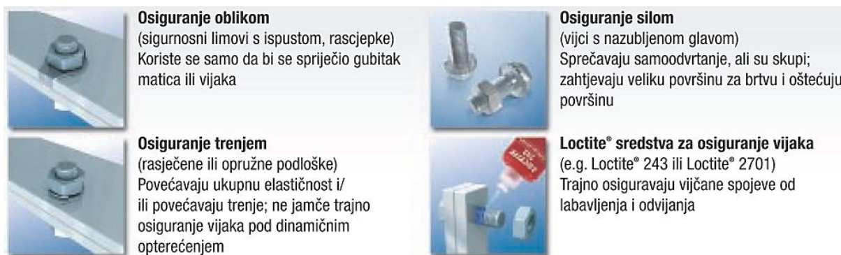
Slika 67. Prikaz metoda osiguranja vijaka
