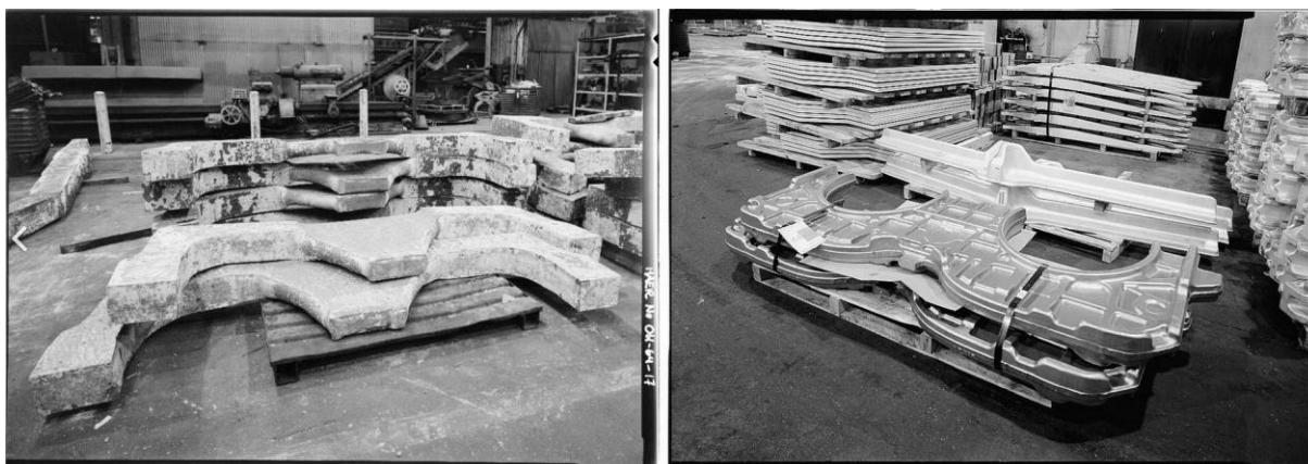
Slika 11. Pregrade od titana za F-15 mlazni lovac napravljene s Alcoa HP [Slika 7] prije (lijevo) i nakon kovanja (desno)
