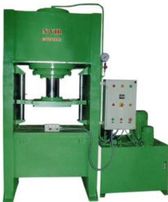
Slika 5. Hidraulična preša N. VIR sa srednjom pločom i dvije vodilice
