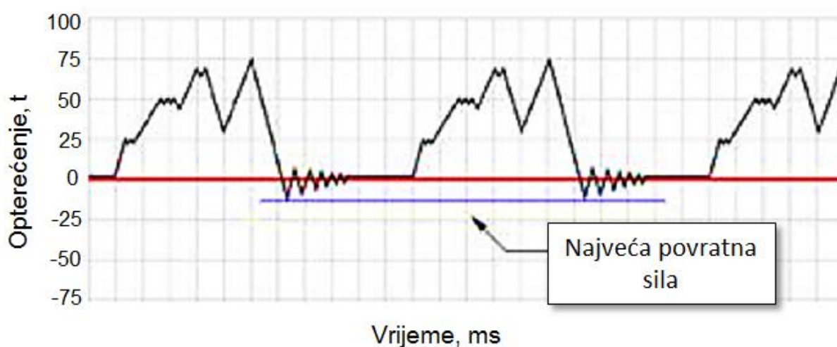
Slika 77. Prikaz praćenja opterećenja preše
