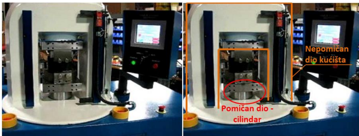
Slika 6. Mala hidraulična preša za kovanje kovanica
