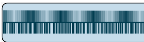
Slika 71. Prikaz skala apsolutnog enkodera [25]
