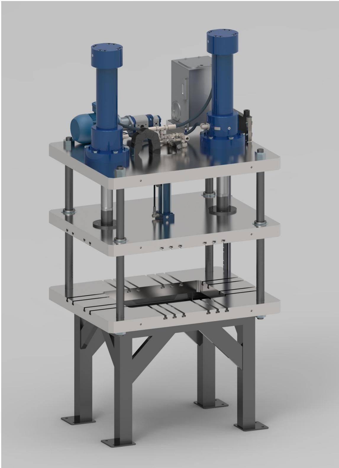
**Slika 84. Hidraulična preša za krzalice kapaciteta 50 t**
