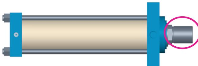
**Slika 19. Hidraulični cilindar**
