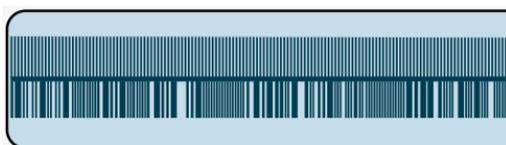
**Slika 71. Prikaz skala apsolutnog enkodera [25]**
