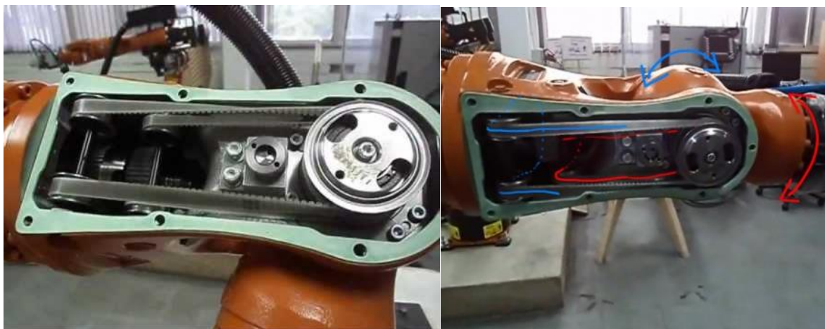
Slika 39. Primjer izvedbe pogona osi robota pomoću zupčastog remenja
