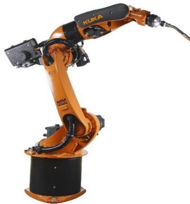
Slika 16. Robotska ruka Kuka KR 16 arc HW
