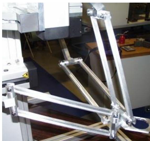
Slika 9. Prototip izvedbe Orthoglide stroja [3]
