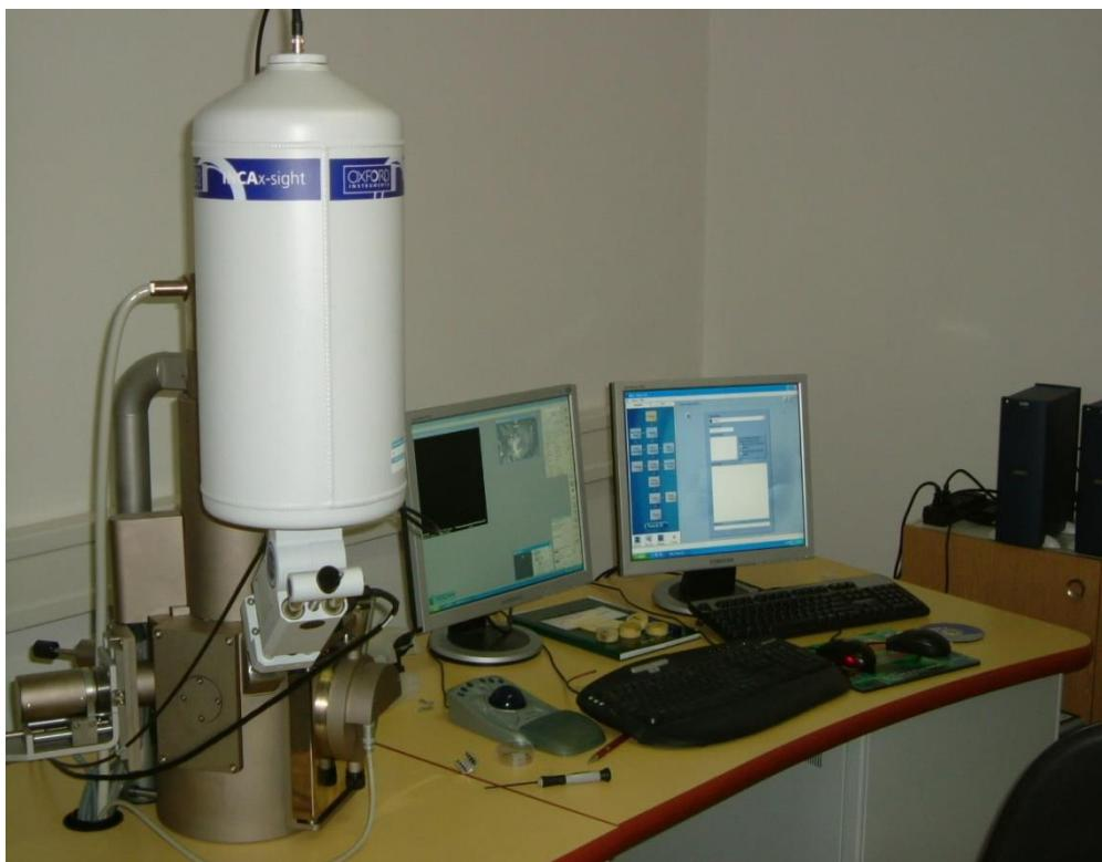
Slika 36. Elektronski mikroskop Tescan i EDX analizator
