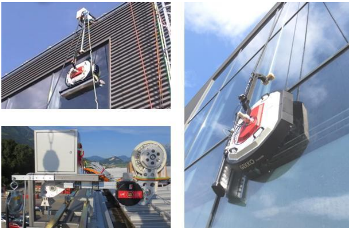
Slika 30. Serbot – robotski čistač Gekko
