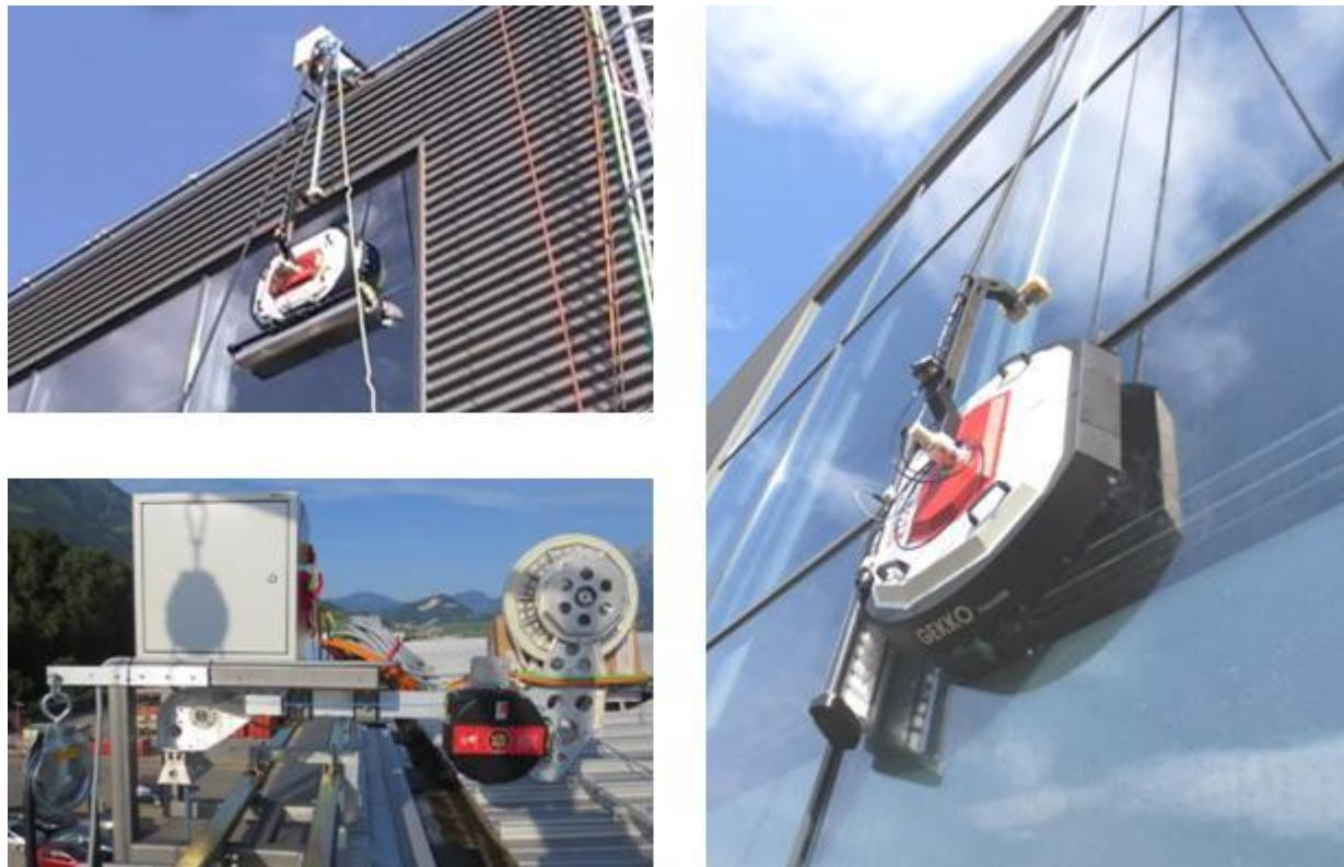
**Slika 30. Serbot – robotski čistač Gekko**
