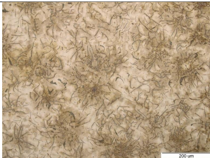
Slika 69. Metalografska snimka mikrostrukture sivog lijeva u nagrizenom stanju, 200x
