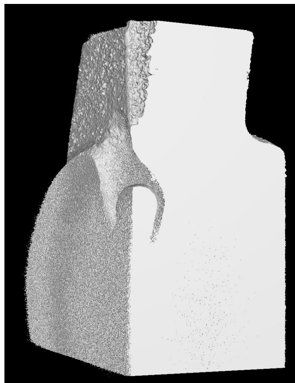
Slika 64. Usahlina u presjeku
