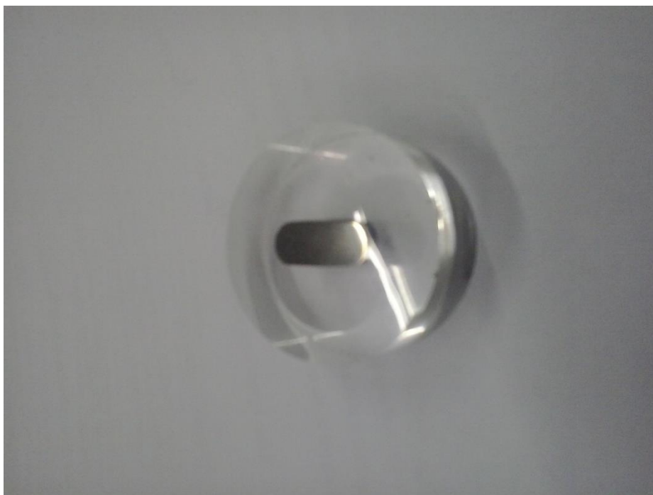
Slika 57. Uzorak zaliven u plastičnu masu
