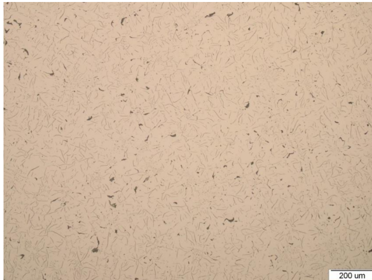
Slika 65. Metalografska snimka mikrostrukture sivog lijeva u nenagrizenom stanju, 100x
