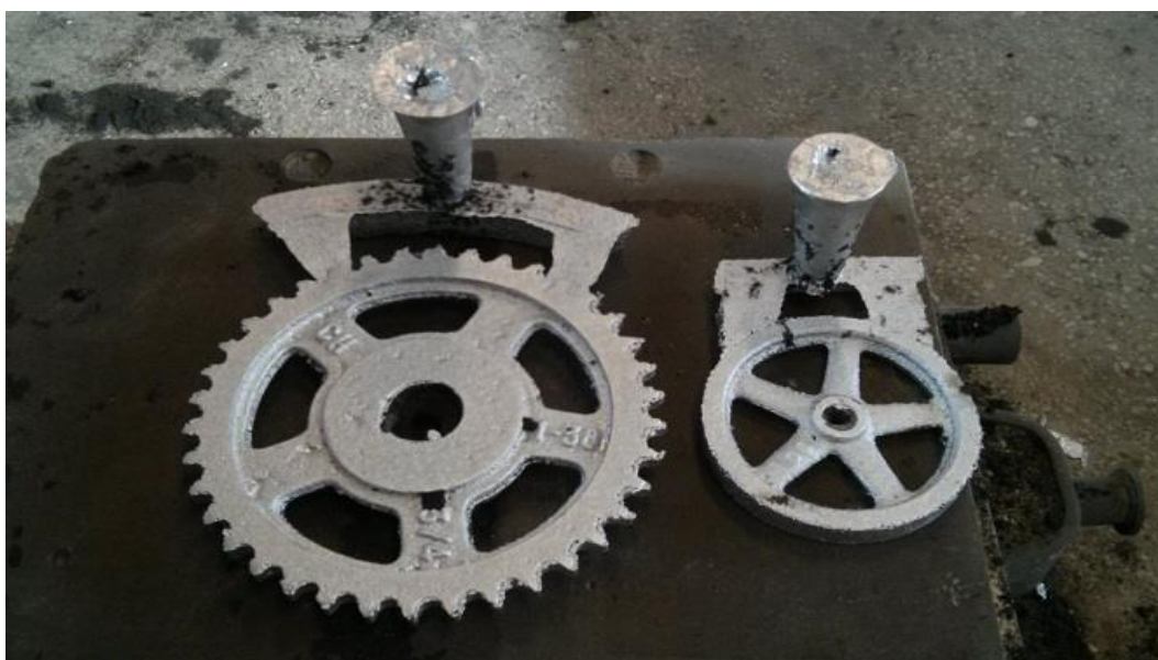
Slika 72. Prikaz odljevaka s uljevnim sustavom
