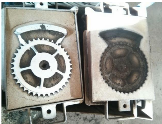
Slika 71. Otvaranje i rastresanje kalupa
