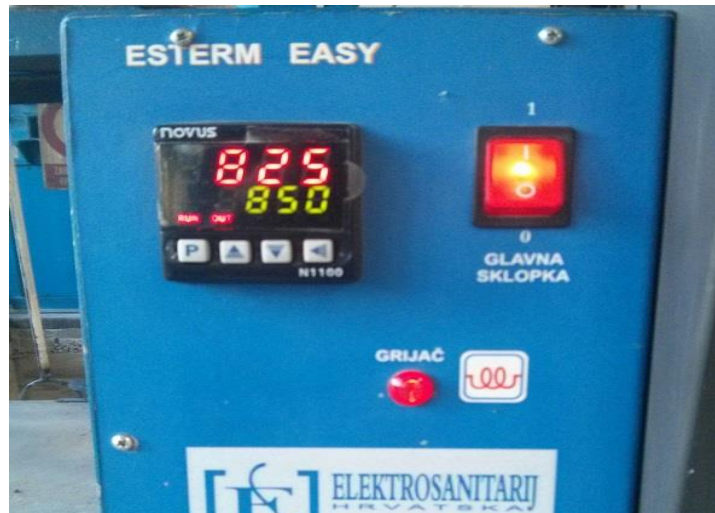
Slika 65. Namještanje temperature taljenja
