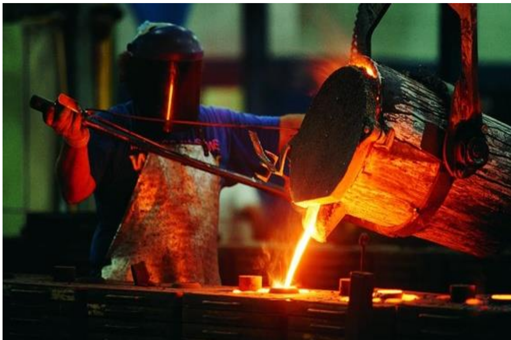
Slika 2. Prikaz procesa lijevanja metala [4]
