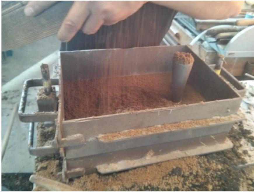
Slika 61. Pozicioniranje spusta u gornji dio kalupa
