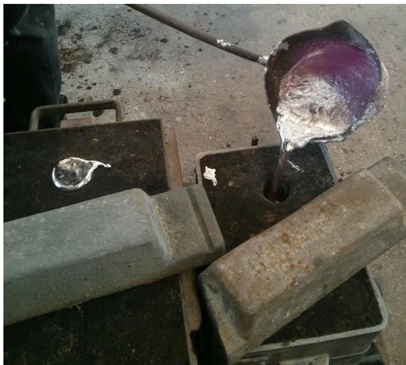
Slika 70. Ulijevanje taljevine u kalupe
