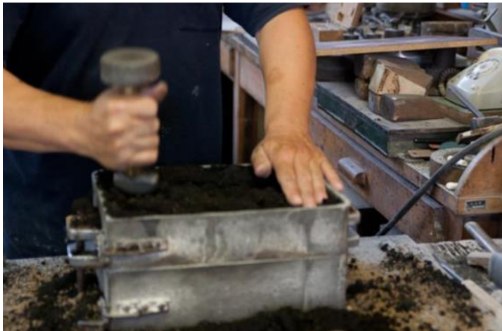
Slika 58. Sabijanje kalupne mješavine
