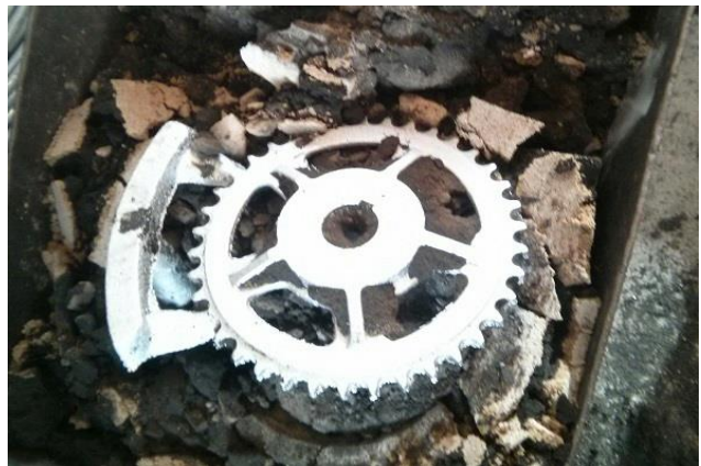
Slika 71. Otvaranje i rastresanje kalupa
