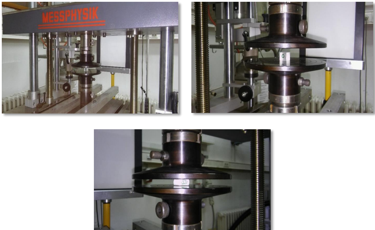
Slika 25. Uređaj za ispitivanje čvrstoće s neopterećenim uzorkom (gore) i opterećenim uzorkom (dolje)
