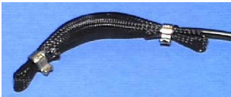
Slika 7: McKibben-ov pneumatski mišić
