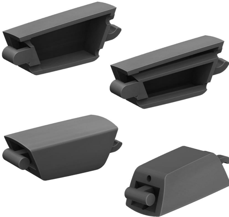
Slika 28 Kanali za tetivu i elastičnu nit
