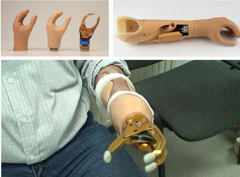
Slika 5 Jednostavna mioelektrična proteza podlaktice [10], [11], [12]
