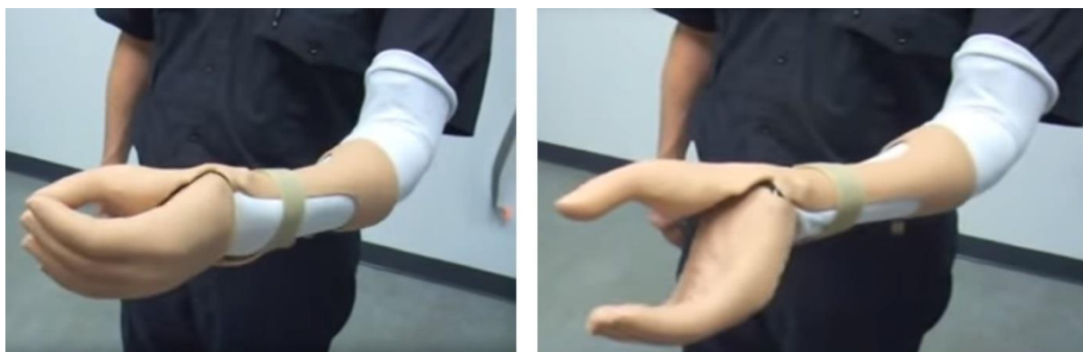
Slika 4 Mehanička proteza za bataljak šake [9]
