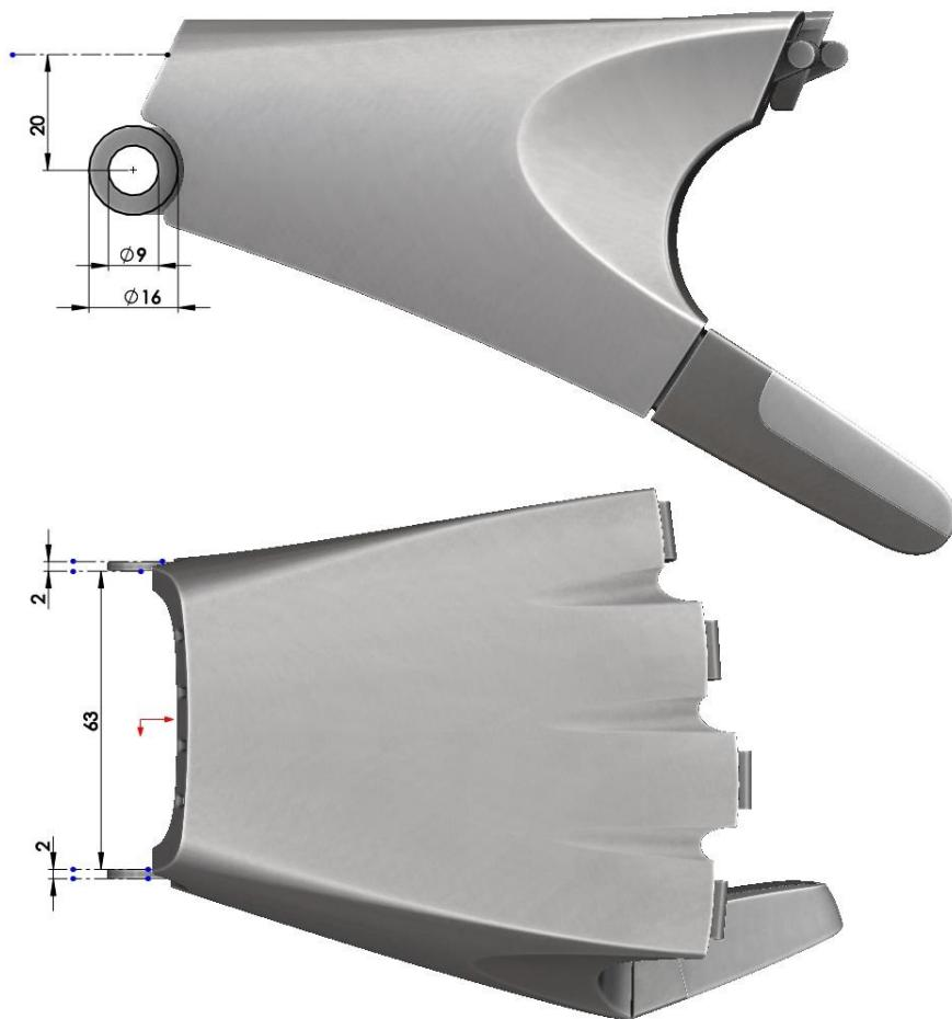
**Slika 54 Dio ručnog zgloba na srednjem dijelu proteze**
