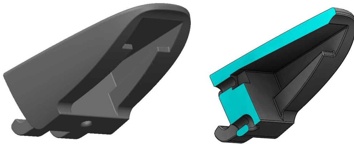
**Slika 33 Poprečni presjek prsta**
