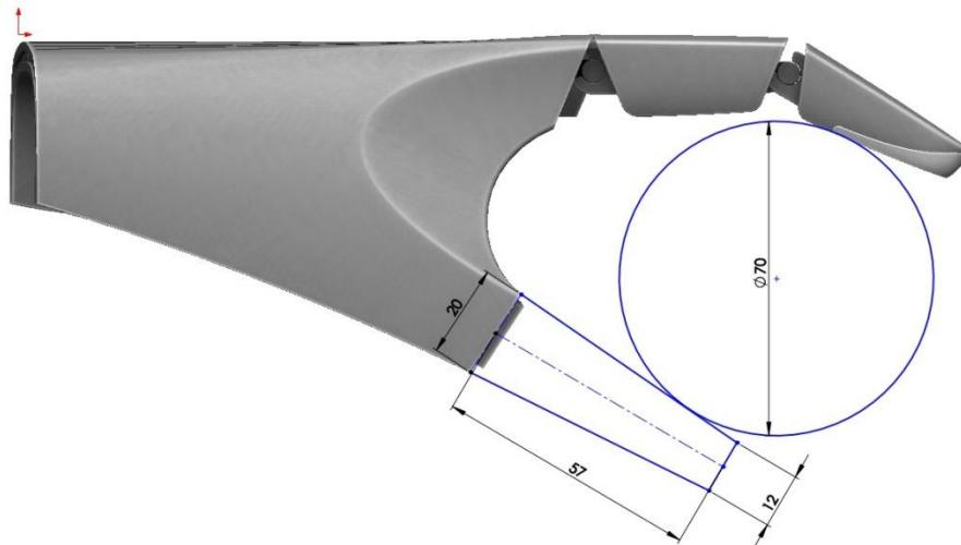
**Slika 50 Prihvata cilindra promjera 70 mm**
