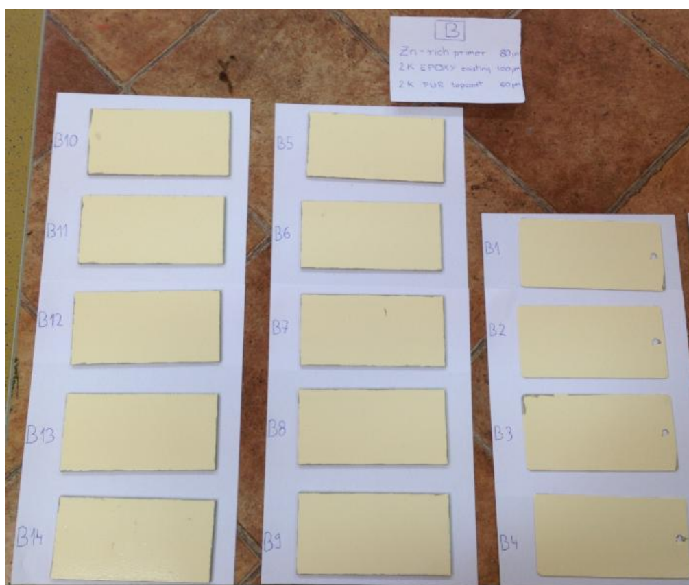
Slika 25. Uzorci sustava premaza B, na bazi otapala
