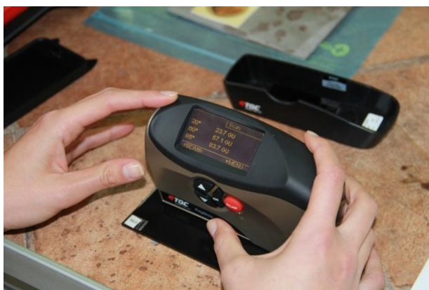
Slika 28. Uređaj za određivanje kategorije sjaja površina sustava premaza
