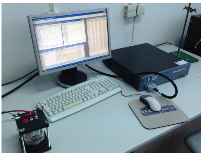
Slika 42. Uređaj za elektrokemijsku impedancijsku spektroskopiju
