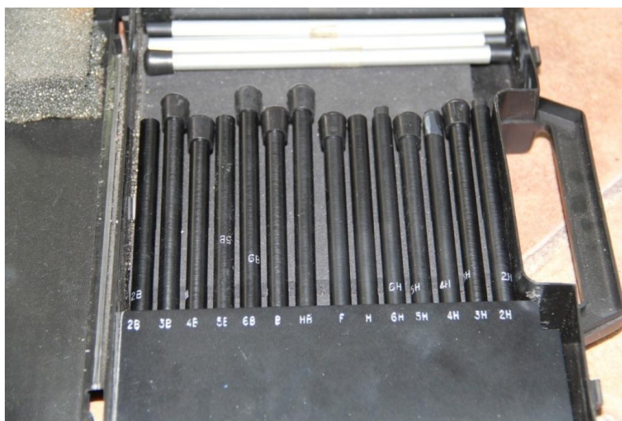
Slika 30. Olovke različitih tvrdoća za ispitivanje tvrdoće premaza
