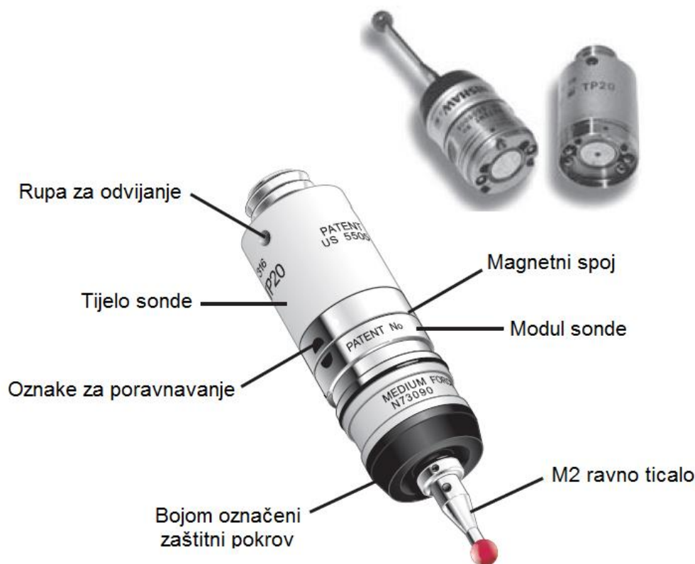
Slika 30. Dijelovi Renishaw TP20 mjerne sonde [5]
