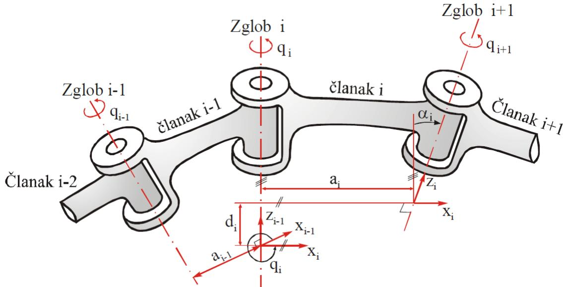
Slika 2.6: Denavit–Hartenbergovi parametri za rotacijski zglob [7]
