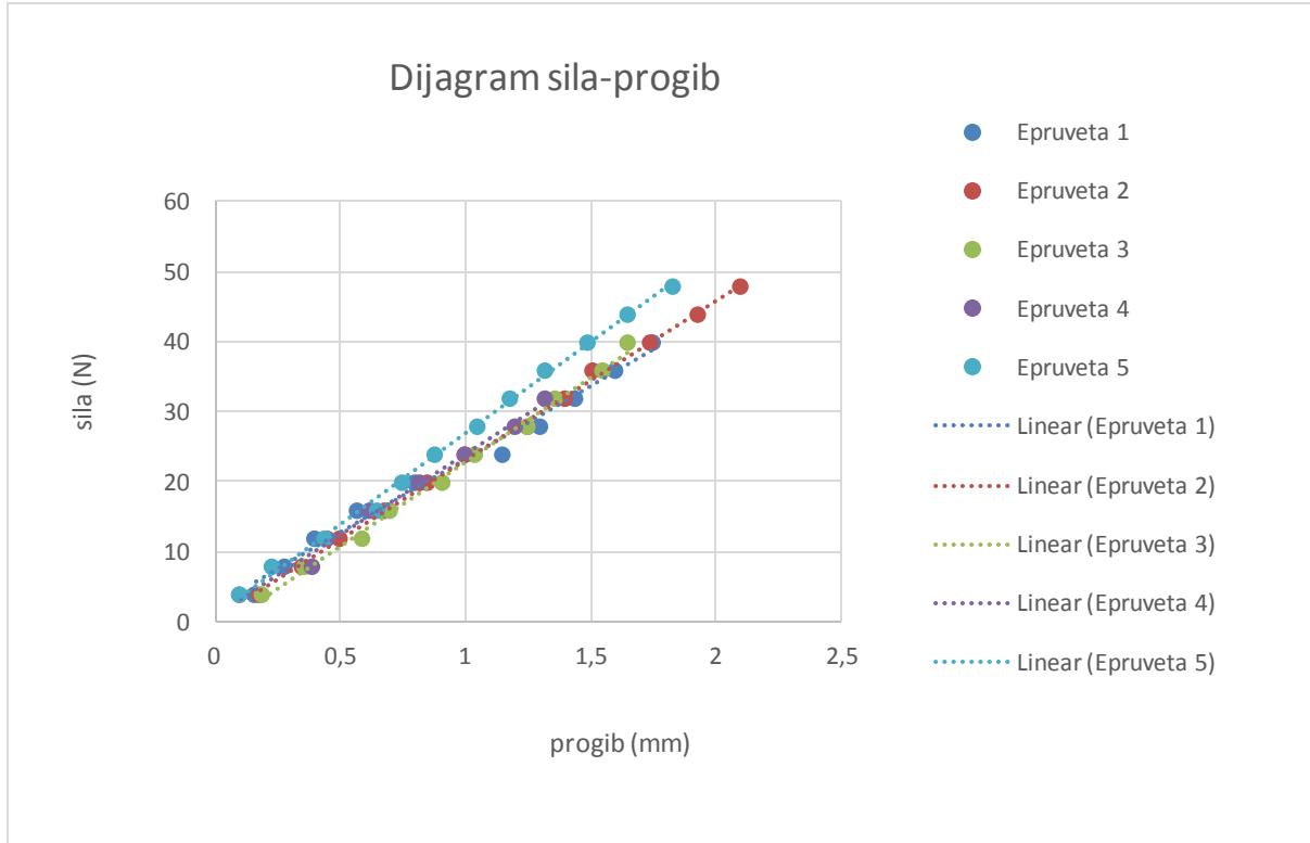
Slika 42. Ovisnost progiba o opterećenju za uzorak MT1
