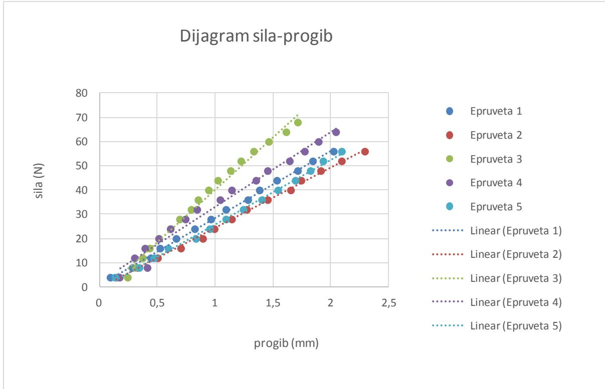
Slika 44. Ovisnost progiba o opterećenju za uzorak MT3
