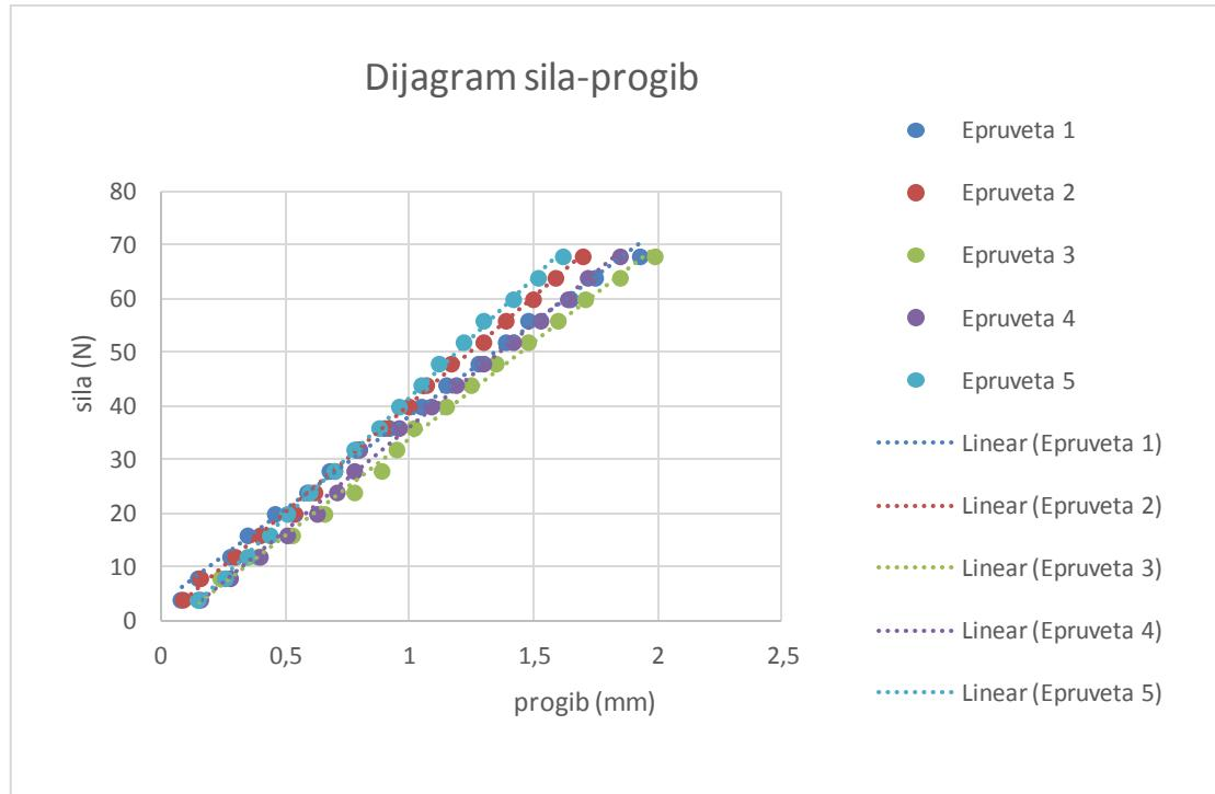
Slika 41. Ovisnost progiba o opterećenju za uzorak M3
