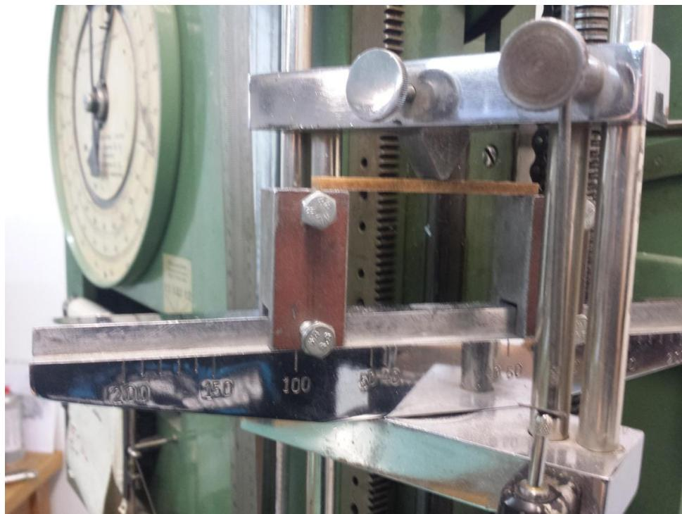
Slika 38. Savijanje uzorka na univerzalnoj kidalici
