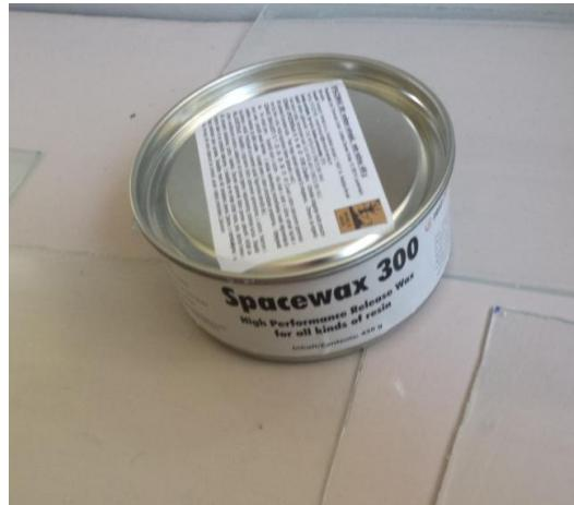
Slika 33. Spacewax 300 vosak za odvajanje
