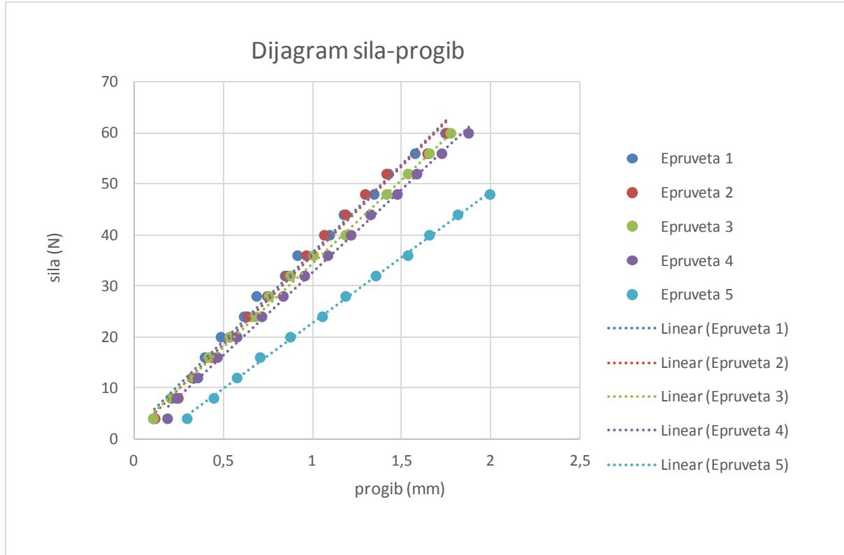
Slika 40. Ovisnost progiba o opterećenju za uzorak M2
