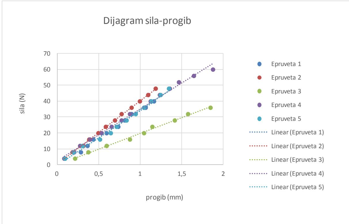
Slika 47. Ovisnost progiba o opterećenju za uzorak V3
