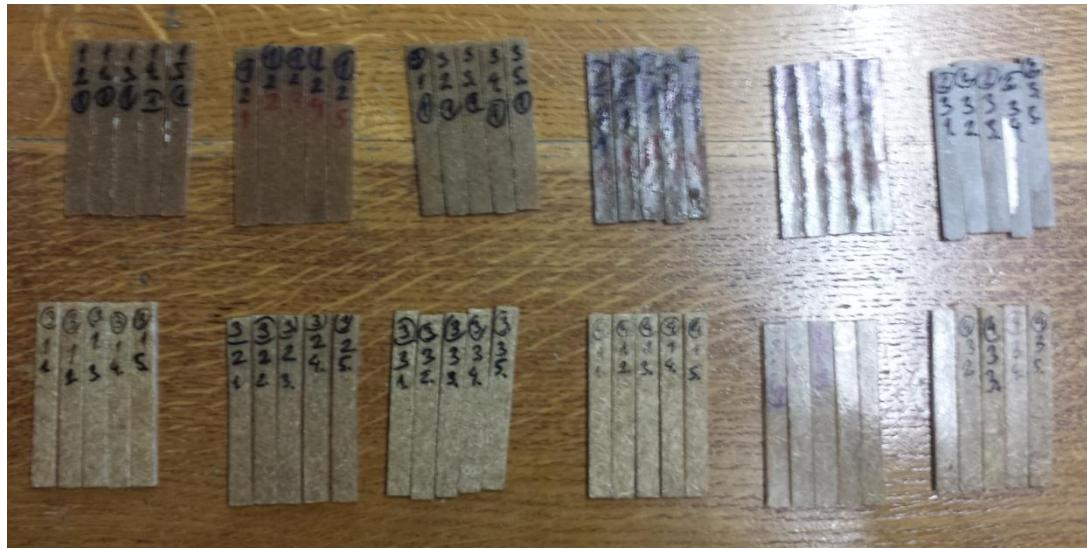
Slika 36. Izvađeni biokompozitni uzorci iz kalupa
