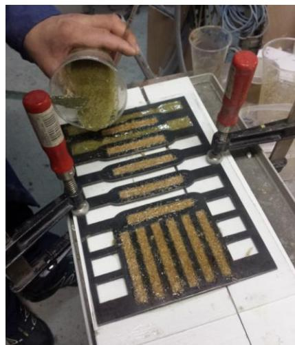
Slika 34. Priprema kalupa i ulijevanje suspenzije
