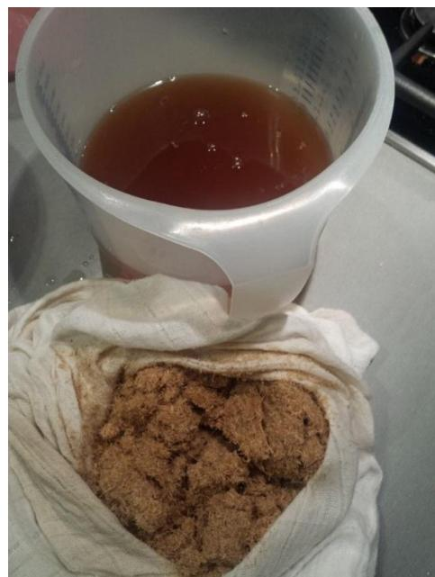
Slika 29. Filtriranje termički obrađenih drvnih čestica
