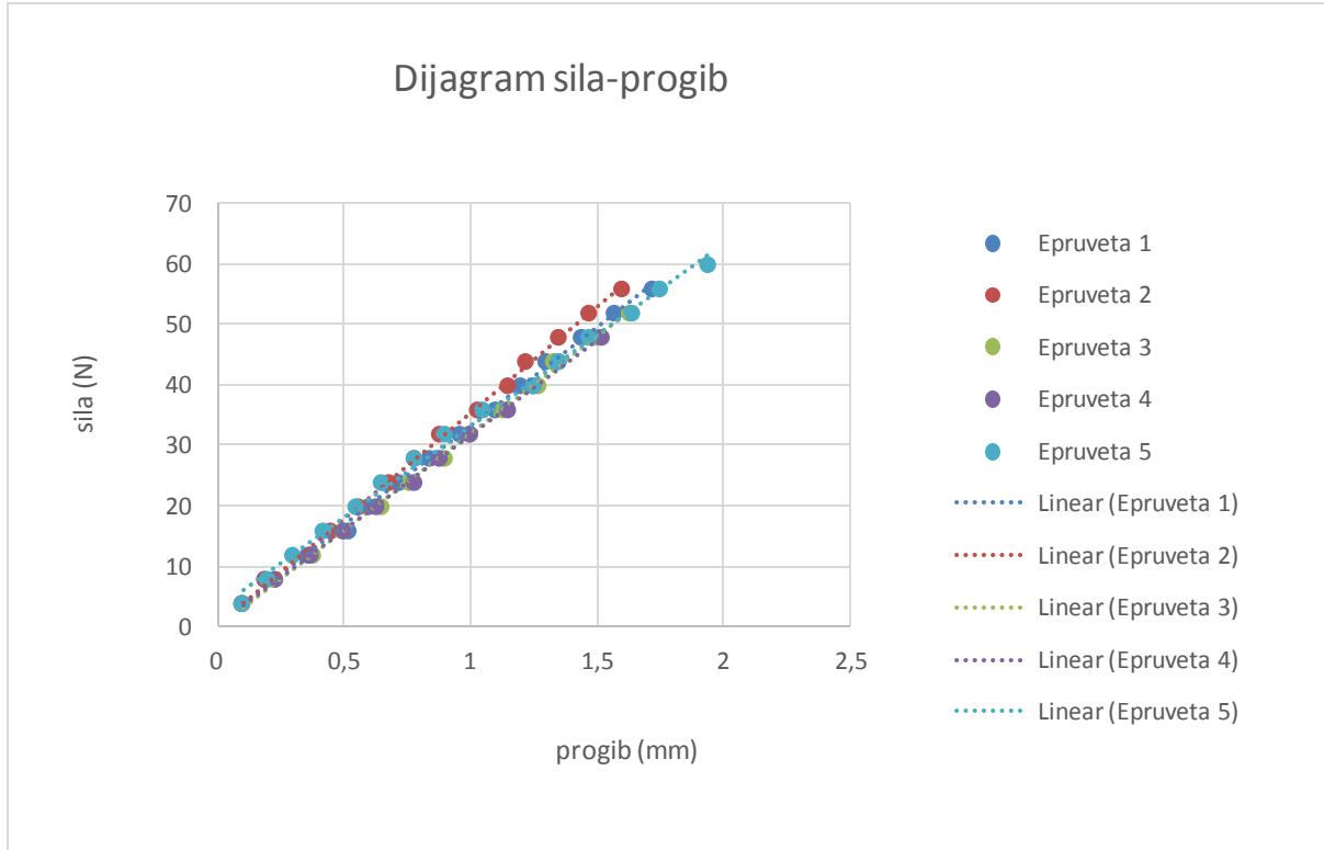
Slika 49. Ovisnost progiba o opterećenju za uzorak VT2
