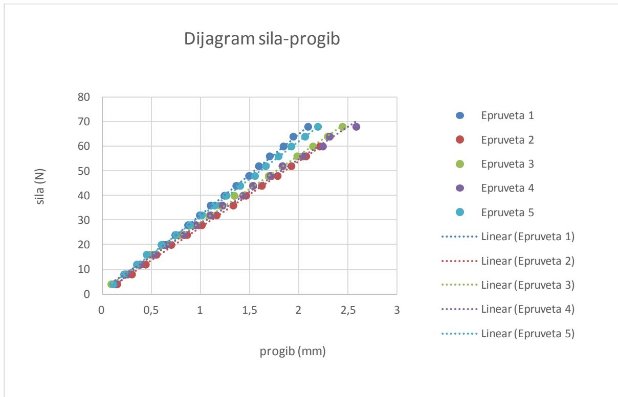
Slika 39. Ovisnost progiba o opterećenju za uzorak M1
