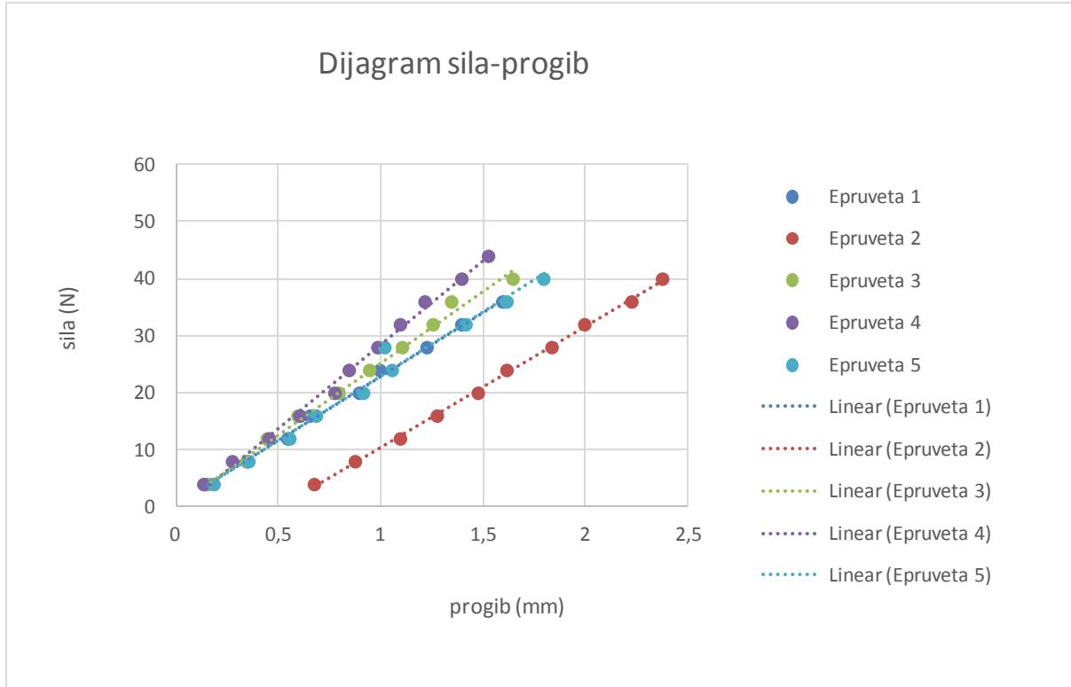
Slika 46. Ovisnost progiba o opterećenju za uzorak V2
