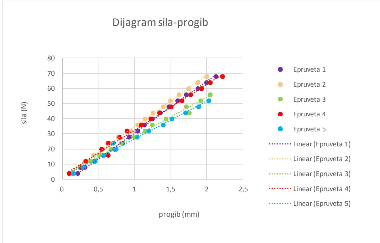
Slika 43. Ovisnost progiba o opterećenju za uzorak MT2
