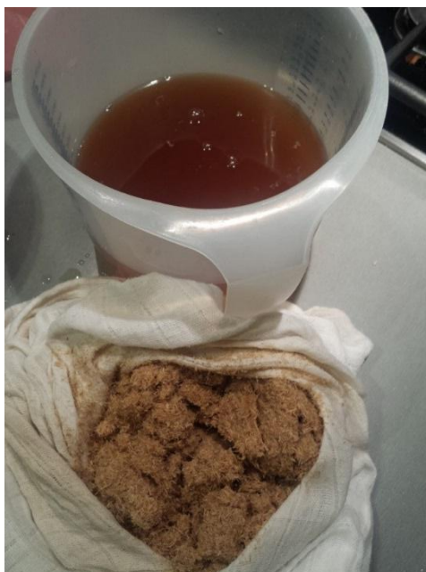
Slika 29. Filtriranje termički obrađenih drvnih čestica
