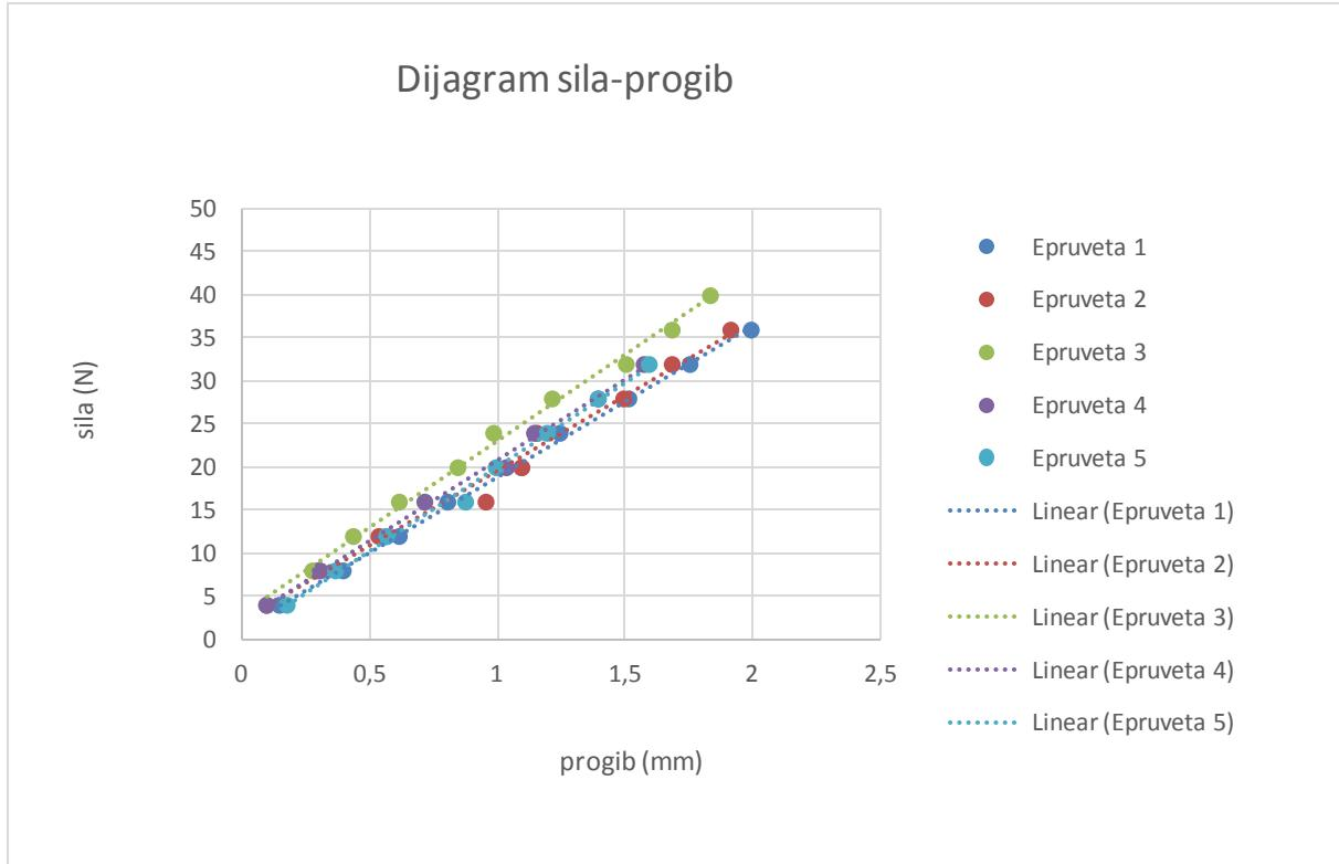
Slika 48. Ovisnost progiba o opterećenju za uzorak VT1
