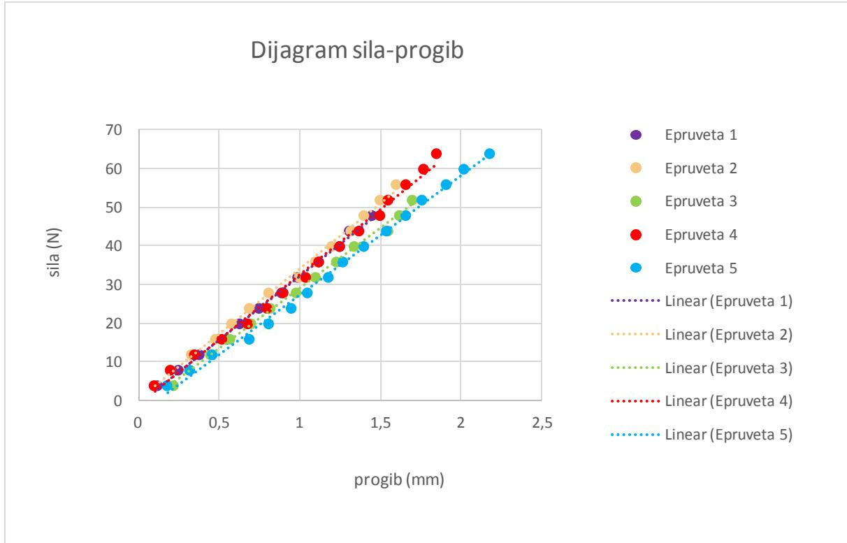
Slika 50. Ovisnost progiba o opterećenju za uzorak VT3
