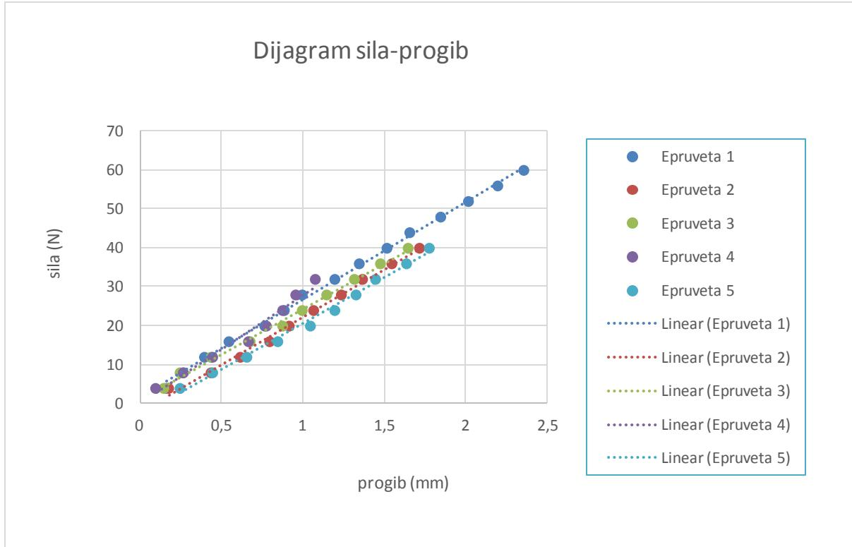
Slika 45. Ovisnost progiba o opterećenju za uzorak V1
