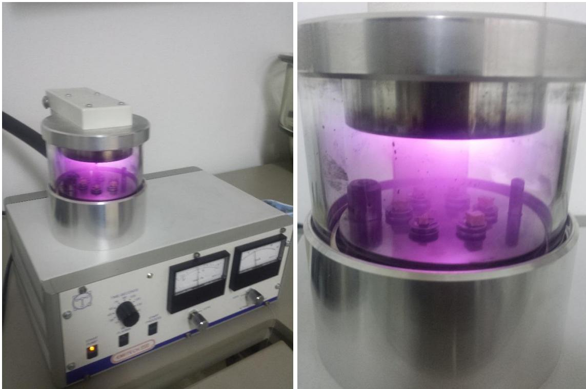
Slika 54. Naparivanje uzorka zlatom i paladijem
