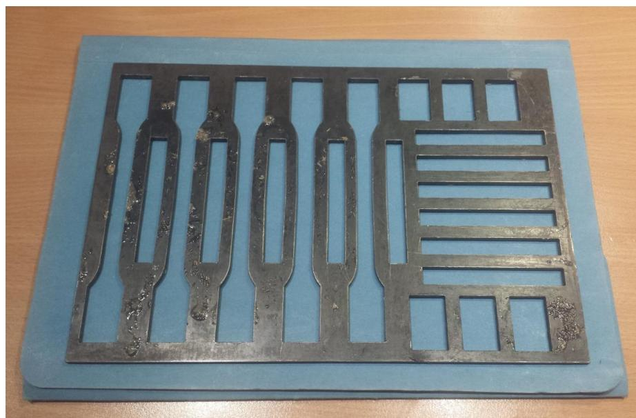
Slika 32. Kalupni okvir za izradu ispitnih tijela
