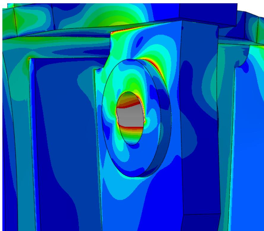
**Slika 66.** Raspodjela naprezanja kotla transformatora pri kosom zavješenju
