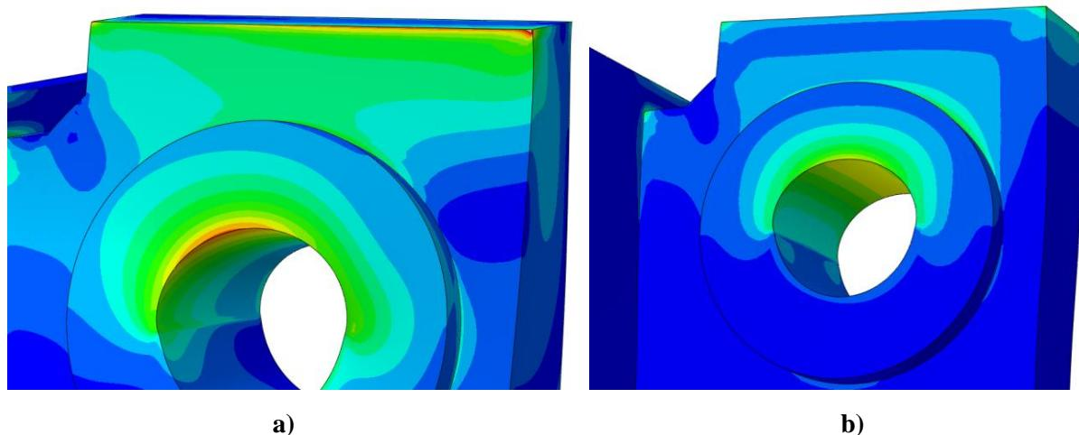
Slika 63. Raspodjela naprezanja zasebne analize 49 t zavjesnog elementa; a) kosog zavješenja, b) čistog vertikalnog zavješenja
