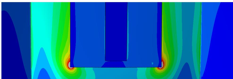
Slika 68. Raspodjela naprezanja kotla transformatora pri dnu zavjesnog elementa
