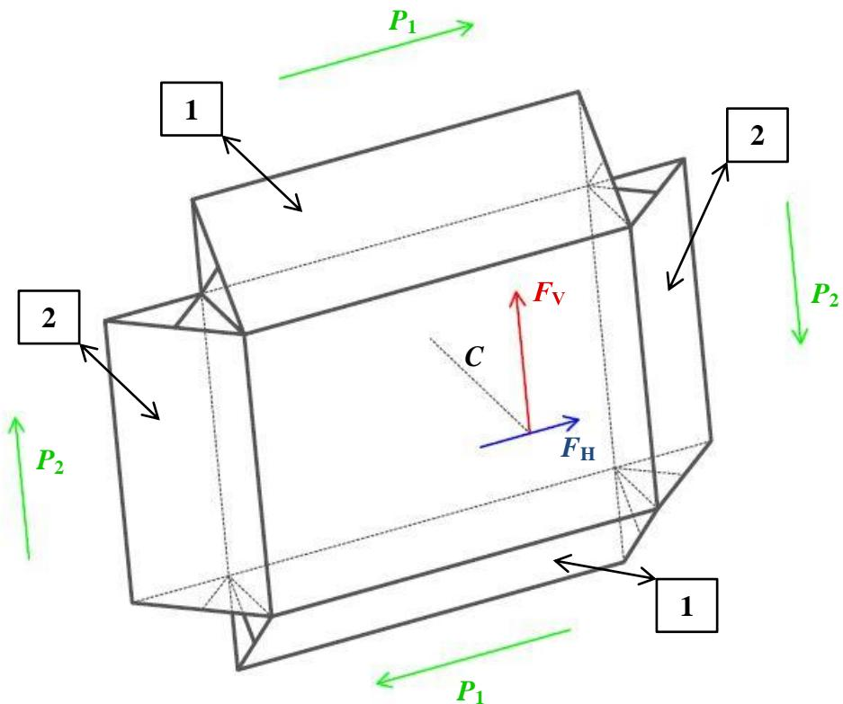
Slika 55. Opterećenje zavara pri kosom zavješenju transformatora
