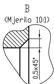
Napomena: Provrt Ø84 raditi u sklopu s poz. 1 nakon zavarivanja.
