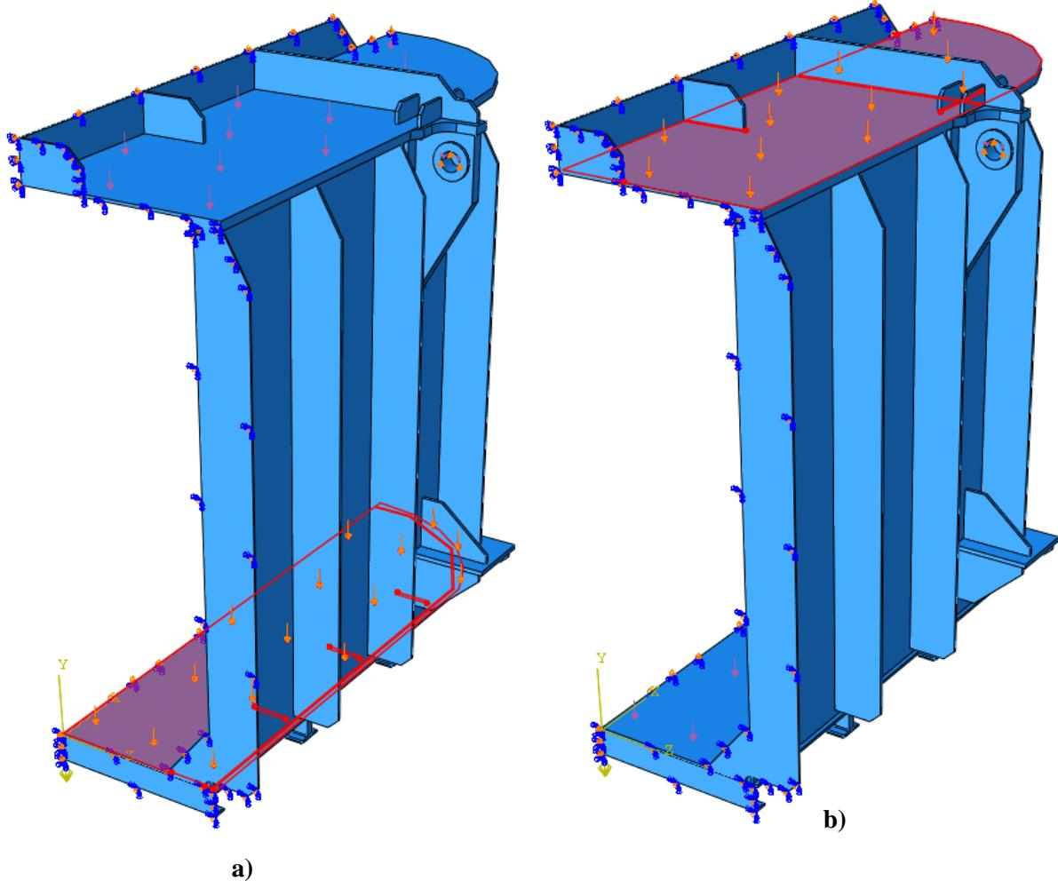
**Slika 33. a) Opterećenje dna kotla površinski pritiskom, b) Opterećenje poklopca površinskim pritiskom**
