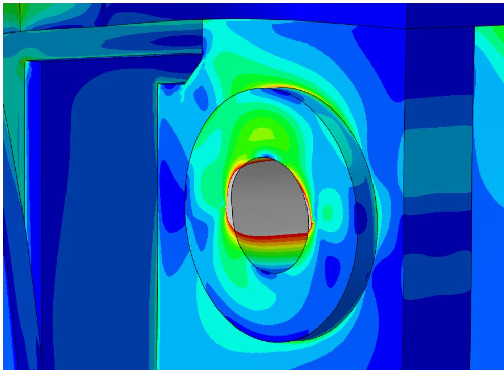
Slika 67. Raspodjela naprezanja kotla transformatora pri čistom vertikalnom zavješenju
