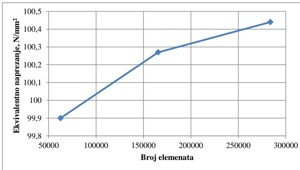
**Slika 29.** Konvergencija rješenja 30 t zavjesnog elementa za slučaj čistog vertikalnog zavješenja
