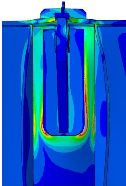
**Slika 74.** Naprezanja veća od dopuštenih; model sa zaobljenjem
