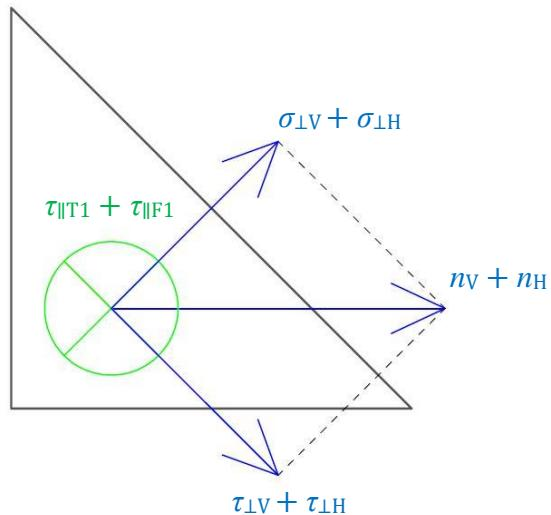
**Slika 61.** Naprezanja u gornjem desnom zavaru
