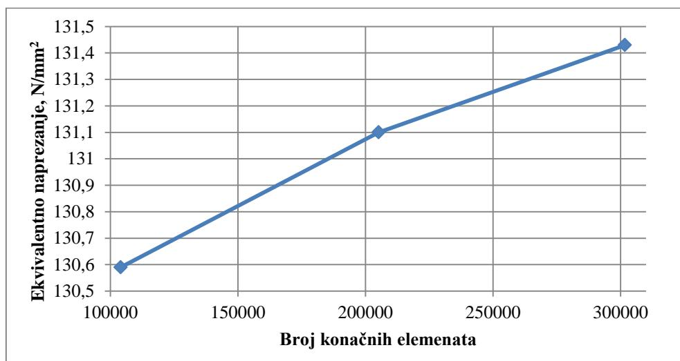
Slika 64. Konvergencija naprezanja kosog zavješenja 49 t zavjesnog elementa
