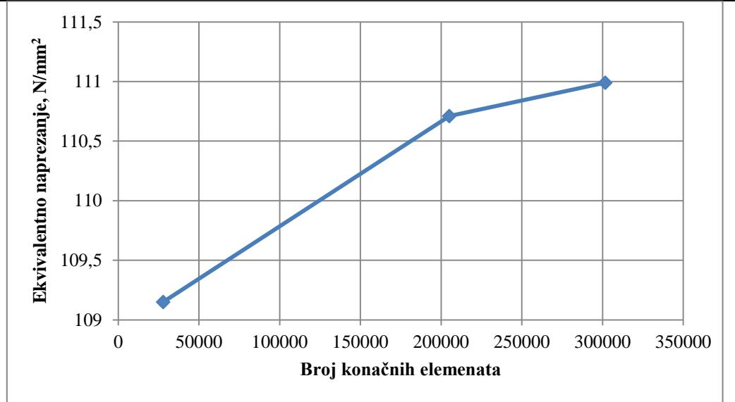
**Slika 65.** Konvergencija naprezanja čistog vertikalnog zavješenja 49 t zavjesnog elementa
