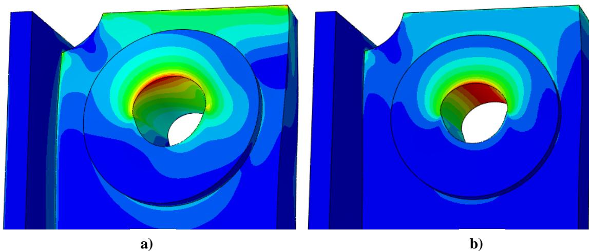
Slika 69. Raspodjela naprezanja zasebne analize 75 t zavjesnog elementa; a) kosog zavješenja, b) čistog vertikalnog zavješenja
