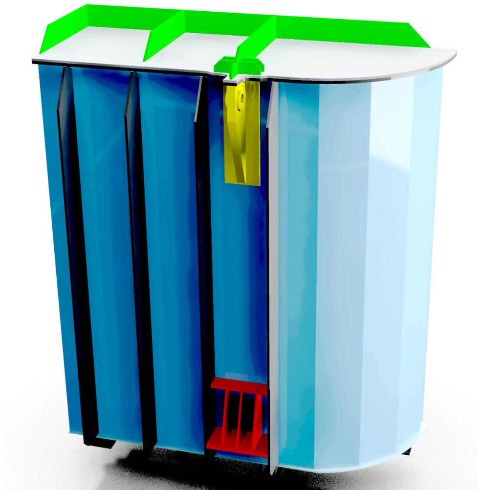
**Slika 14. Proračunski model transformatora s novim zavjesnim elementima**
