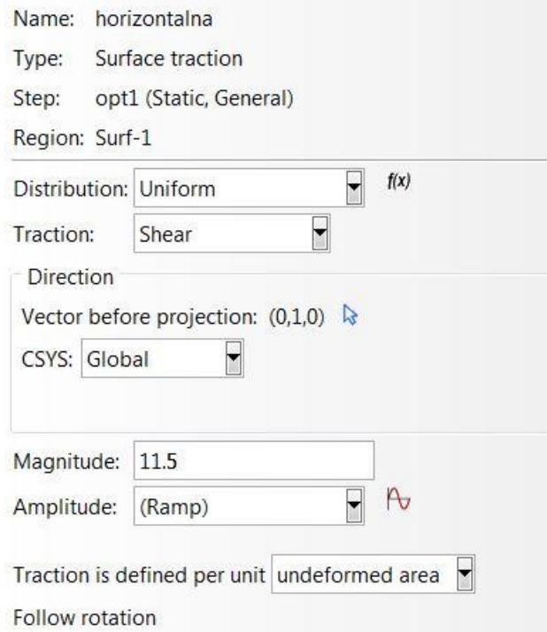
**Slika 21.** Model horizontalne komponente sile
