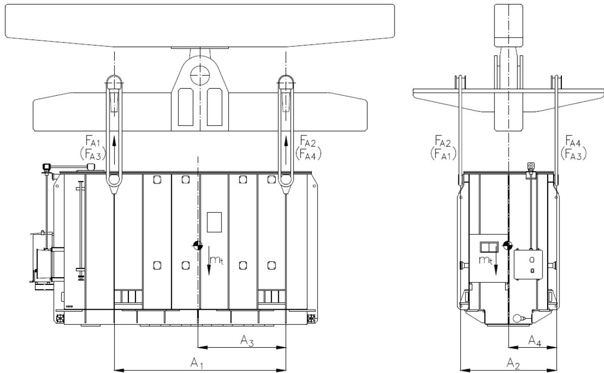
Slika 3. Čisto vertikalno zavješenje transformatora [2]
