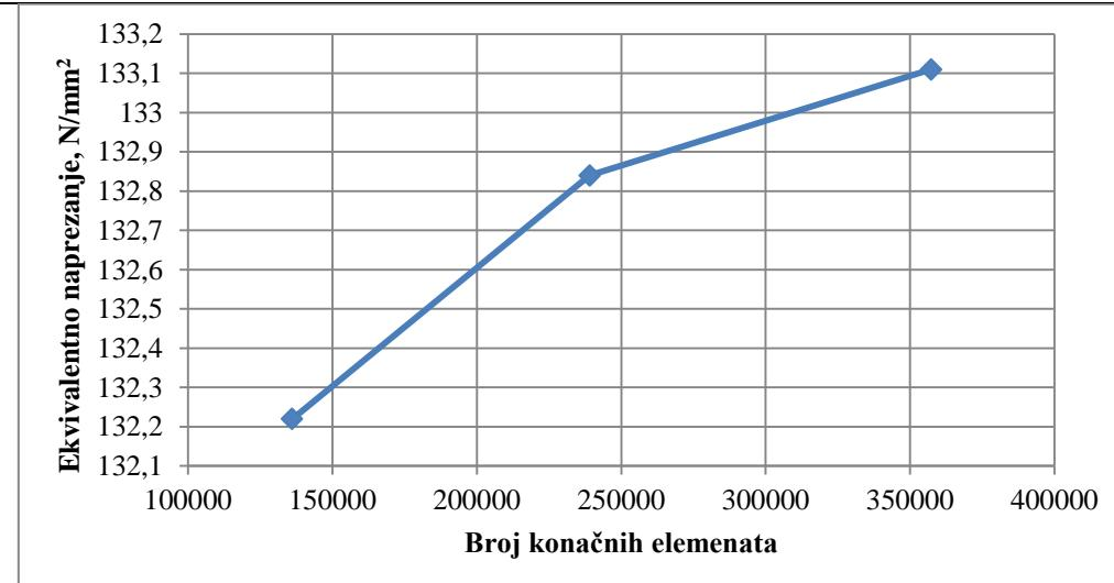
**Slika 71.** Konvergencija naprezanja čistog vertikalnog zavješenja 75 t zavjesnog elementa
