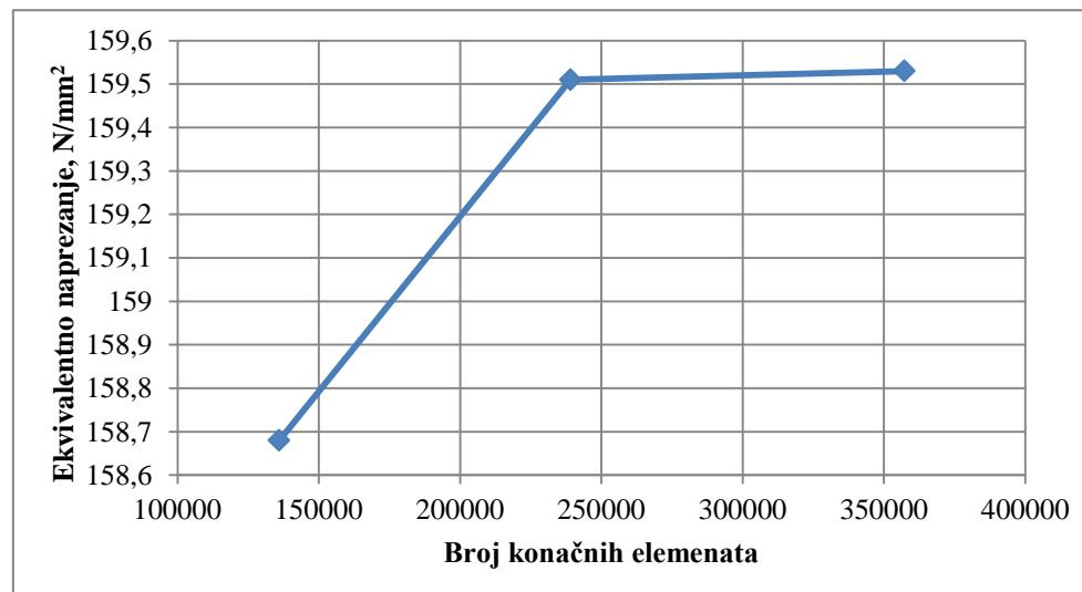
Slika 70. Konvergencija naprezanja kosog zavješenja 75 t zavjesnog elementa
