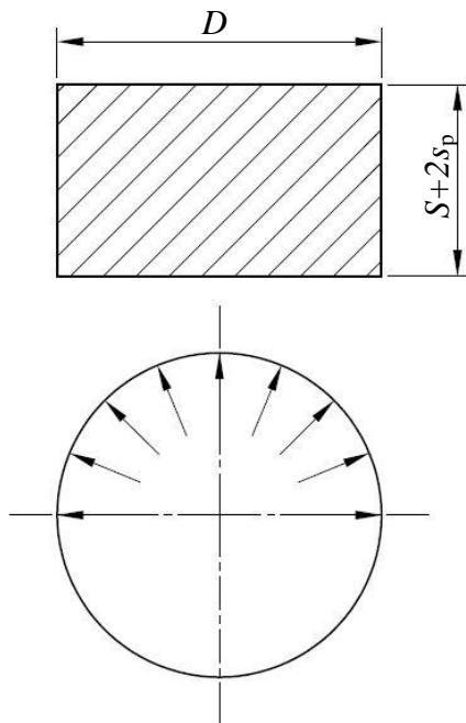
**Slika 18.** Površina na koju djeluje vertikalni površinski pritisak
