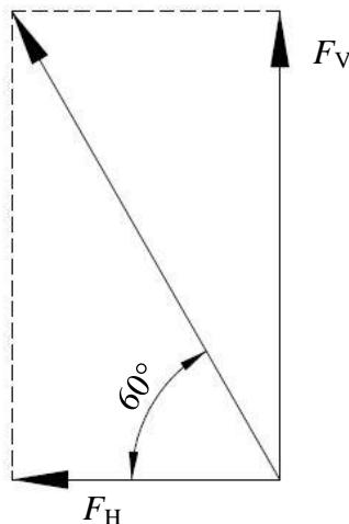
**Slika 20.** Odnos vertikalne i horizontalne komponente sile
