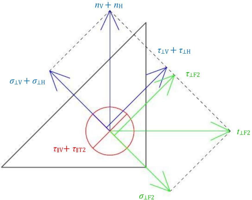
**Slika 59.** Naprezanja u bočnom donjem lijevom kutu zavaru
