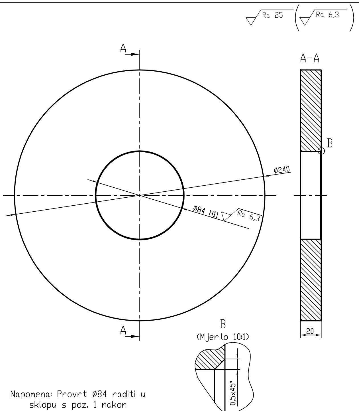
Napomena: Provrt Ø84 raditi u sklopu s poz. 1 nakon zavarivanja.
