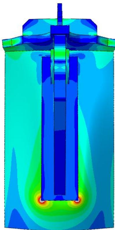
Slika 50. Raspodjela naprezanja podmodela pri čistom vertikalnom zavješenju
