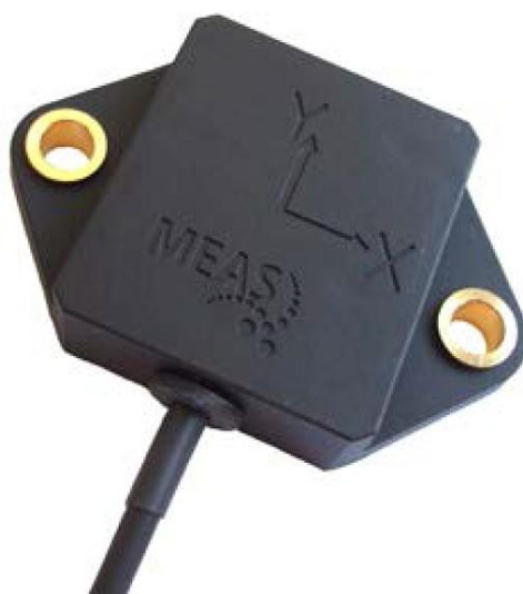
Slika 71. Inklinometar tvrtke Measurement specialists - DOG2 MEMS [15]
