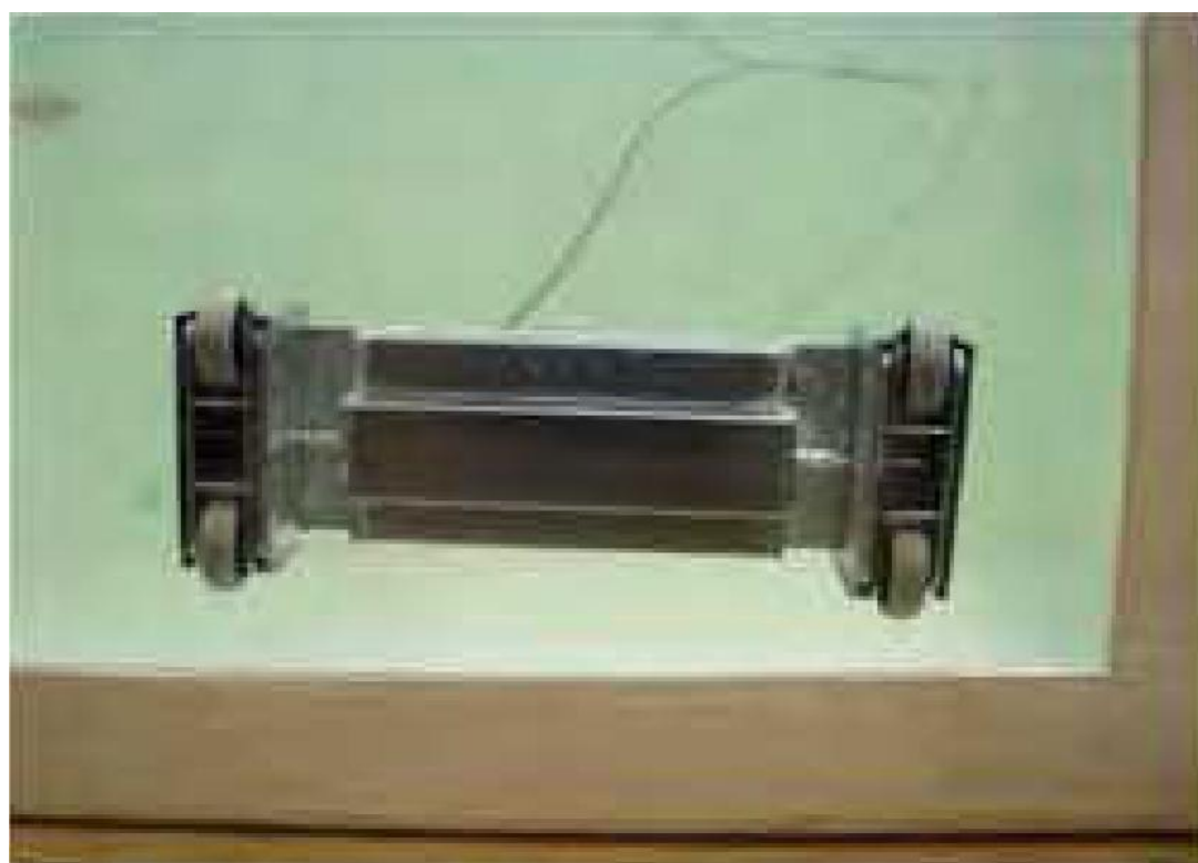
Slika 16. Ispitivanje vertikalne stjenke spremnika prototip 1 – RobTank [5]
