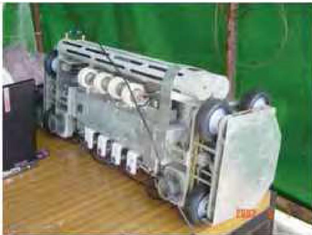
Slika 19. Sonde u kotačima robota RobTank [5]
