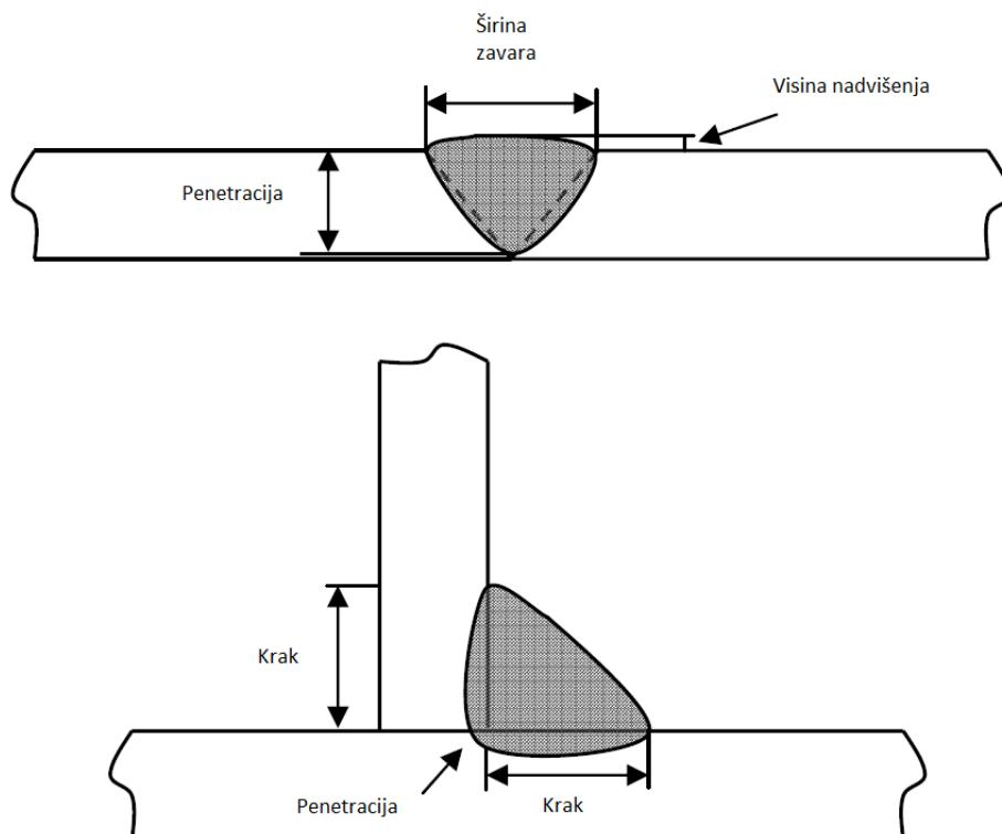
Slika 3.10. Parametri sučeljenog spoja i kutnog spoja [4]
