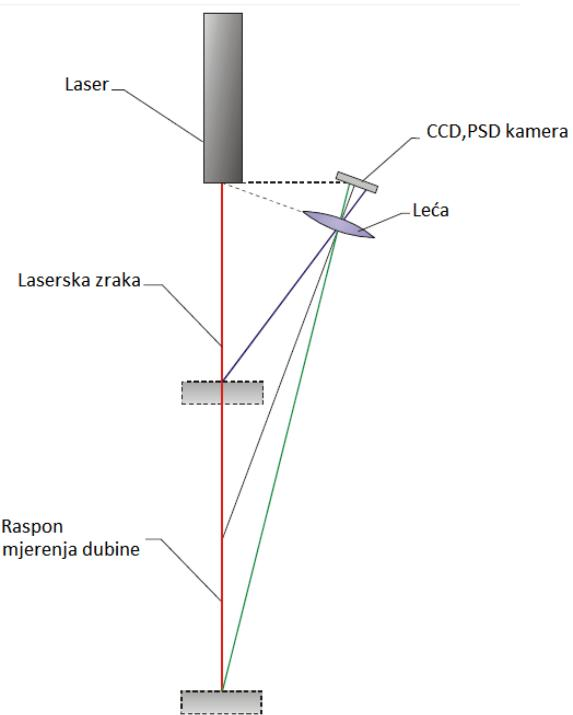
Slika 3.11. Princip triangulacije [23]
