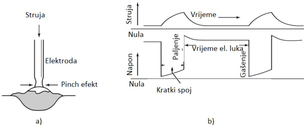
Slika 2.2. Prijenos materijala kratkim spojem, pojednostavljeni prikaz (a) i dijagramske prikaze ovisnosti struje i napona tijekom kratkog spoja (b) [2]
