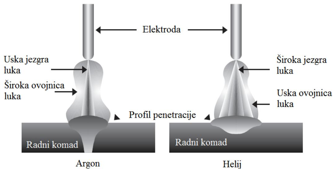
Slika 2.6. Geometrija električnog luka i profil zavarenog spoja kod različitih zaštitnih plinova
