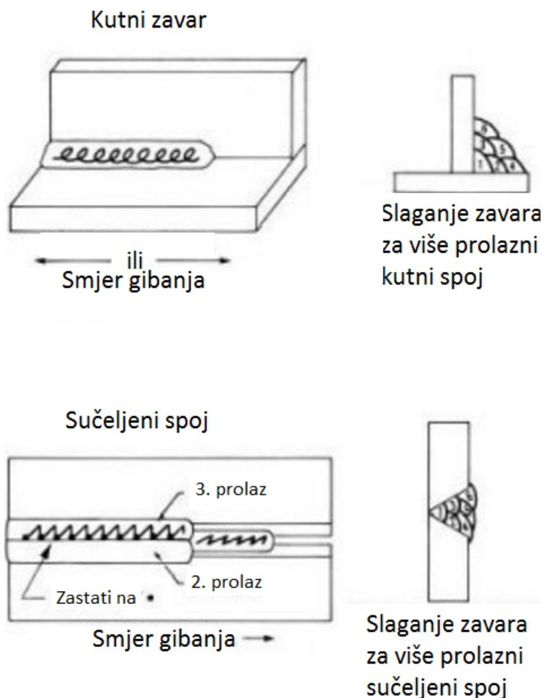
Slika 2.12. Zavarivanje u vertikalno horizontalnom položaju [8]
