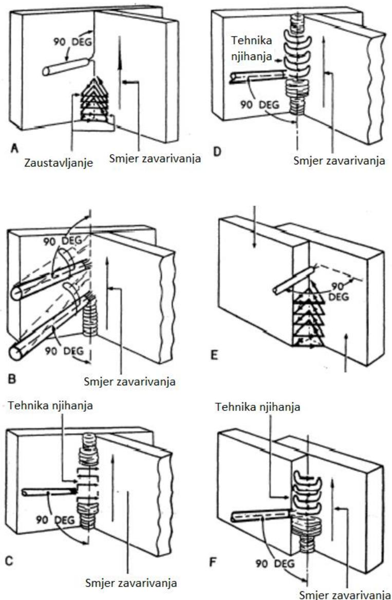
*Slika 2.14. Vertikalno zavarivanje preklopog i T spoja [10]*
