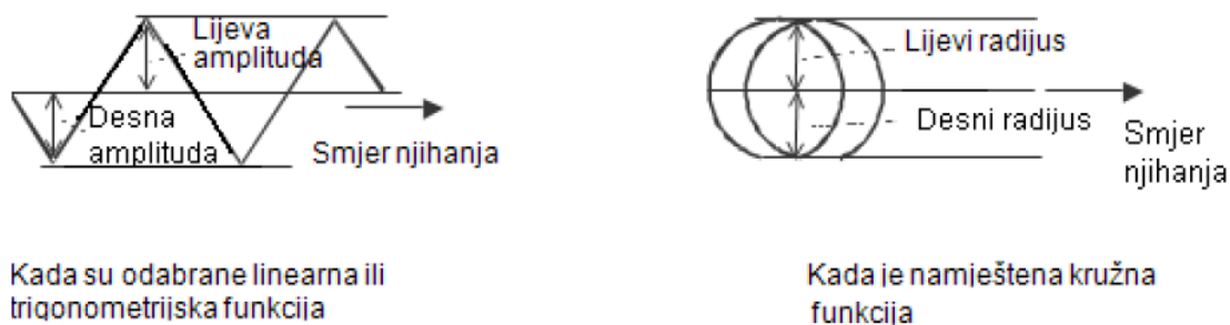
Slika 4.10. Definiranje amplitude pri linearnoj i trigonometrijskoj te kružnoj funkciji
