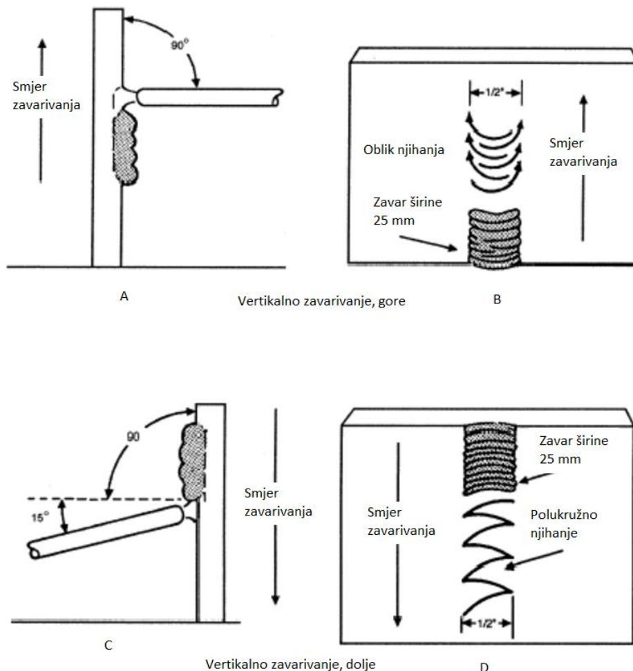
Slika 2.13. Vertikalno zavarivanje prema gore i dolje [8]
