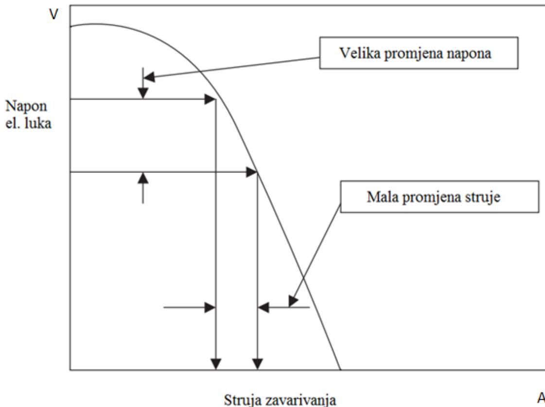
Slika 2.5. Strmopadajuća izlazna naponska karakteristika stroja [2]
