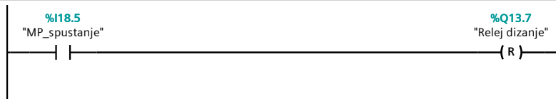
Network 9: Sprječavanja spustanja teleskopa ako se nalazi (tlocrtno) iznad kabine kamiona.
