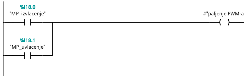
Network 6: Ako je aktivan MP za izvlacenje onda se aktivira pripadajući relej (normalno otvoreni kontakt omogućava izvlacenje)
