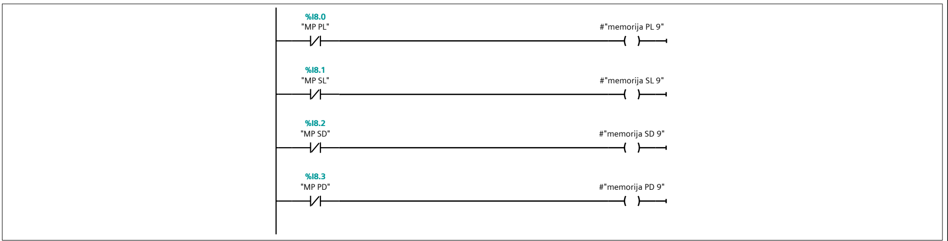
Network 10: STABILIZATORI SPUŠTENI; alfa = 0, beta = 0 ; aktiviran signal za detekciju niveliranosti
