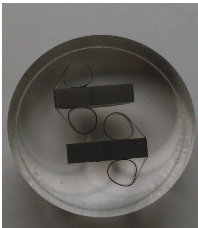
Slika 44. Uzorak zaliven u polimernu masu
