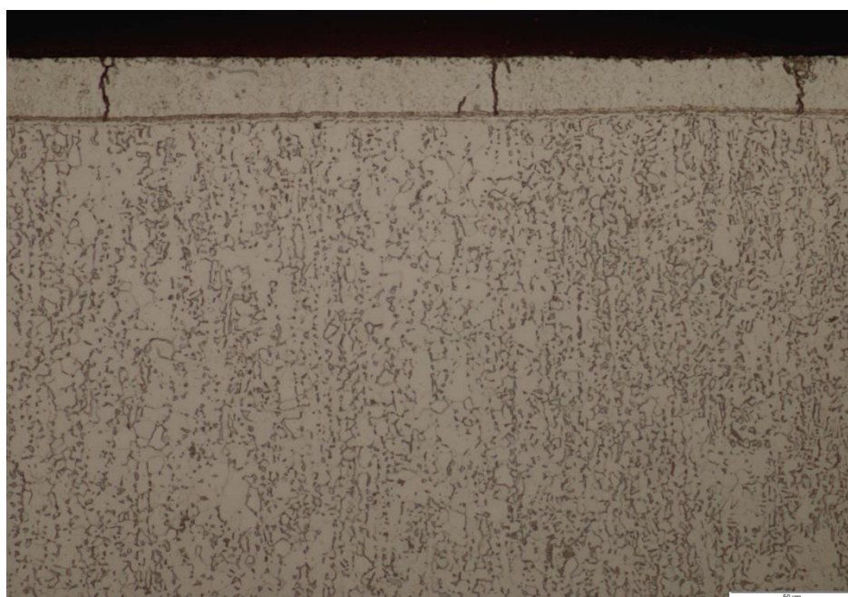
Slika 52. Mikrostruktura rubnog sloja, 500x
