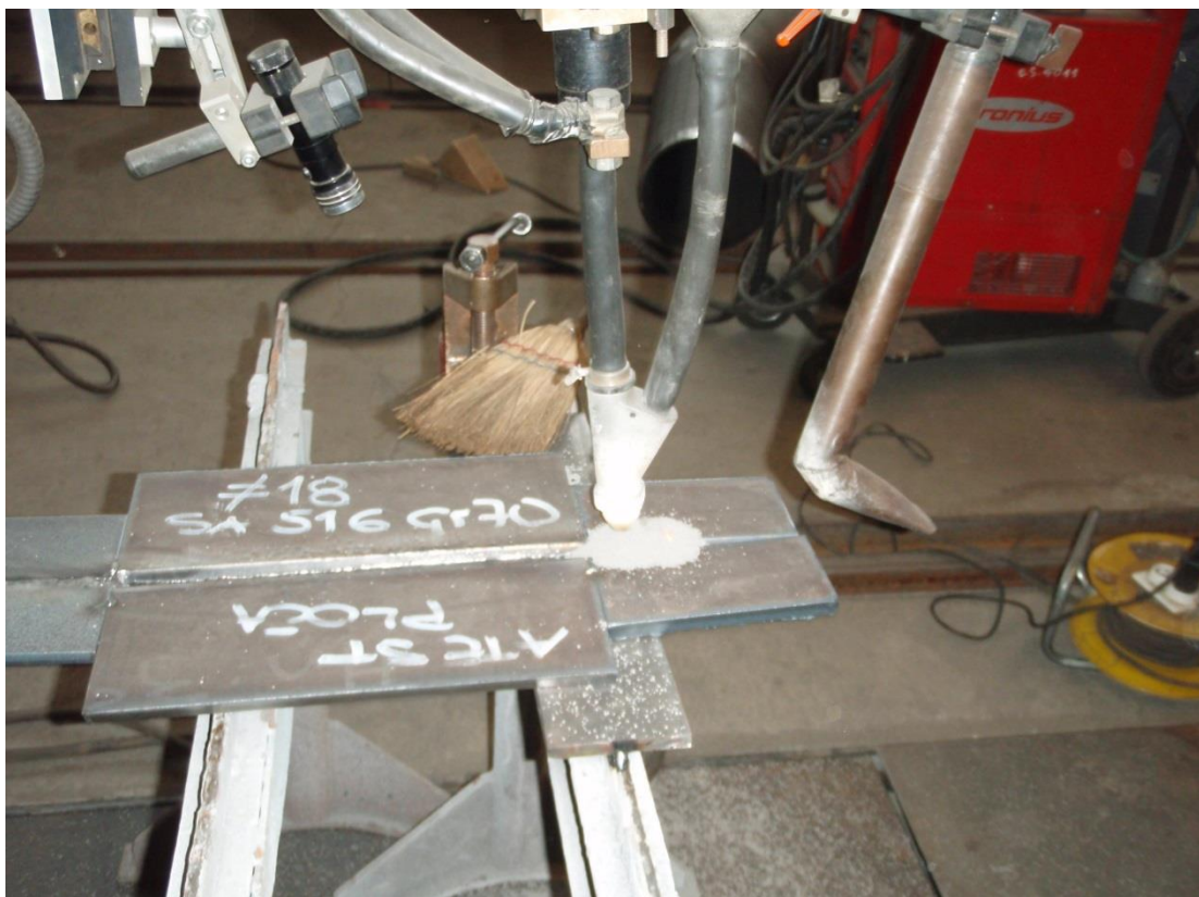
Slika 45. Uspostava električnog luka kod EPP zavarivanja [29]
