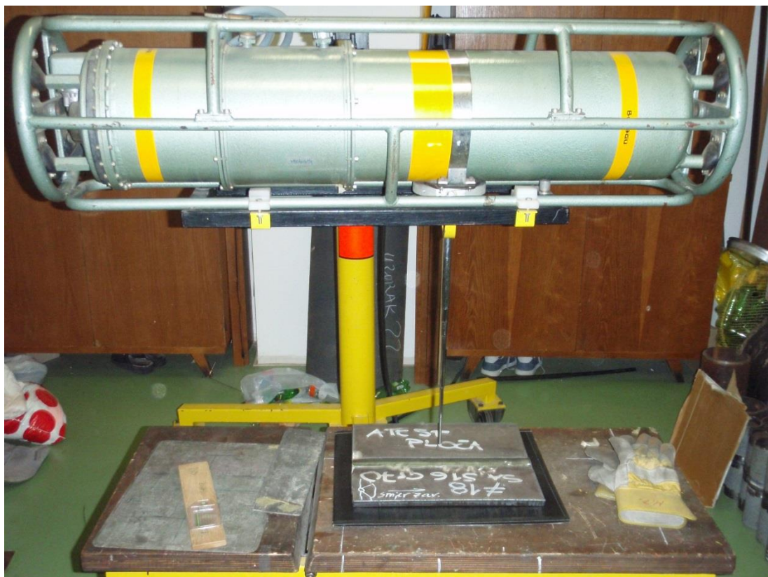
Slika 52. Radni komad pripremljen za radiografsko ispitivanje [29]
