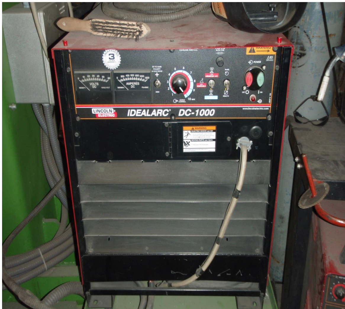
Slika 41. Uređaj za EPP zavarivanje Lincoln Electric, Idealarc – DC 1000 [29]
