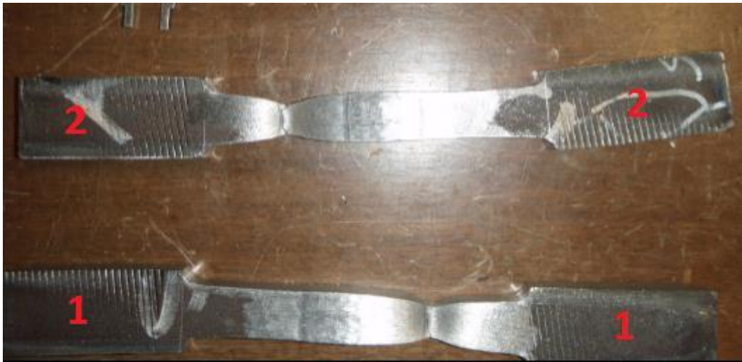
Slika 60. Epruvete nakon procesa kidanja [29]
