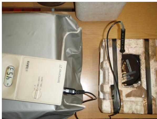
Slika 74. Podhlađivanje uzoraka u smjesi suhog leda i alkohola [29]
