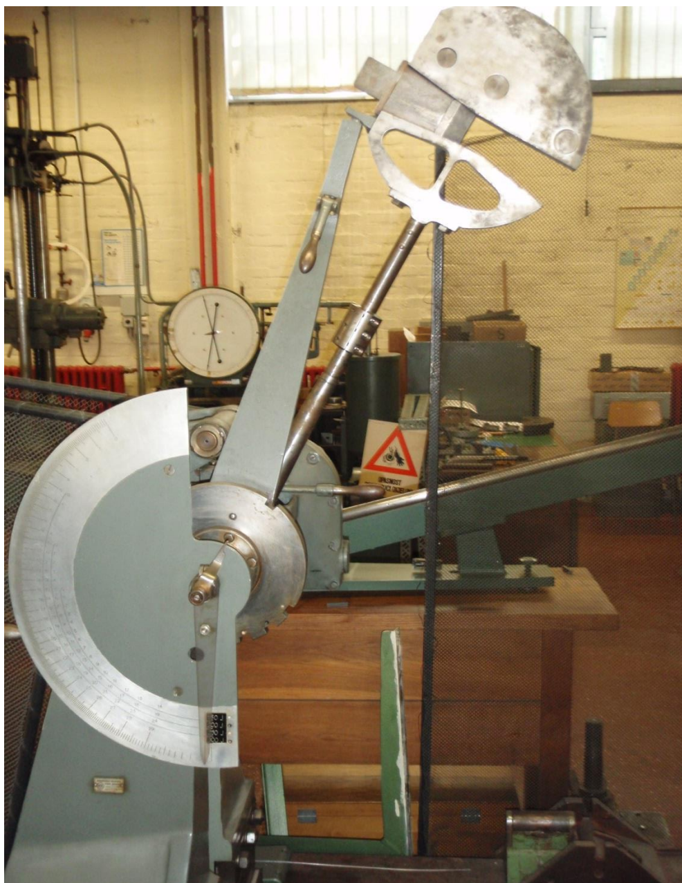
Slika 68. Charpy – ev bat na kojem je mjereno udarno rad loma [29]
