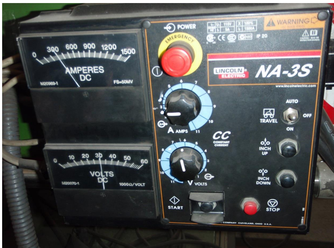
Slika 46. Vrijednosti struje i napona prilikom EPP zavarivanja [29]
