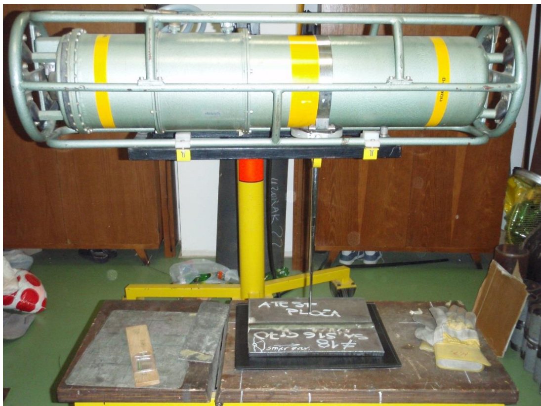
Slika 52. Radni komad pripremljen za radiografsko ispitivanje [29]
