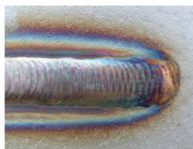
b) Obojenja površine nastala unosom topline zavarivanjem
