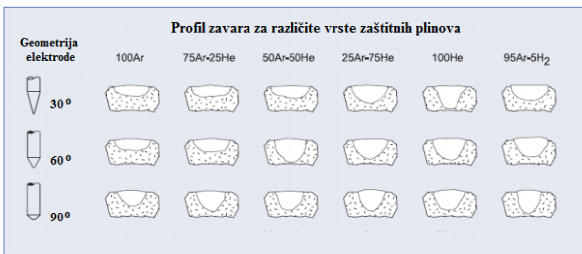
Slika 10. Utjecaj vrste plina i mješavine plinova na oblik zavara i penetraciju [25]
