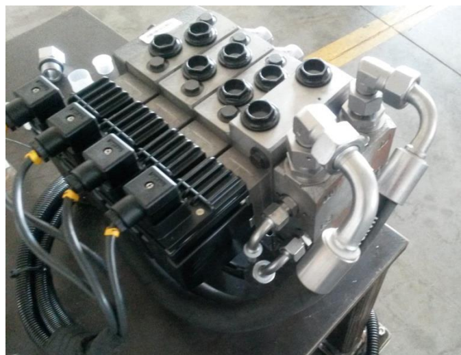
Slika 37. Spajanje razvodnika sa pumpom
