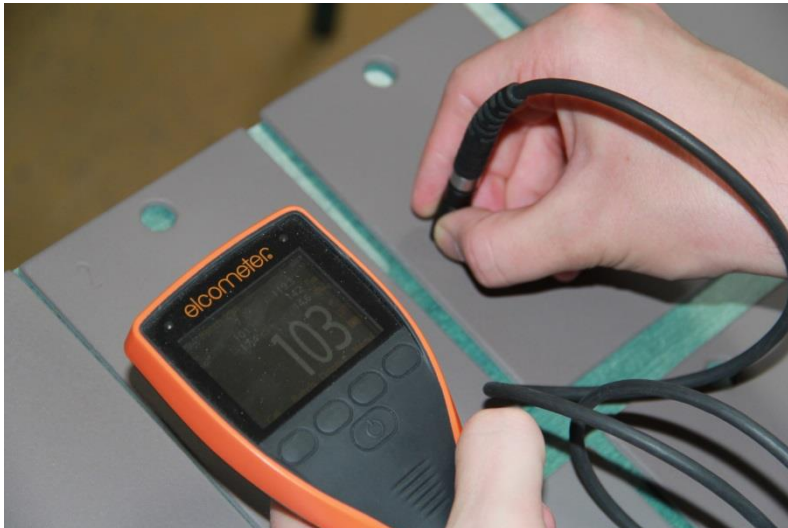
Slika 43. Mjerenje debljine suhog filma premaza uređajem Elcometer 456
