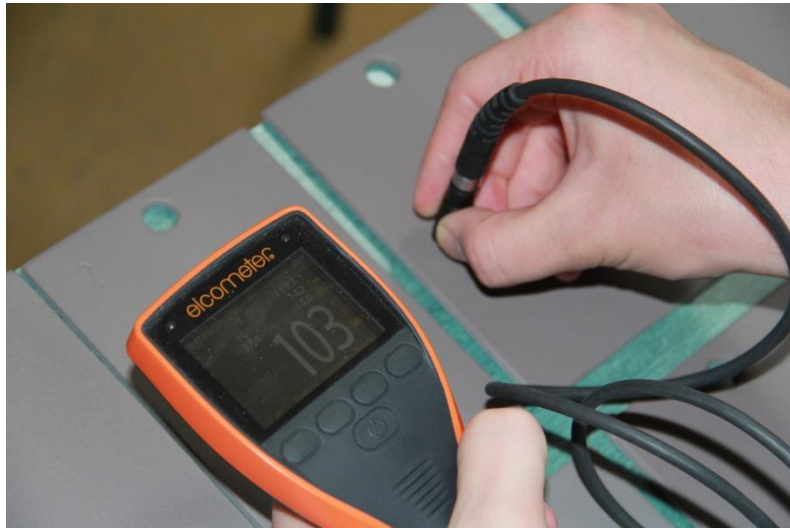
Slika 43. Mjerenje debljine suhog filma premaza uređajem Elcometer 456
