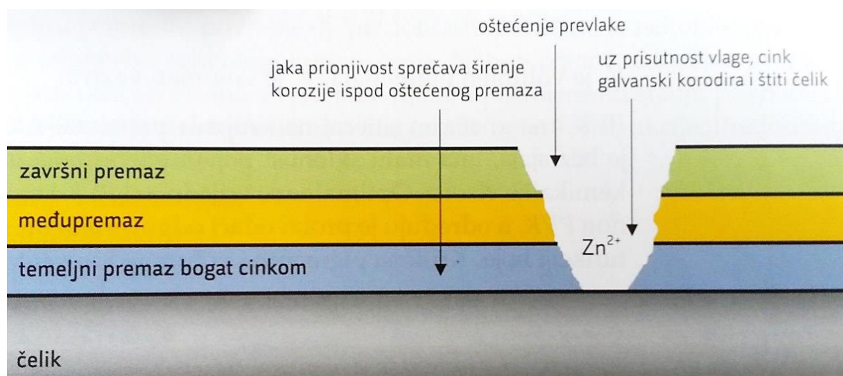
Slika 12. Galvanski učinak zaštite premazima [5]
