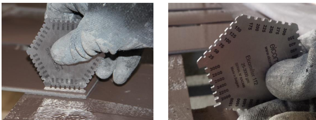
Slika 42. Mjerenje debljine mokrog filma premaza (DMF) češljem
