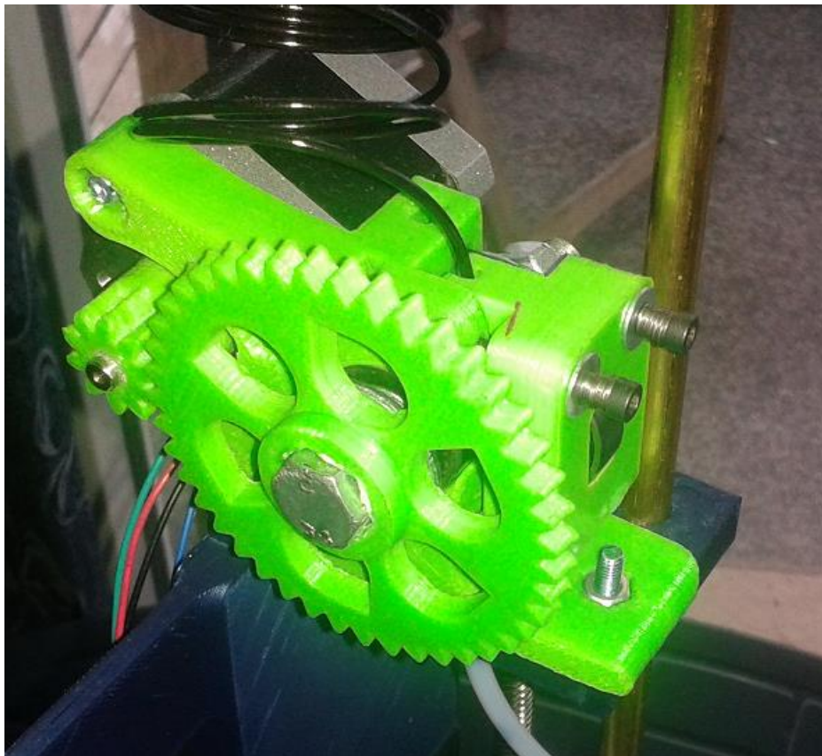
Slika 14: Gornji dio ekstrudera (ispisani dio)
