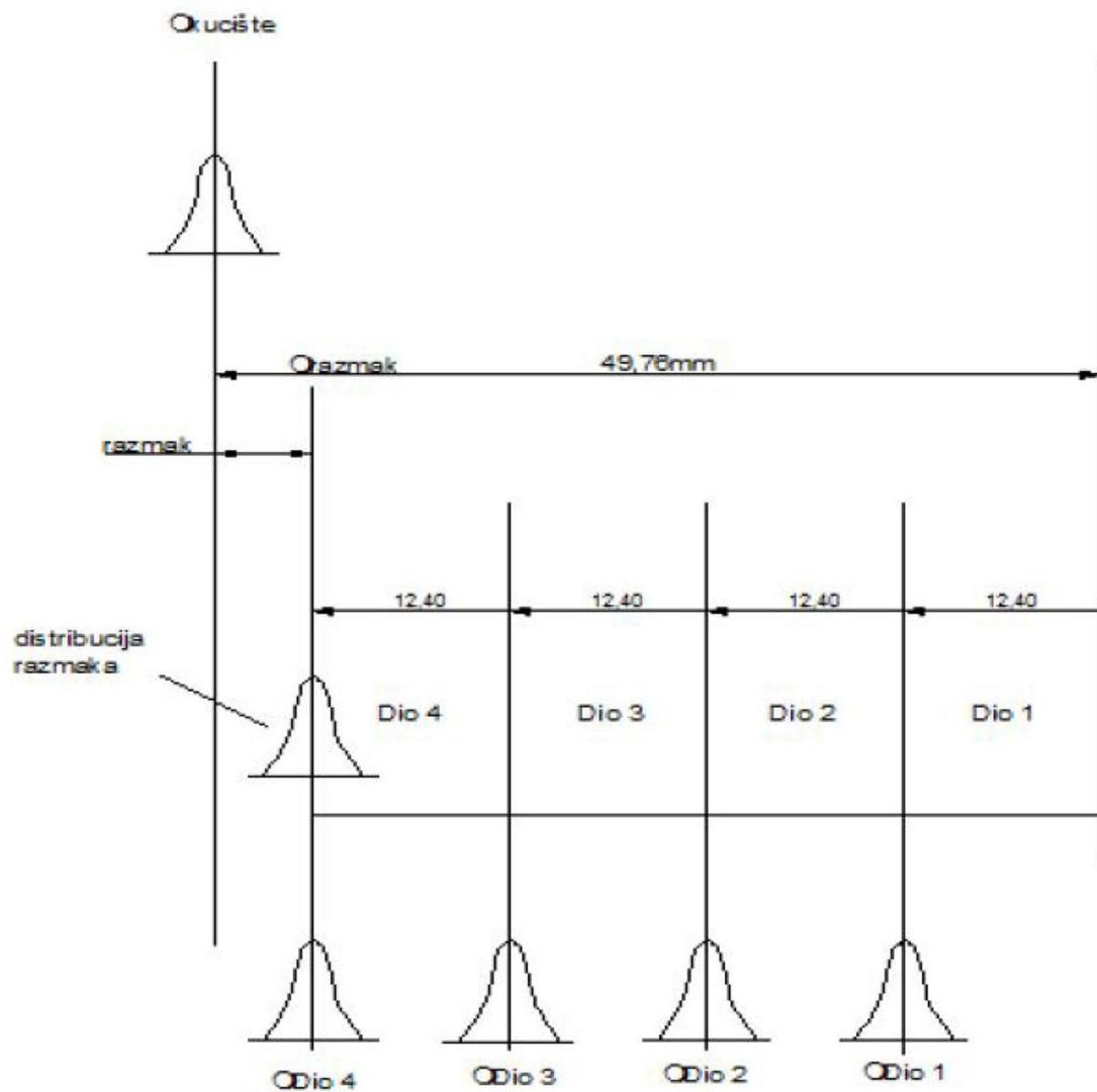
**Slika 26. Standardna odstupanja dijelova i sklopa [8]**
