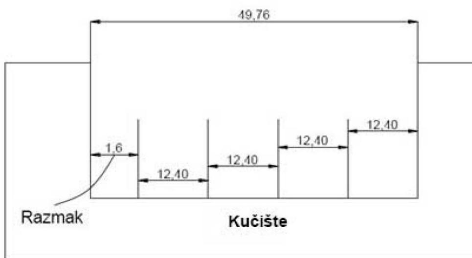
**Slika 22. Razmak između kućišta i prvog dijela [8]**
