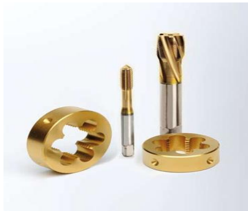
Slika 7: TiN prevlaka na reznim alatima [21]
