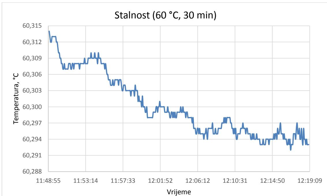
Slika 12. Dijagramski prikaz stalnosti temperature za 60 °C
