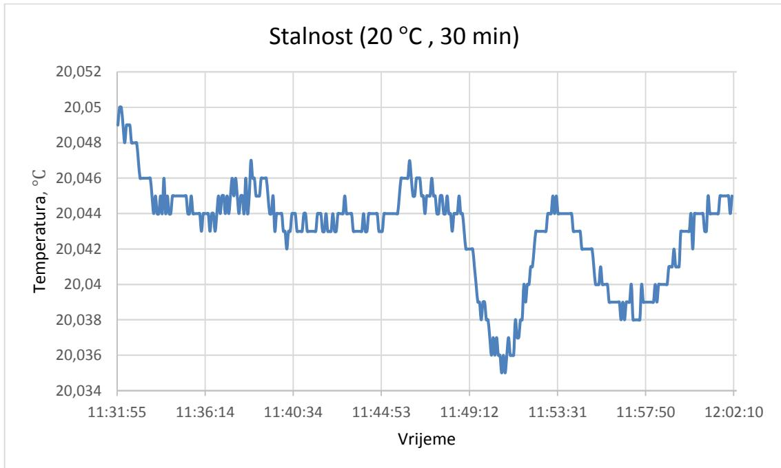
Slika 10. Dijagramski prikaz stalnosti temperature za 20 °C
