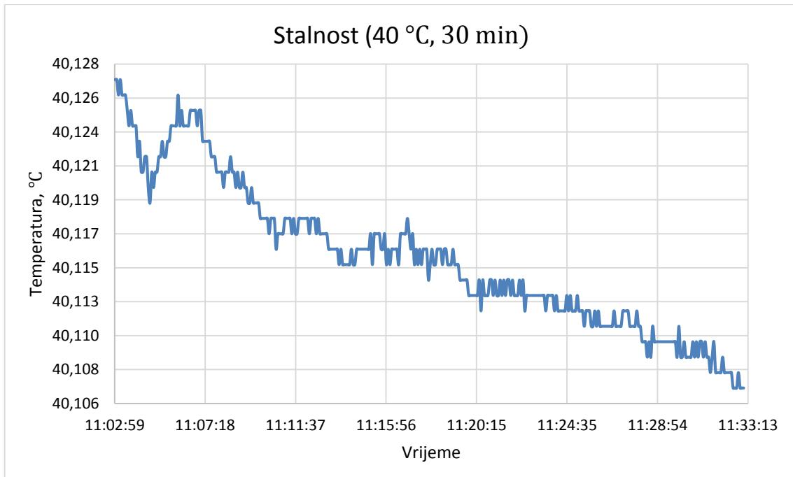
Slika 11. Dijagramski prikaz stalnosti temperature za 40 °C
