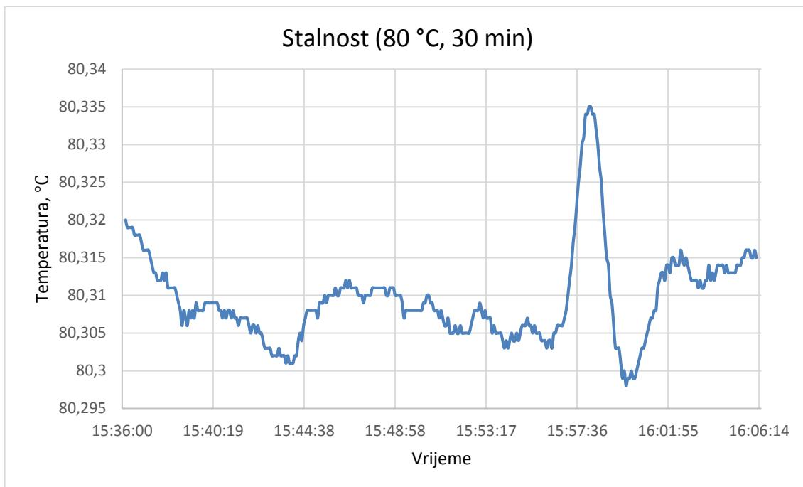
Slika 13. Dijagramski prikaz stalnosti temperature za 80 °C
