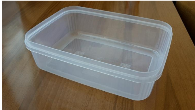
Slika 11. Kalup korišten za drveno plastični kompozit ojačan krupnim česticama
