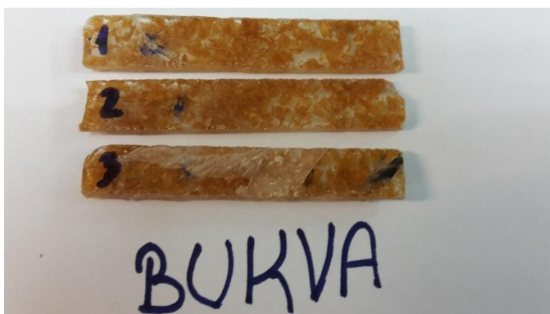
Slika 19. Kompozit s krupnim česticama bukve
