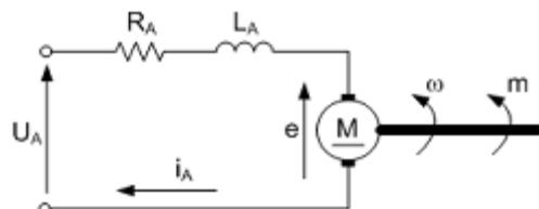
Slika 3.2 Nadomjesna shema istosmjernog motora s uzbudnim permanentnim magnetima
