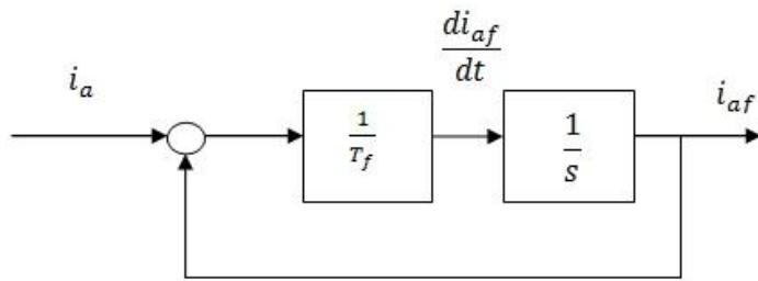
Slika 7.2 Prikaz derivacije signala struje u blokovskom dijagramu
