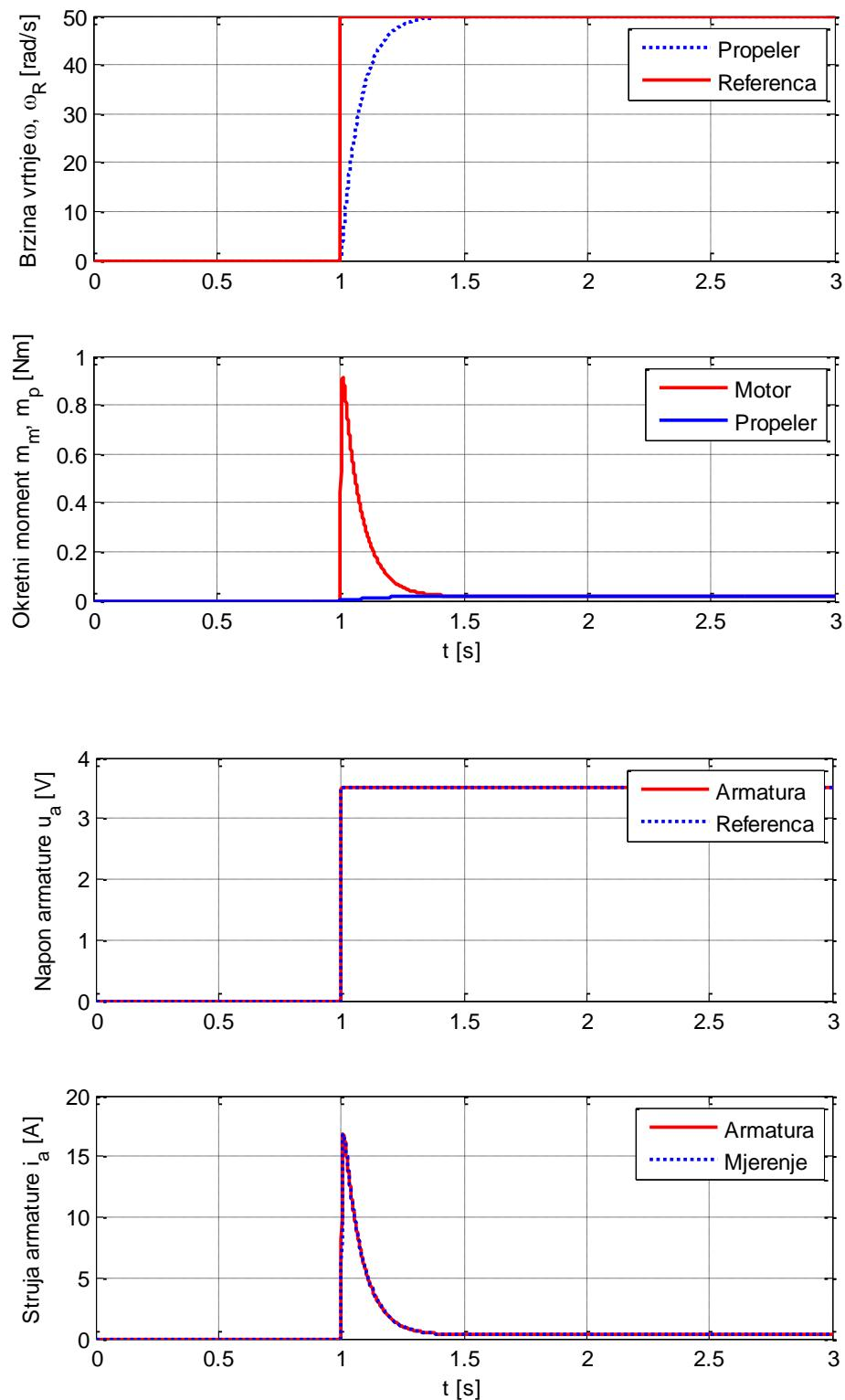
Slika 4.2 Rezultati simulacije upravljanja s referentnom brzinom vrtnje  $\omega_R = 100$  rad/s
