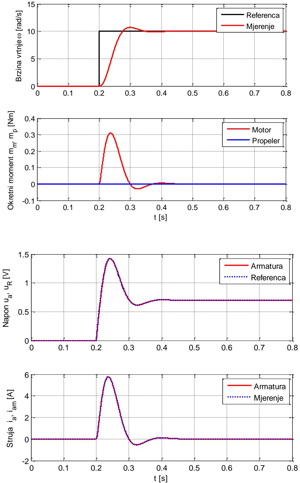
Slika 7.4 Simulacijski rezultati za regulacijski kruga brzine vrtnje s estimatorom brzine bez regulacije struje armature na skokovitu pobudu brzine od 10 rad/s
