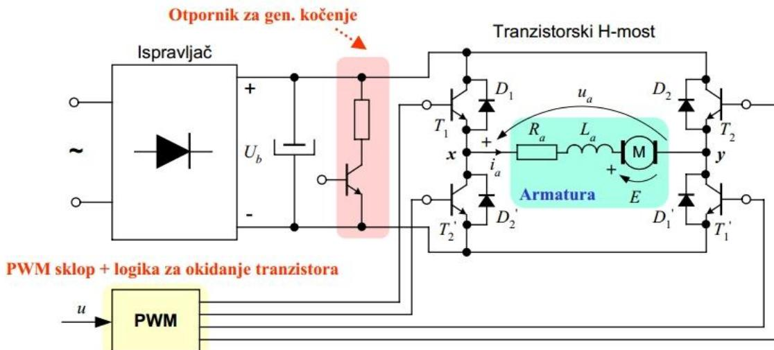
Slika 3.4 Principna shema tranzistorskog frekvencijskog pretvarača [4]
