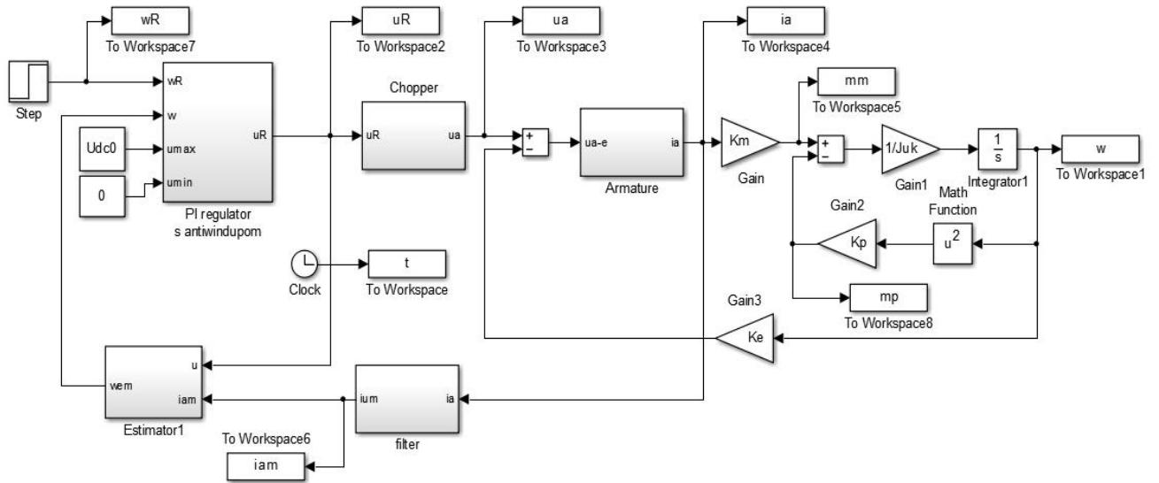
Slika 7.3 Simulacijski model sustava regulacije brzine vrtnje sa kompaktnim PI regulatorom brzine vrtnje bez podrđene regulacijske petlje struje
