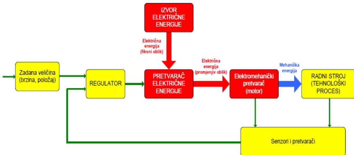
Slika 3.1 Upravljeni elektromotorni pogon
