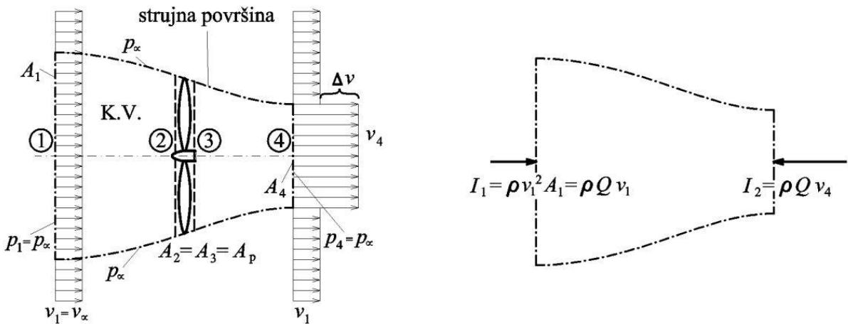
Slika 2.3 Shematski prikaz propelera i njegovog kontrolnog volumena
