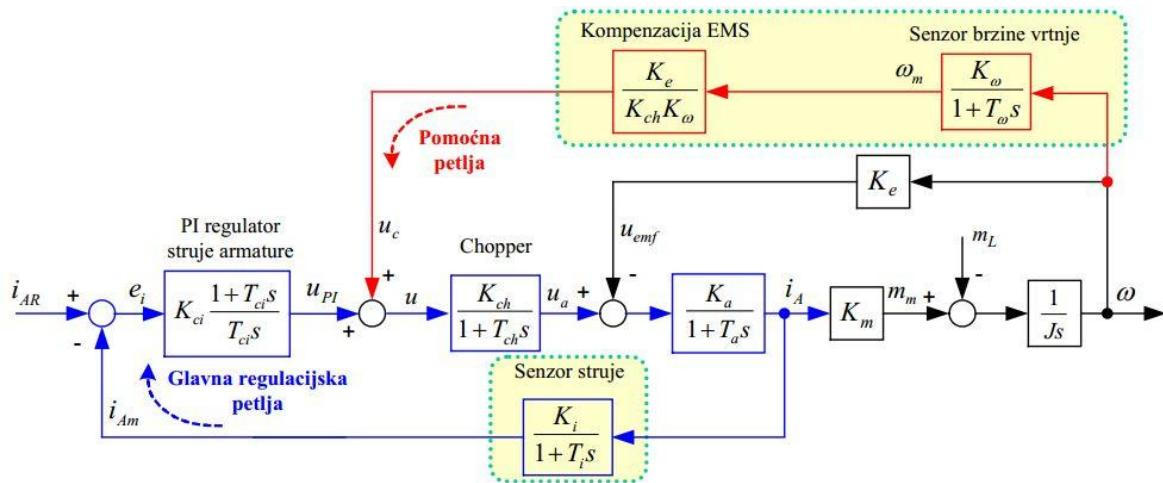
Slika 5.1 blokovski dijagram sustava regulacije struje armature
