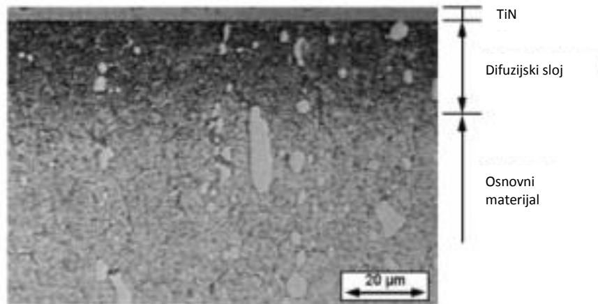
Slika 15. Prikaz površine uzorka čelika AISI D2 za 40%N<sub>2</sub> [8]
