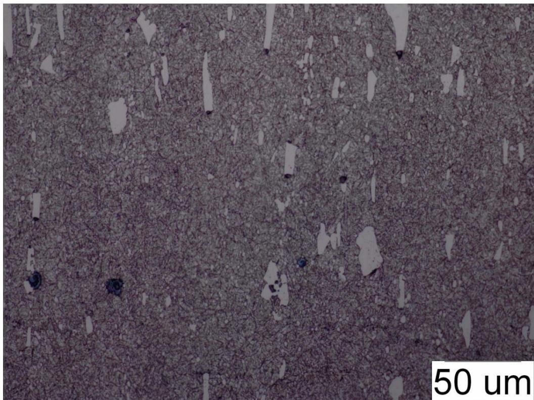
Slika 56. Sredina uzorka D2, prevlaka TiCN, povećanje 500x
