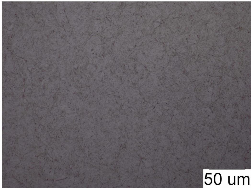
Slika 46. Sredina uzorka B2, prevlaka TiCN, povećanje 500x
