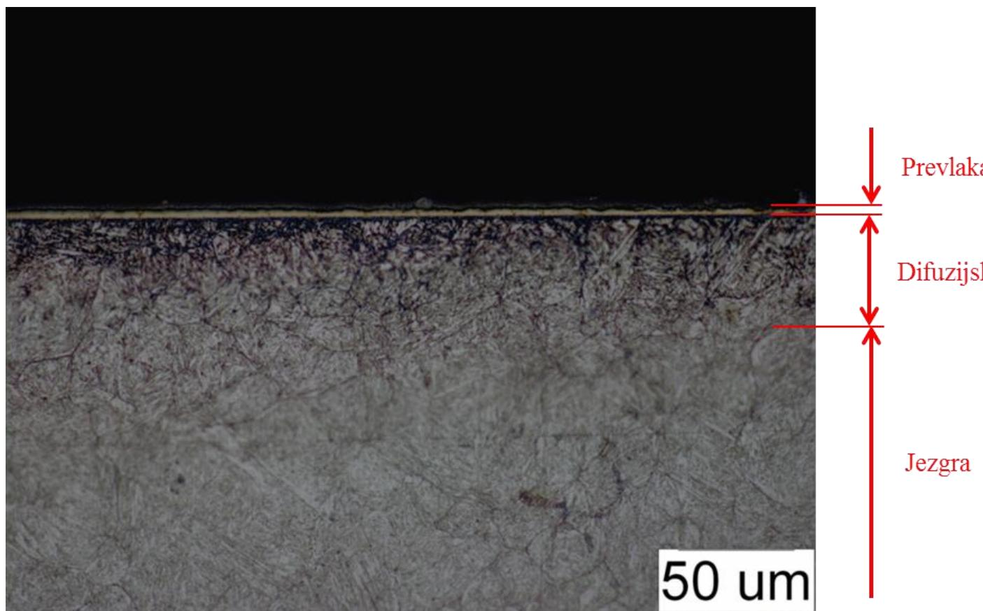
Slika 43. Površina uzorka A3, prevlaka TiBN, povećanje 500x
