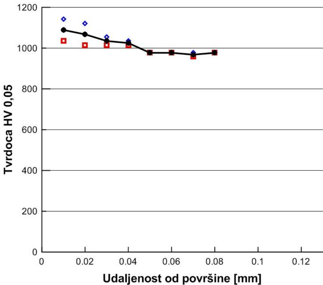
Slika 70. Raspored mikrotvrdoće po poprečnom presjeku uzorka C3 (TiBN prevlaka)
