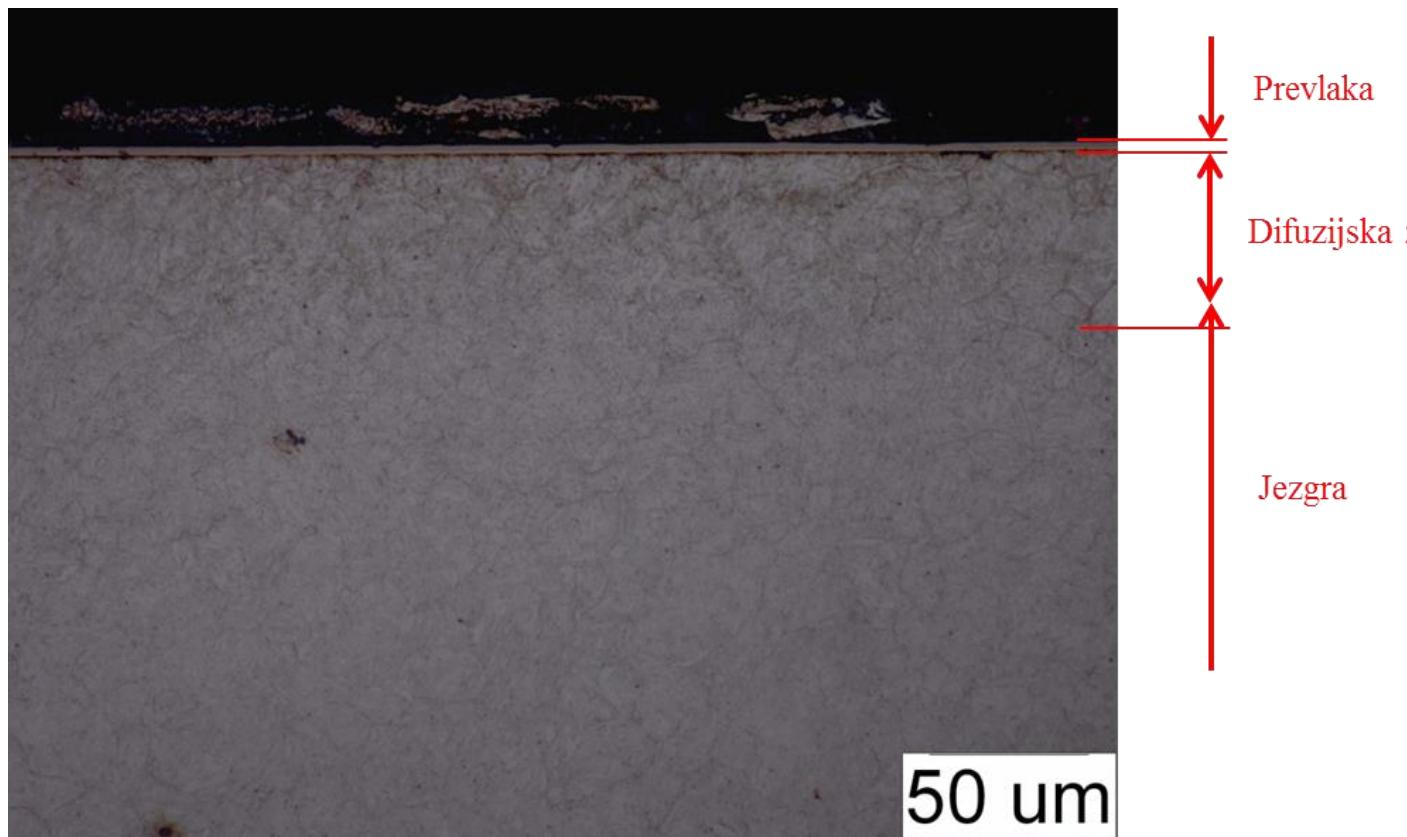
Slika 41. Površina uzorka A2, prevlaka TiCN, povećanje 500x
