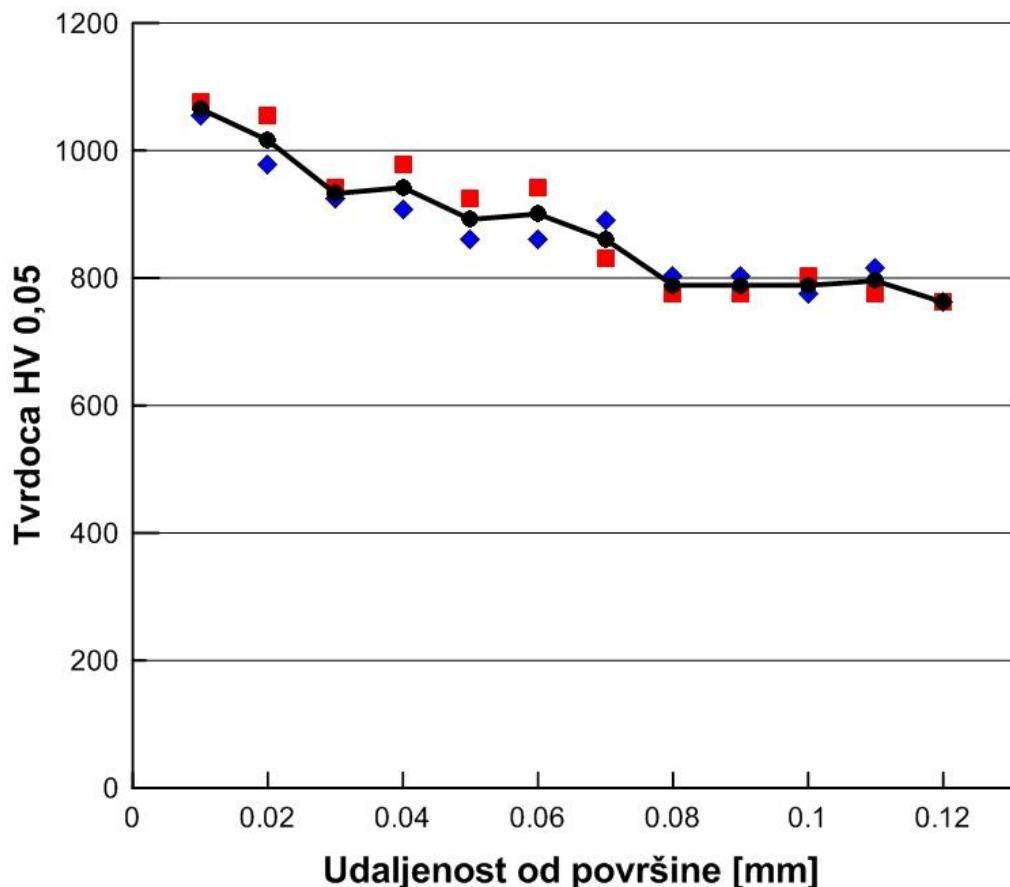
Slika 72. Raspored mikrotvrdoće po poprečnom presjeku uzorka D2 (nitrirano + TiCN prevlaka)
