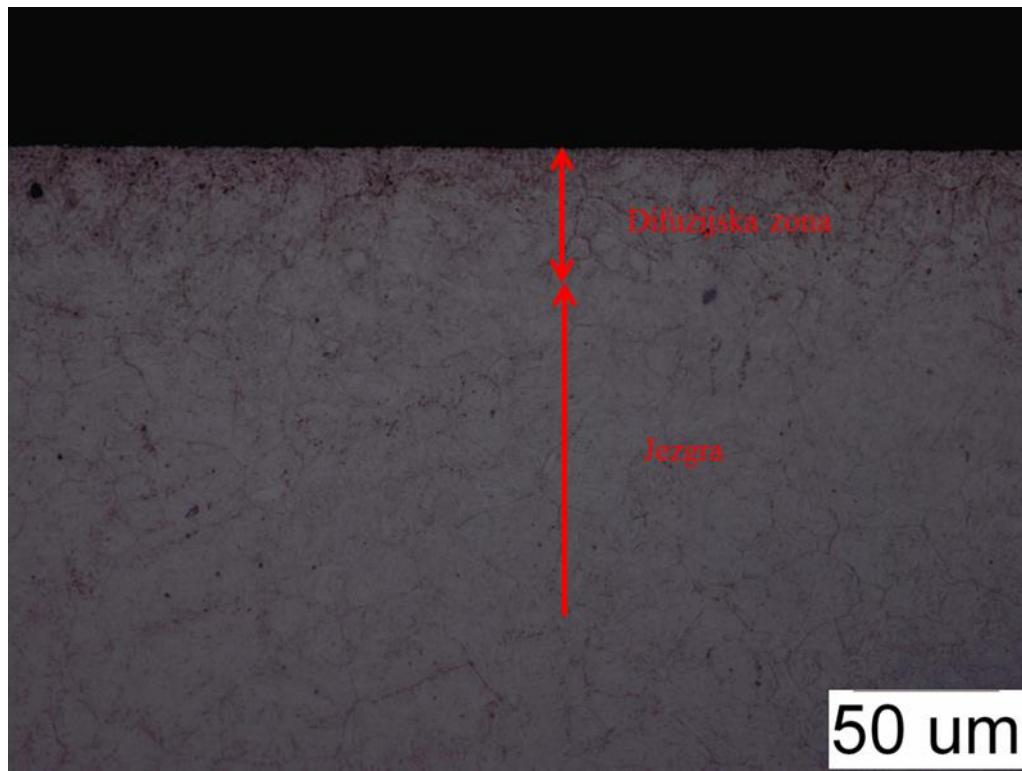
Slika 39. Površina uzorka A1, nitrirano, povećanje 500x
