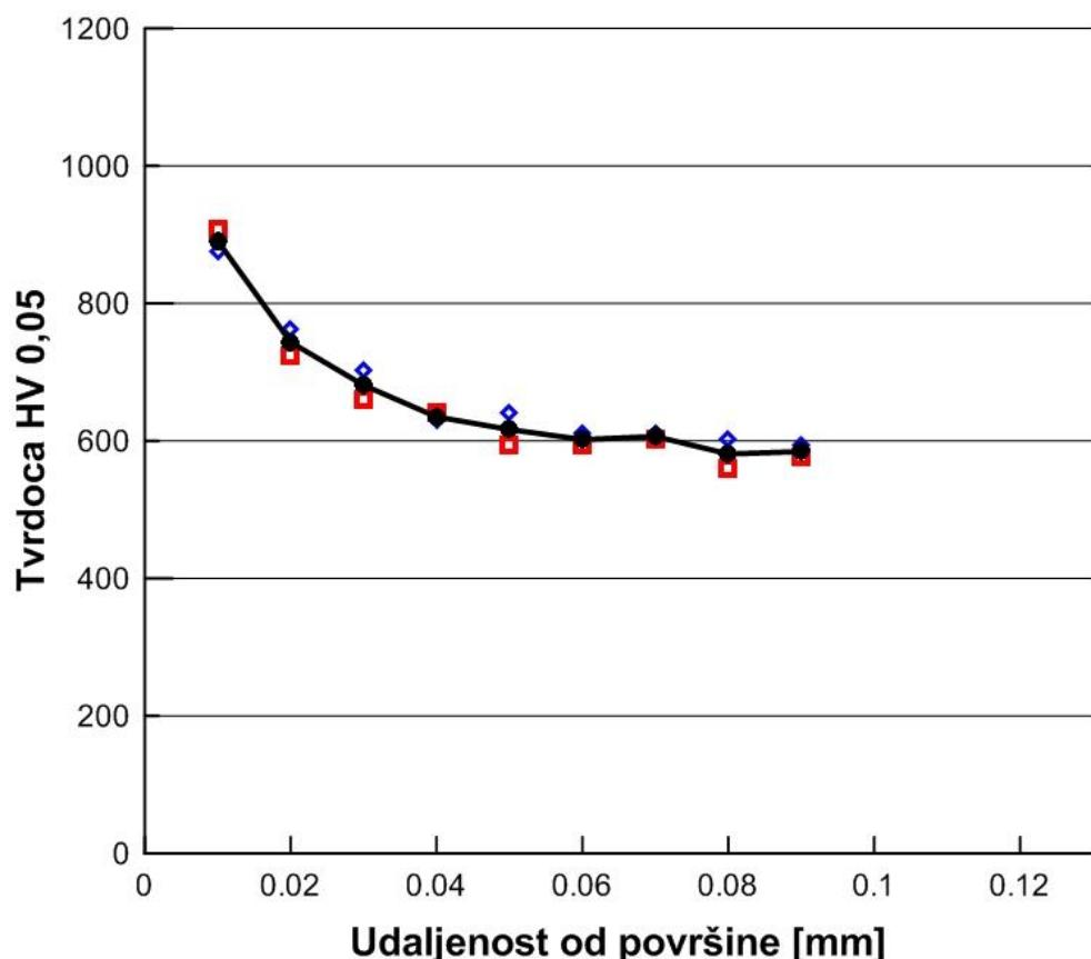
Slika 67. Raspored mikrotvrdoće po poprečnom presjeku uzorka B2 (nitrirano + TiCN prevlaka)
