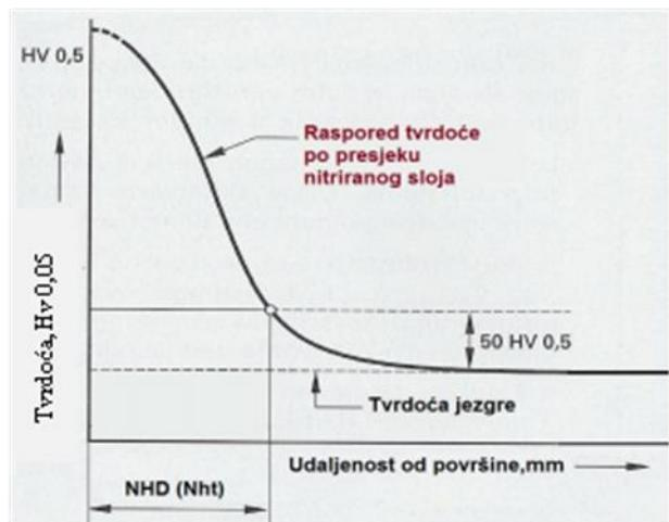
Slika 9. Ispitivanje dubine nitriranja [3]
