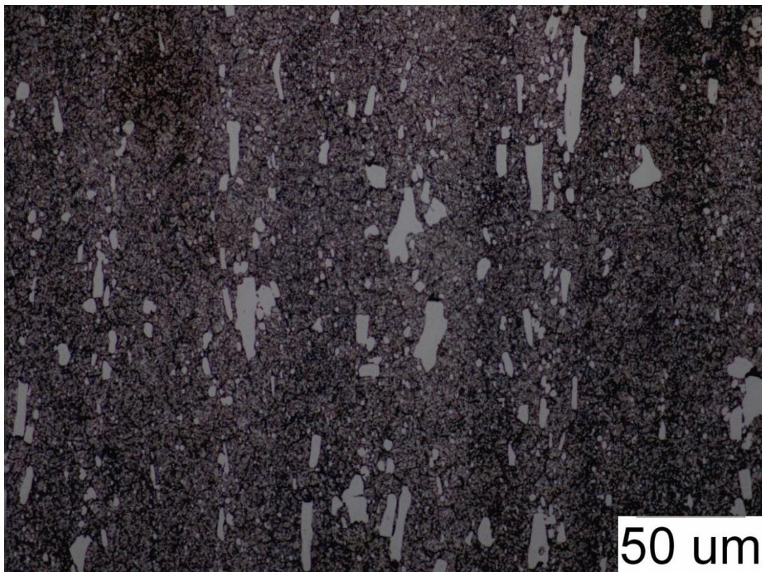
Slika 58. Sredina uzorka D3, prevlaka TiBN, povećanje 500x
