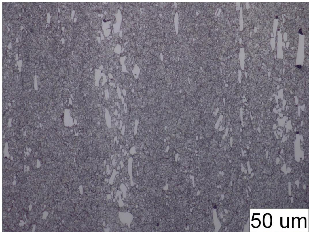
Slika 54. Površina uzorka D1, nitrirano, povećanje 500x
