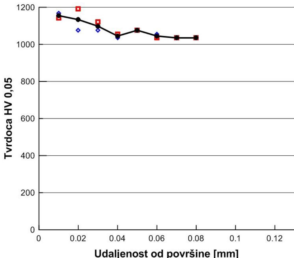
Slika 69. Raspored mikrotvrdoće po poprečnom presjeku uzorka C2 (TiCN prevlaka)
