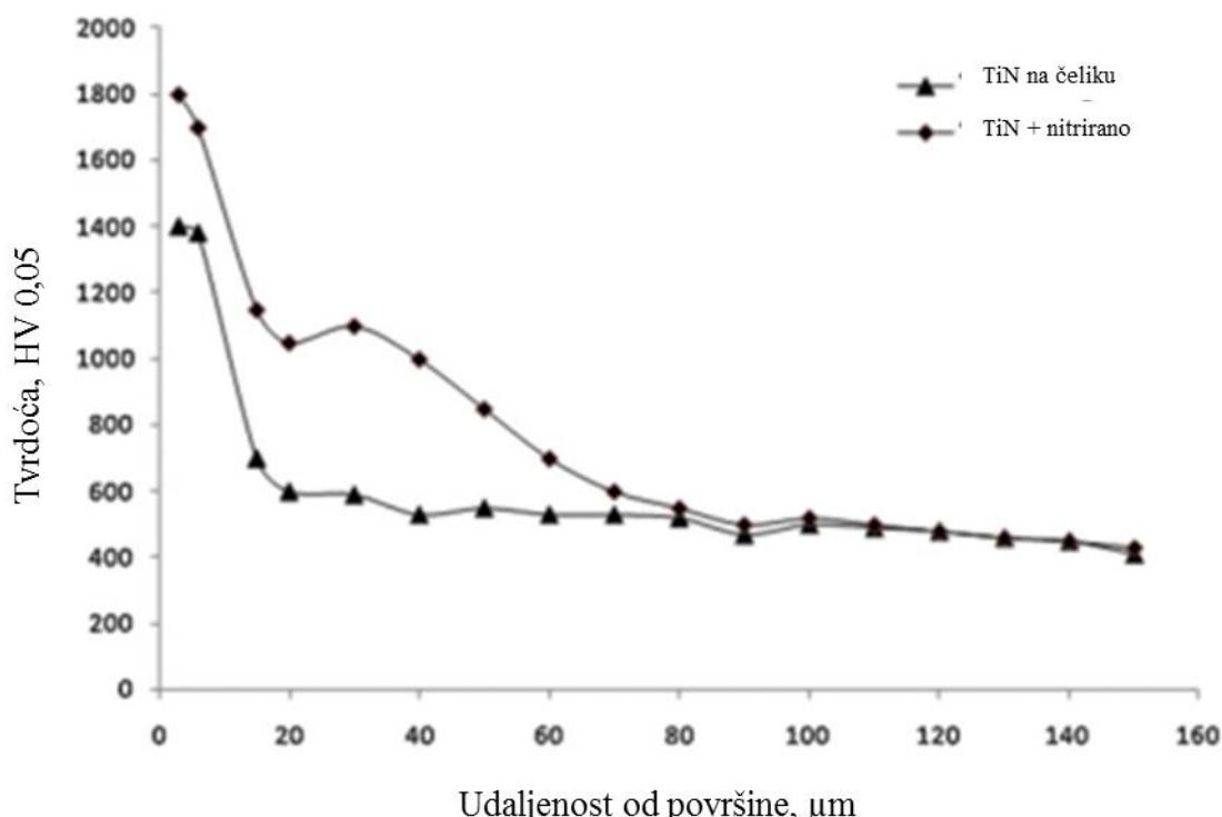
Slika 21. Raspored tvrdoće po poprečnom presjeku uzorka [10]
