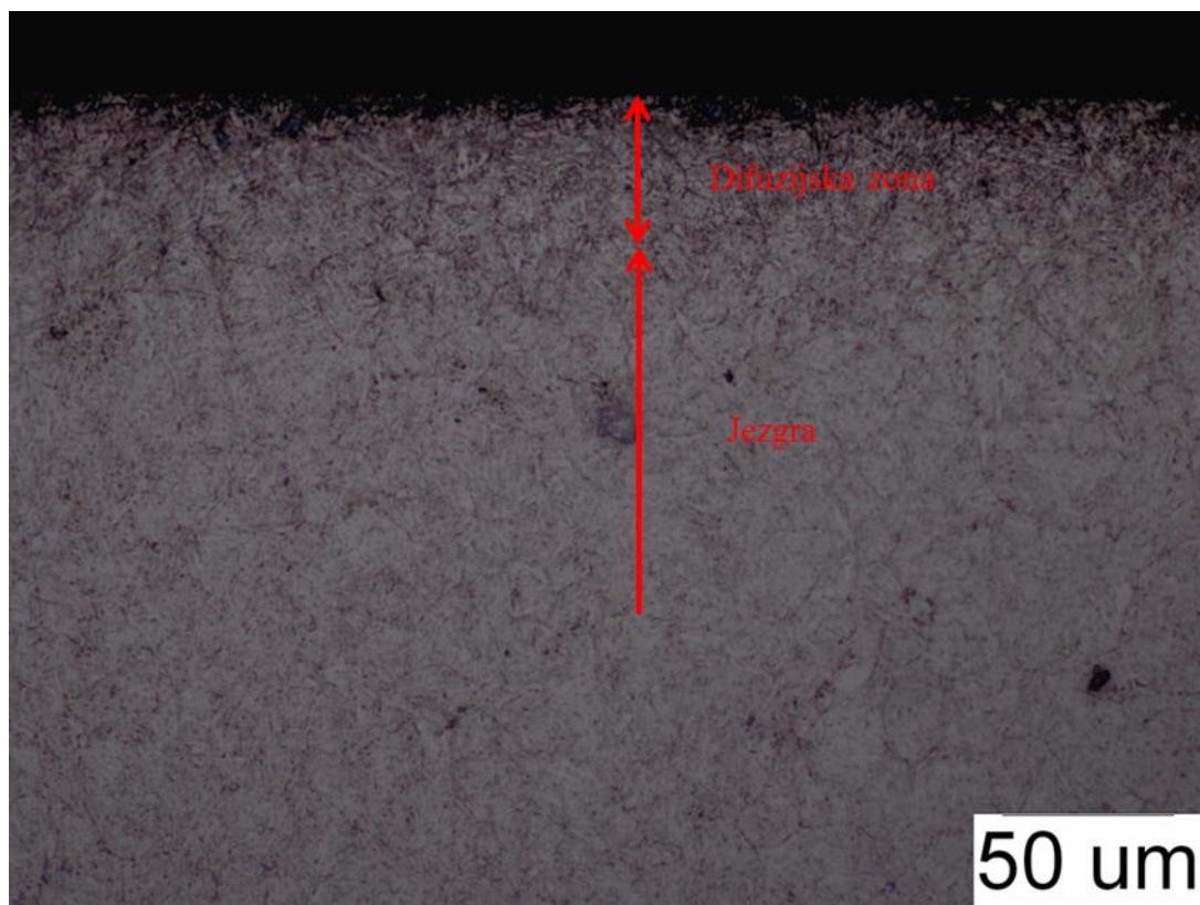
Slika 45. Površina uzorka B1, nitrirano, povećanje 500x
