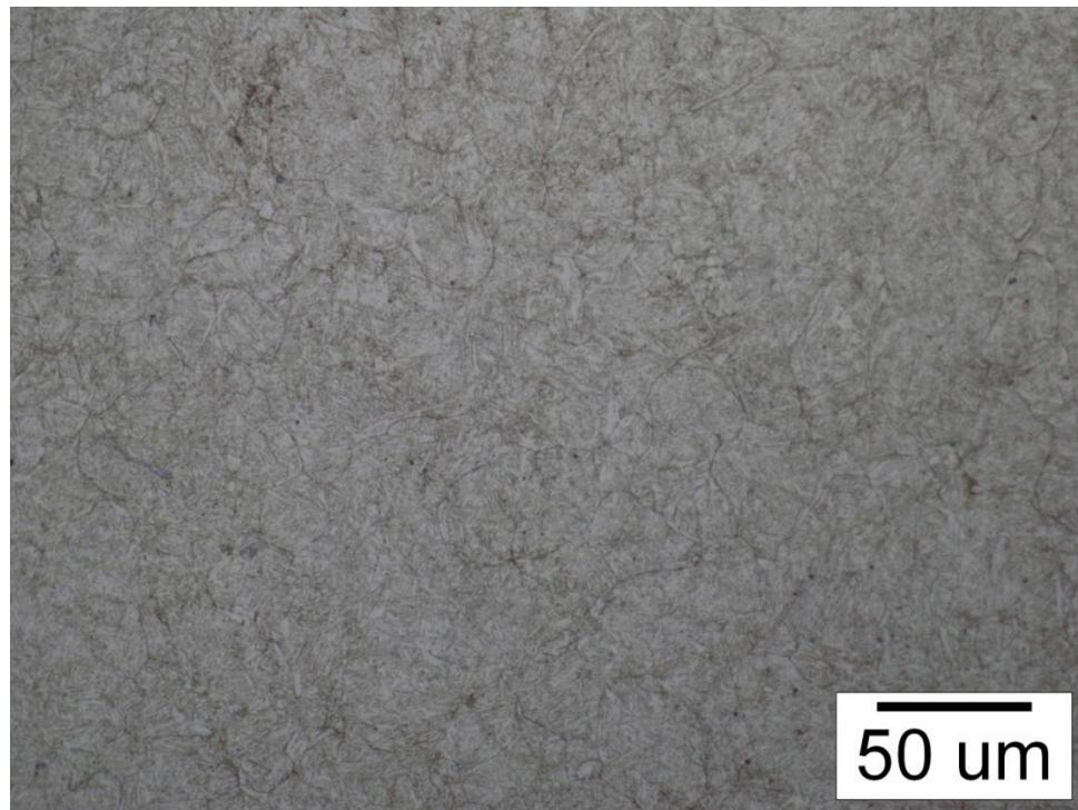
Slika 42. Sredina uzorka A3, prevlaka TiBN, povećanje 500x
