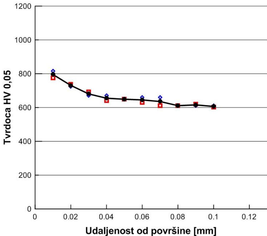
Slika 66. Raspored mikrotvrdoće po poprečnom presjeku uzorka B1 (nitrirano)
