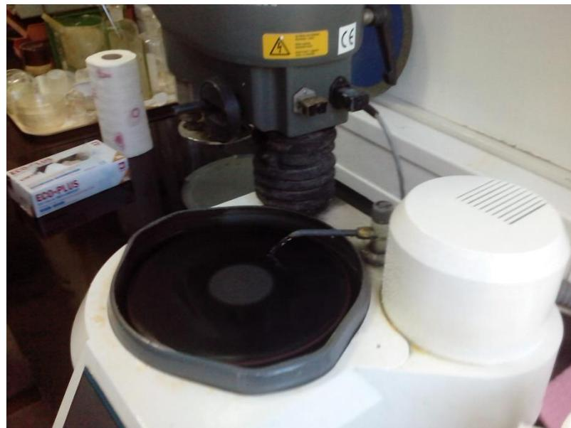
Slika 35. Vodeno hlađenje rezne ploče
