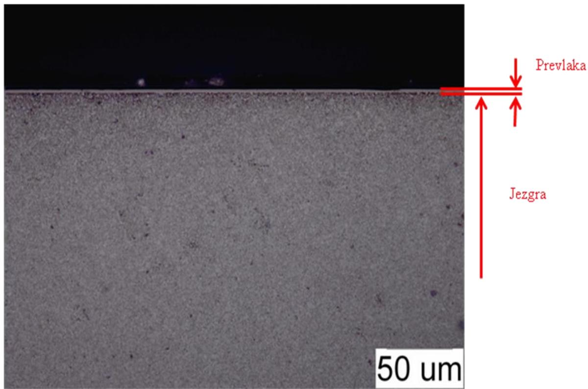
Slika 51. Površina uzorka C2, prevlaka TiCN, povećanje 500x
