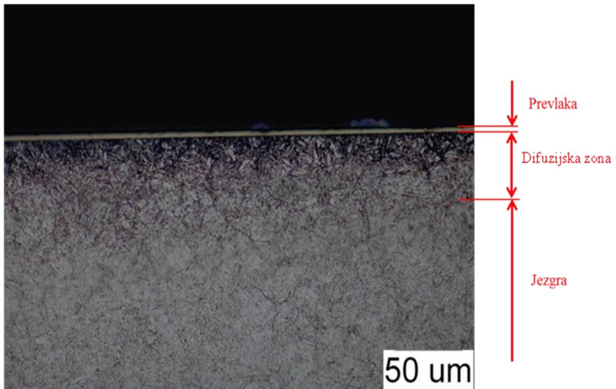
Slika 49. Površina uzorka B3, prevlaka TiBN, povećanje 500x
