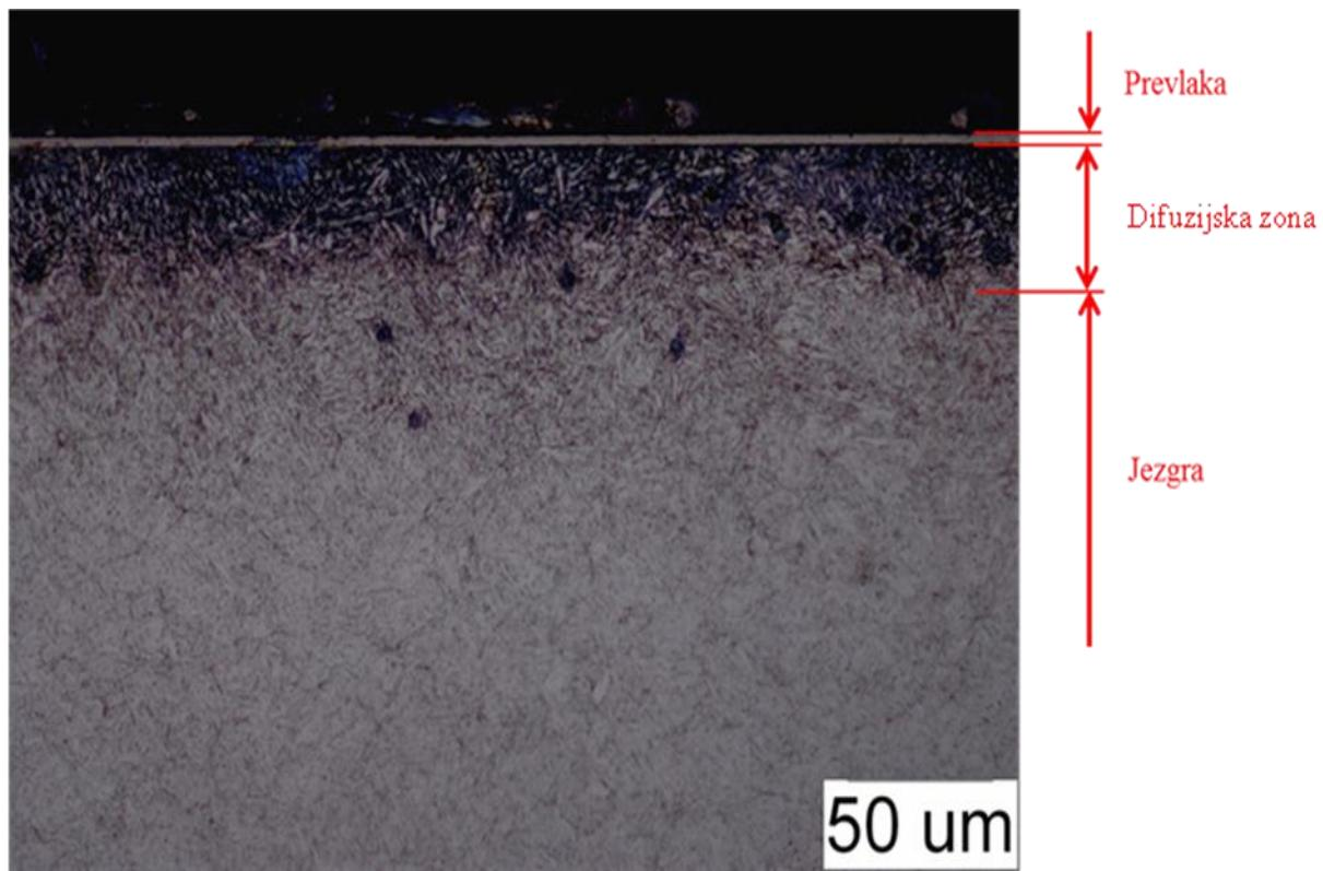
Slika 47. Površina uzorka B2, prevlaka TiCN, povećanje 500x
