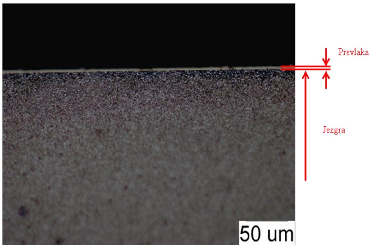
Slika 53. Površina uzorka C3, prevlaka TiBN, povećanje 500x
