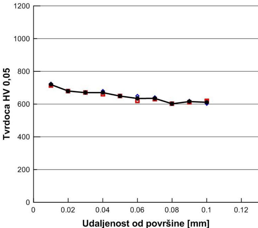
Slika 68. Raspored mikrotvrdoće po poprečnom presjeku uzorka B3 (nitrirano + TiBN prevlaka)
