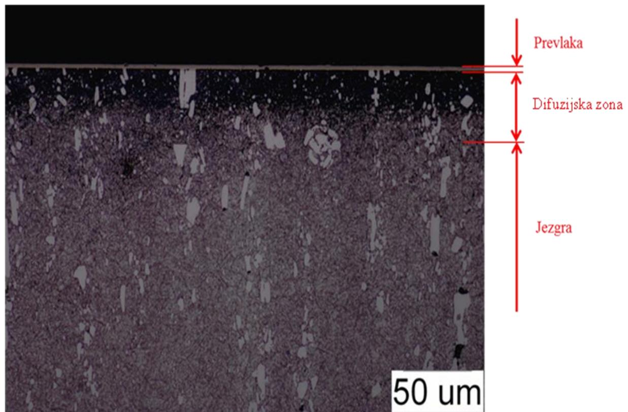
Slika 57. Površina uzorka D2, prevlaka TiCN, povećanje 500x
