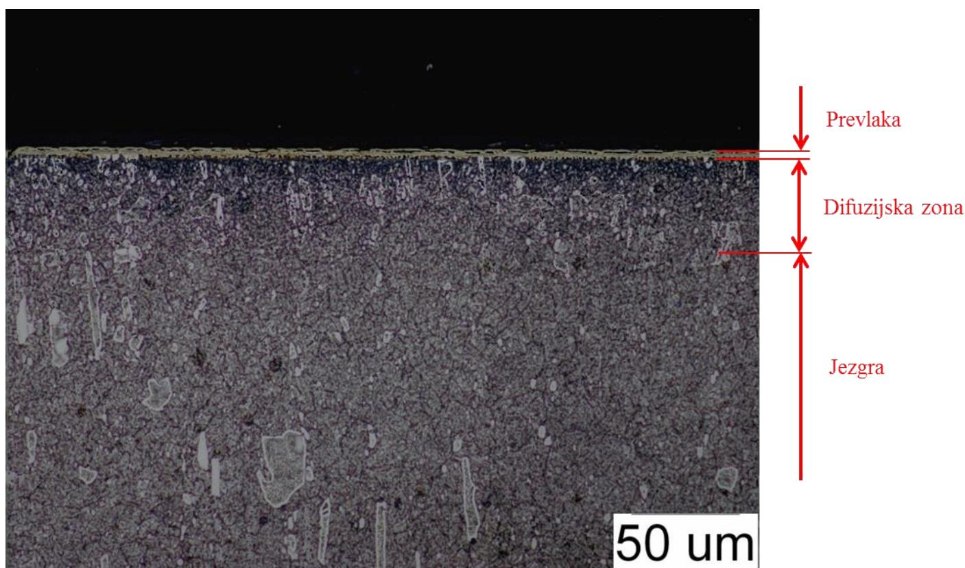
Slika 59. Površina uzorka D3, prevlaka TiBN, povećanje 500x
