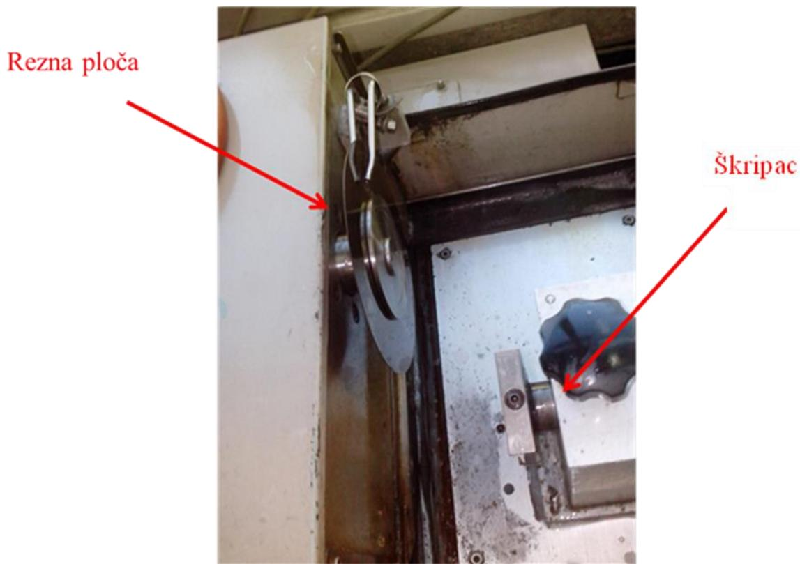
Slika 30. Oštrica i rezno mjesto mikrorezalice
