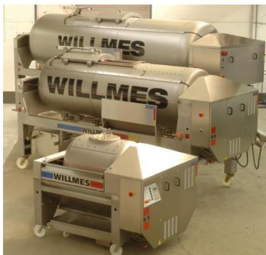
Slika 6 Willmes preše velikog kapaciteta
