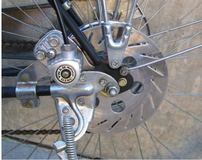
Slika 6. Primjerak iz prve serije disk kočnica [2]
