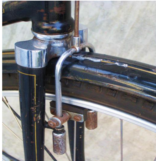
Slika 3. Kočnica na naplatku kotača [2]
