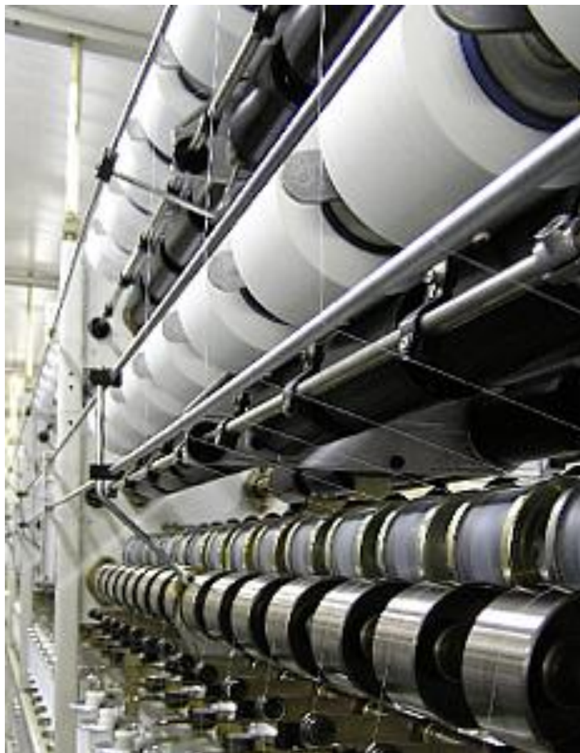
Slika 3. Prikaz stroja za pređenje pamuka
