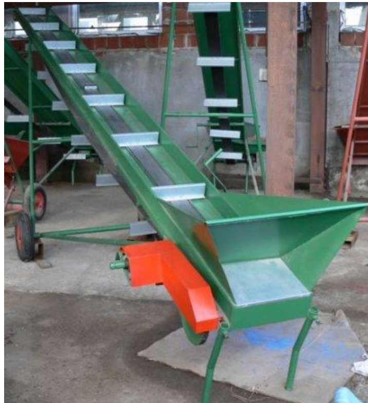
Slika 5. Transporter tvrtke Agroservis sa lopaticama
